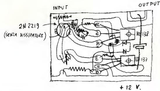
Dal lato rame si montano tutti i componenti tranne i due finali e i due diodi; questi vanno montati sulla faccia inferiore, tra il circuito stampato e una lastrina d'alluminio delle stesse dimensioni che funge da dissipatore, come nella figura seguente si può vedere:
