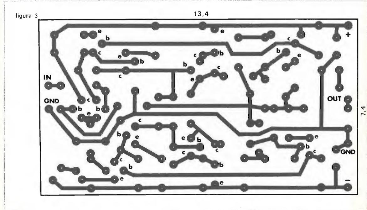
Ottimo sarebbe usare il metodo della fotoincisione, che permette di ottenere delle piastre dall'aspetto veramente professionale. Chi vorrà realizzare un finale avente una potenza inferiore ai 100 W<sub>RMS</sub>, potrà ancora usare lo stesso circuito stampato, sostituendo naturalmente il valore dei componenti, come riportato nell'articolo di Tagliavini.
