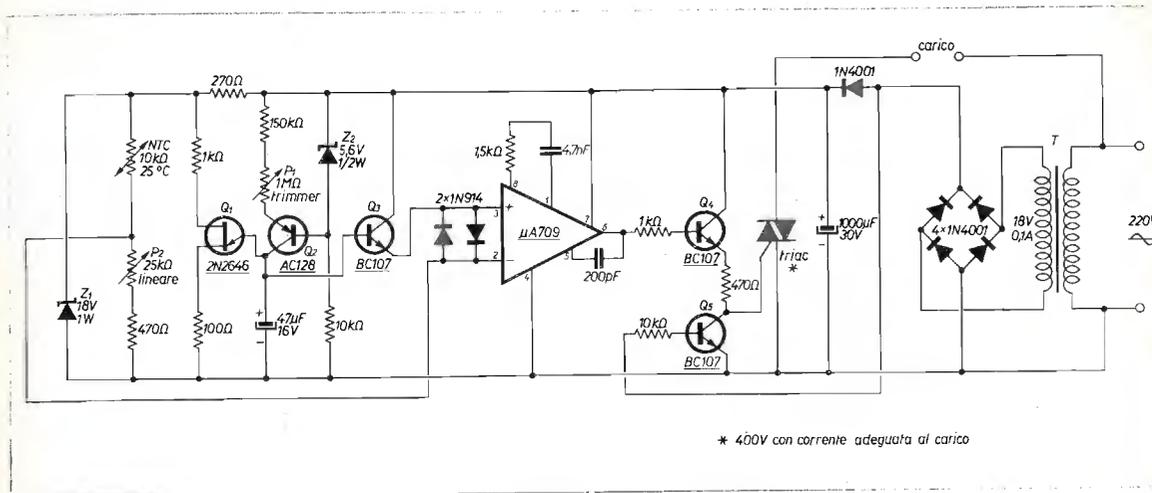
La realizzazione non comporta alcun problema; conviene comunque montare per primo il generatore del dente di sega compreso Q<sub>3</sub> per poter tarare il suo periodo di ripetizione.
