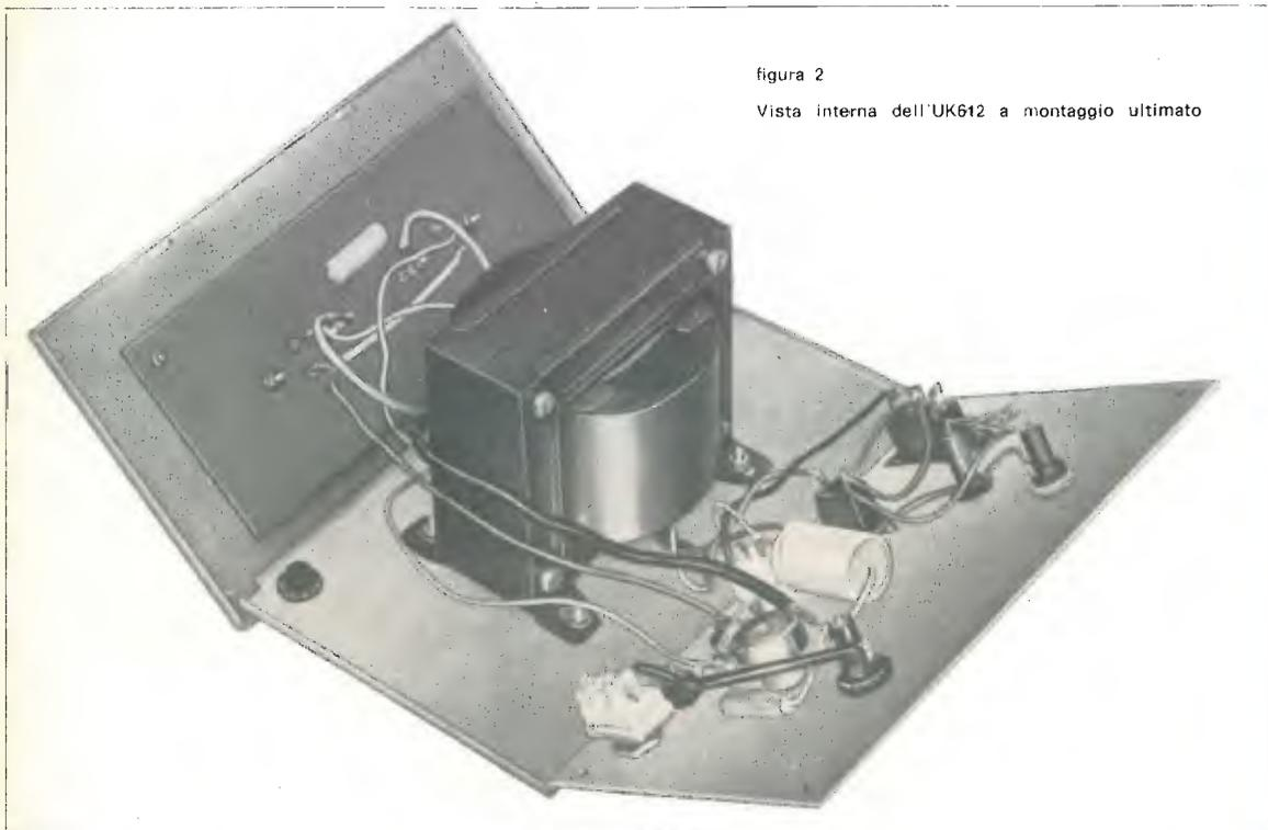
Si chiama invertitore un'apparecchiatura che realizza la conversione della energia elettrica dalla forma di corrente continua a quella di corrente alternata.
