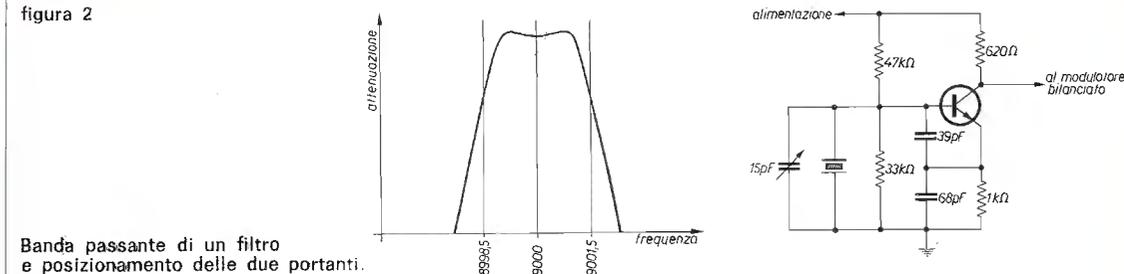
Banda passante di un filtro e posizionamento delle due portanti.
