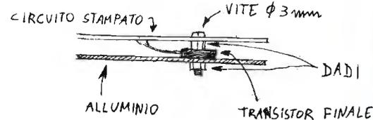
Bisogna però curare di inserire tra i finali e l'alluminio una apposita mica isolante, senza lesinare il grasso al silicio specialmente sui diodi in modo che questi siano in buon contatto termico coi due transistori.
