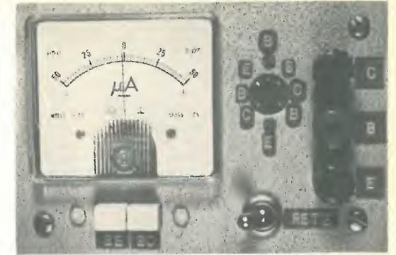
L'efficienza del transistor in prova viene quindi controllata alimentando in corrente alternata le due giunzioni emittore/base e collettore/base rispettivamente e verificando il potere raddrizzante delle suddette giunzioni.
