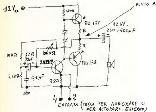
R deve essere scelta tra 1 Ω e 10 Ω (a causa della dispersione dei parametri dei diodi di polarizzazione, che sono al silicio, per commutazione, tratti anche da vecchie schede surplus: per esempio 1N914) al fine di assicura-
