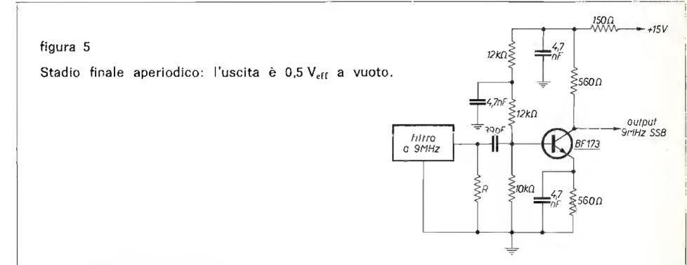
Valgono le stesse tensioni indicate dalla tabella; l'uscita RF è mezzo volt a vuoto. Sotto carico questa tensione non diminuisce molto se il mixer è ad alta impedenza d'ingresso, come potrebbe essere una valvola. Per la messa a punto vale quanto è stato detto per lo stadio finale con circuito sintonizzato. Naturalmente, data la più bassa amplificazione, c'è meno pericolo che autooscilli.
