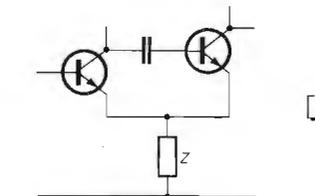
Un accoppiamento di questo genere può snaturare completamente il funzionamento del circuito, rispetto alle intenzioni dello schema di partenza: basta pensare infatti che la configurazione risultante, ossia quella di figura 1 c, è più simile a quella di un trigger di Schmitt che all'originaria di un amplificatore a due stadi. E questo, tanto più quanto maggiormente è sensibile la Z del collegamento rispetto alle grandezze in gioco.
