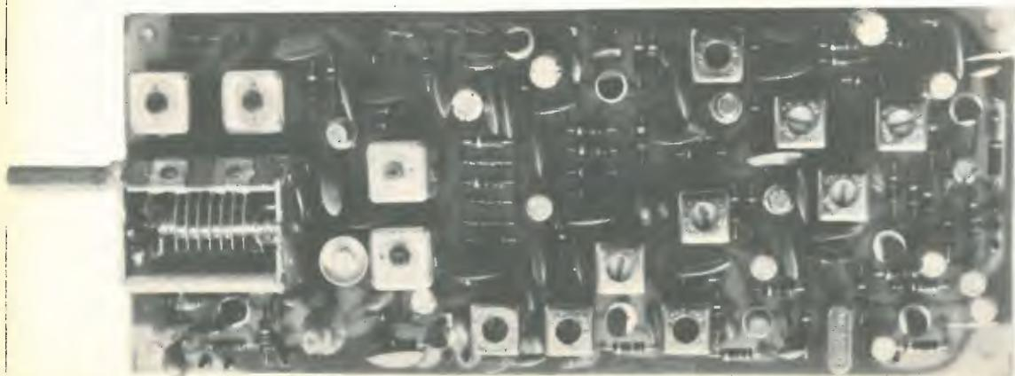
Comunque, per evitare inneschi dovuti a ritorni di radiofrequenza, è bene togliere tensione alla unità di BF, quindi il commutatore tra B e M risulterà chiuso in posizione trasmissione, e aperto in posizione ricezione.
