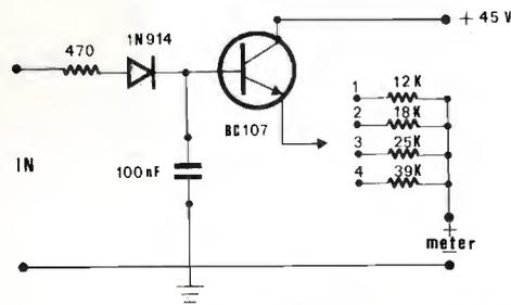
Il milliamperometro dovrà avere una portata di 1 mA f.s. e andrà tarato in watt o in decibel. Con le quattro posizioni del commutatore si potranno misurare rispettivamente 20 W, 40 W, 80 W, 200 W di picco su un carico di 8 Ω. Il transistor usato è un BC107 o simile, capace di sopportare una V<sub>CE</sub> di 45 V.
