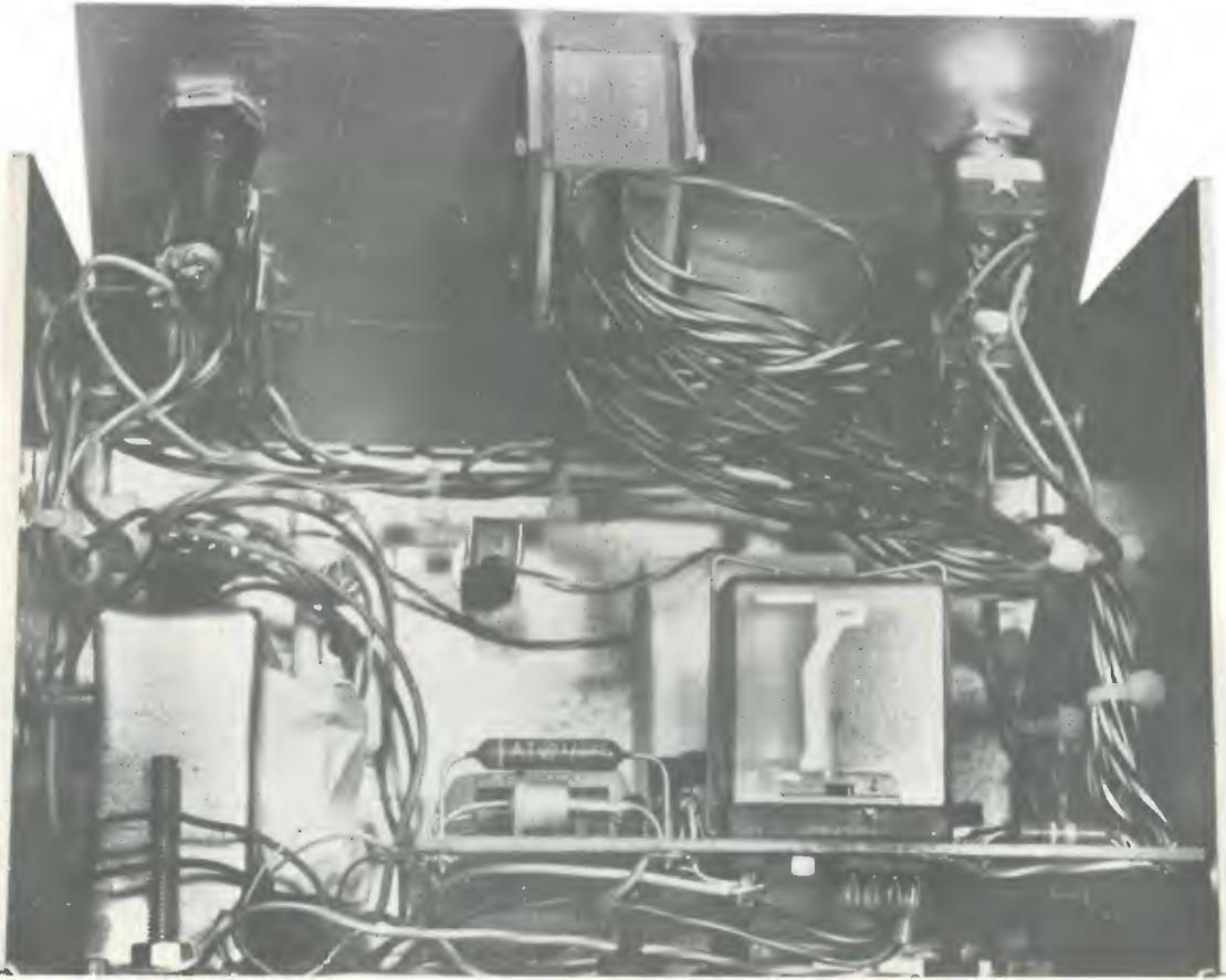
Il circuito è completato da un'unità di alimentazione stabilizzata a  $+12\text{ V}$  mediante un diodo zener  $D_5$  e a  $8,2\text{ V}$  mediante il diodo zener  $D_1$ , inserito in cascata a  $D_5$  rispettivamente per l'alimentazione di  $Q_1$  e per la tensione di carica di  $C_5$ , mediante il partitore  $R_2/R_3$ .
