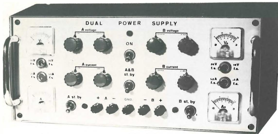
Il circuito è completamente a componenti discreti poiché in un alimentatore, dato l'ingombro del trasformatore, degli elettrolitici, e dei dissipatori non esistono certo problemi di miniaturizzazione. L'impiego degli integrati dal punto di vista delle prestazioni non è giustificato, almeno stando alle caratteristiche di quelli disponibili al tempo della progettazione.
