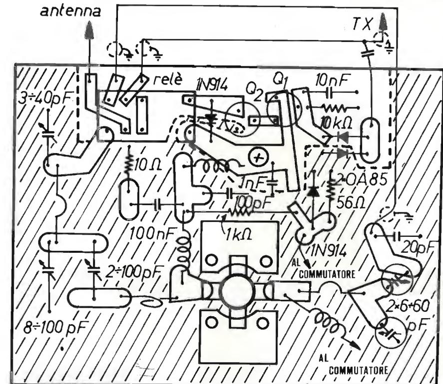
I transistori del COR sono per  $Q_1$ , qualsiasi NPN da circa 1,5W tipo 2N1711, etc., per  $Q_2$  qualsiasi TO18 tipo BC108, etc.; i diodi 1N914 possono essere sostituiti da qualsiasi diodo al silicio di commutazione; per i due diodi del COR vanno bene tipi al germanio di rivelazione.
