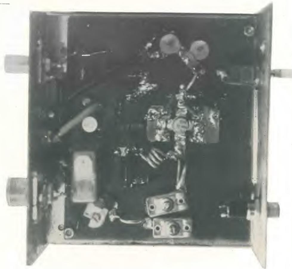
Il radiatore va possibilmente spalmato di grasso al silicone come pure la base del transistor che è isolata dal collettore o emettitore e viene in « ammericano » chiamata « stud ».
