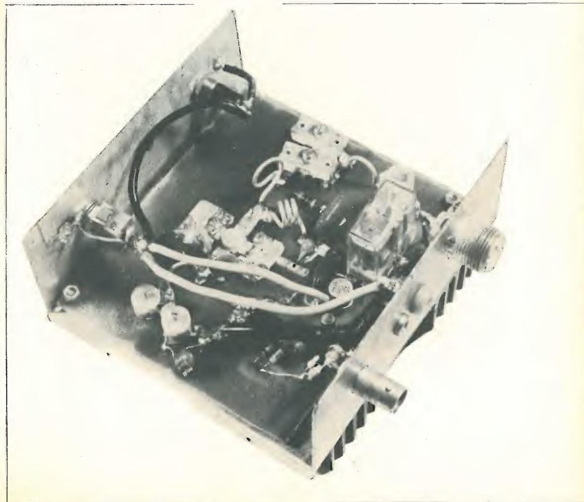
Il tutto comunque non deve dare grane di sorta, si può notare in presenza di notevoli disadattamenti del circuito di ingresso che il COR non scatta o il relè tende a diseccitarsi; una adeguata taratura eliminerà completamente il difetto.
