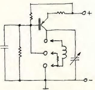
Per gli amanti degli esperimenti è un buon campo di esercitazione! Per ottenere l'indicazione della radiofrequenza su un microamperometro, presento nuovamente il circuito che ho usato su tutti i miei g.d.m.
