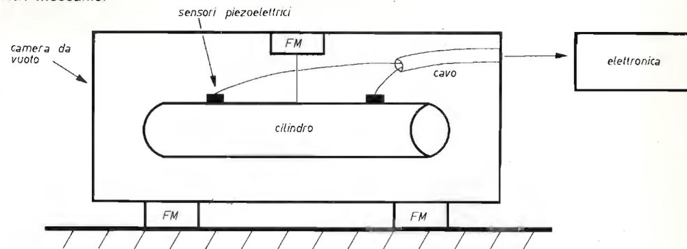
Per misurare le vibrazioni del cilindro si utilizzano delle ceramiche piezoelettriche che generano segnali elettrici proporzionali appunto alle vibrazioni.
