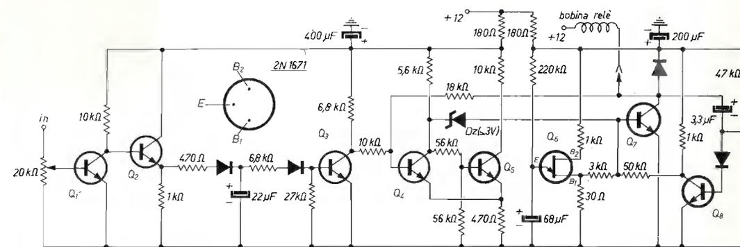
Il circuito (figura 1) è relativamente semplice e i componenti trovano posto su una basetta di 9,4 x 4,2 cm sulla quale, un po' alla buona, è stato realizzato il circuito stampato riprodotto, in scala 1:1, nella figura 2.
