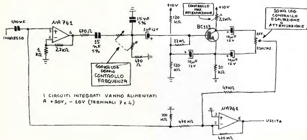
Come tutto questo si possa ottenere è presto detto: due integrati (sostituibili da uno doppio), un transistor e poco altro. Il cuore del controllo è un filtro a L, passa banda, a frequenza variabile; è progettato in modo da coprire la gamma 20 Hz ÷ 20 kHz anche se in pratica essendo inaudibili (e non presenti in nessun disco!) le frequenze superiori a 15 ÷ 16 kHz, sembra che per un pezzo della sua corsa il controllo non abbia effetto.
