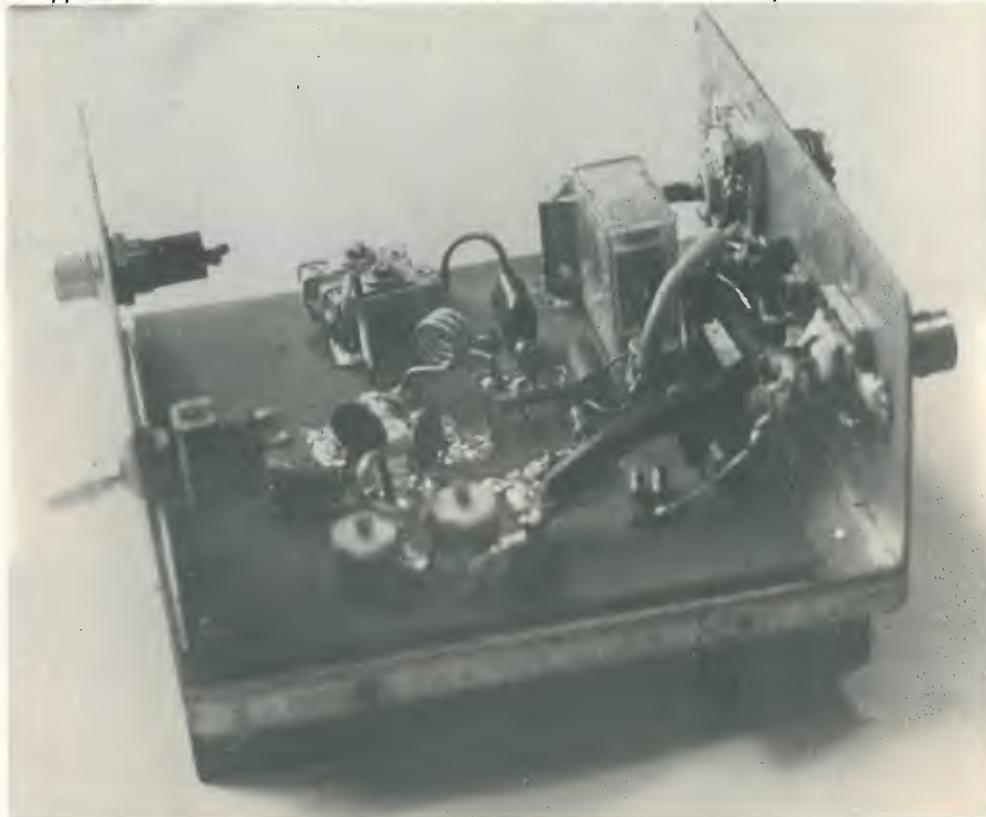
Ultima raccomandazione: il COR può, qualora la portante sia piuttosto bassa (come nel caso dei pochi watt nell'uso in AM) o addirittura praticamente nulla (nel caso della SSB essendo praticamente solamente il residuo di portante in assenza di modulazione) rivelarsi inefficiente. In questo caso è necessario aumentare il valore del condensatore da f pF collegato all'antenna che determina la percentuale di RF che serve a eccitare il COR.
