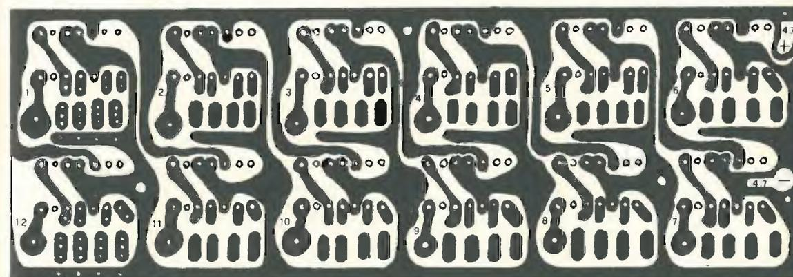
La figura 9 da' un esempio di come sono sistemati gli integrati. Sul circuito stampato, solo per i divisori n. 1 e n. 12, sono stati indicati tutti i segnali di foratura; va da sé che anche le altre sezioni del circuito stampato vanno forate alla stessa maniera.
