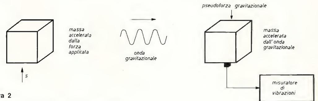
Nelle figure 1 e 2 sono illustrati graficamente questi concetti: le due antenne trasmettenti sono comandate da una tensione elettrica nel primo caso e da una forza meccanica nel secondo; in tutti e due i casi si tratta di grandezze alternate sinusoidali. In altre parole, la forza applicata all'antenna gravitazionale tra-
