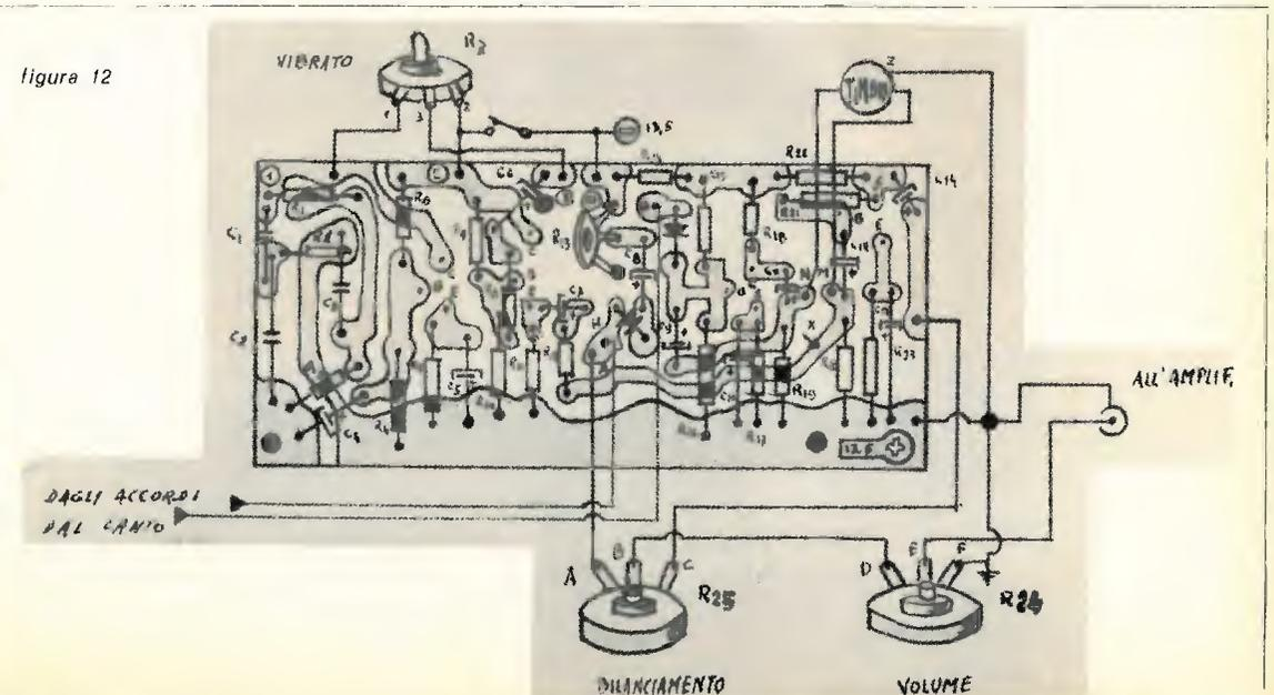
In figura 13 è mostrato il circuito stampato e in figura 12 la sistemazione dei componenti.
