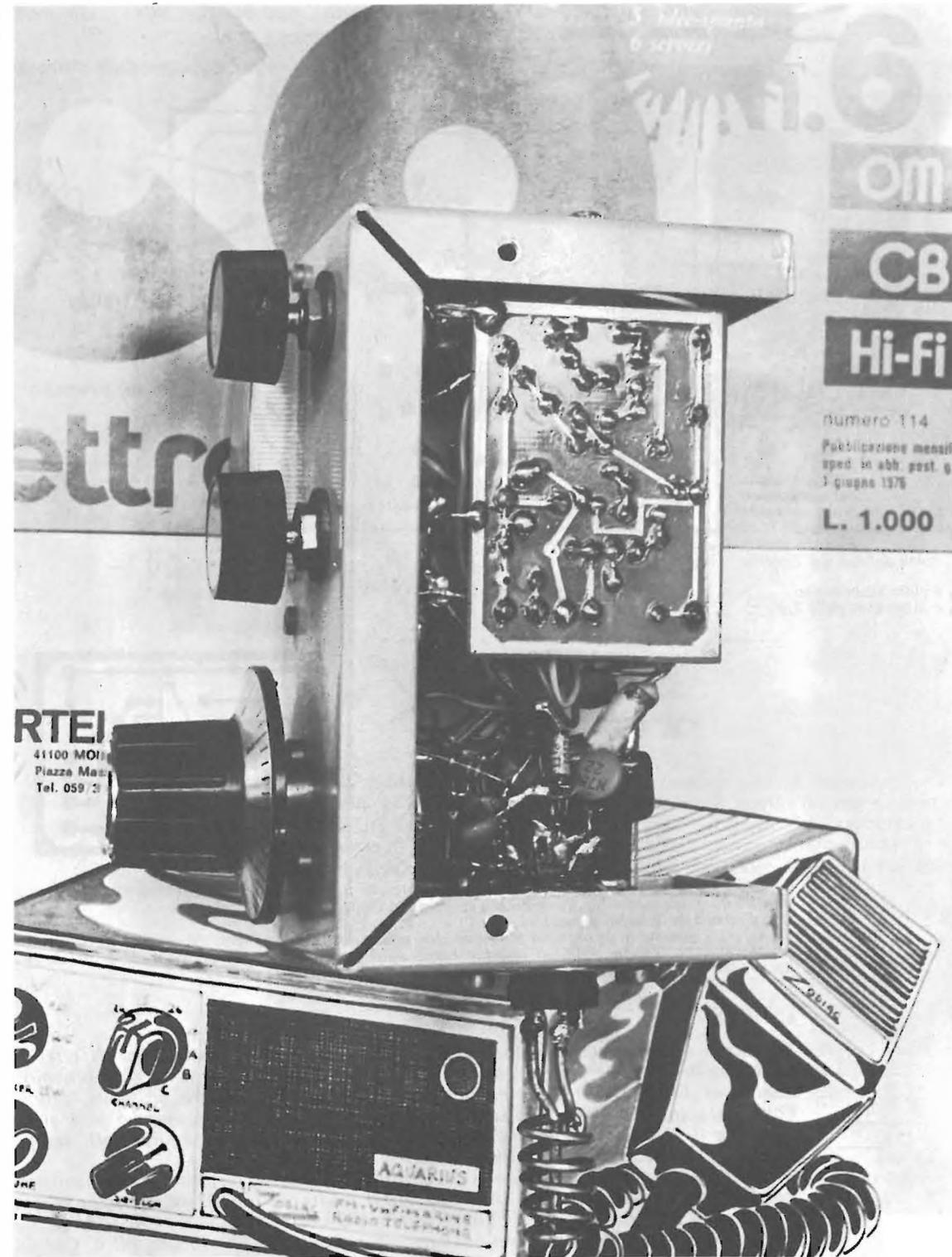
E' stato infine adottato un circuito stampato in seconda versione, più pratico perché adatto ai normali TO 72, metallici o plastici, tipo BC107 o BC113; cioè, molto semplicemente... rovesciando il disegno.
