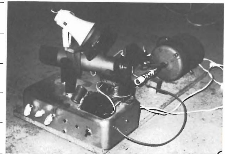
La SSTV ha però anche un sincronismo di quadro e sincronismi di riga. Il primo è ottenuto con un contatto sull'eccentrico (strip sincronismi in dettaglio nella figura 2) e il secondo con un contatto sul cilindro (strip sincronismi di riga in dettaglio nella figura 3).
