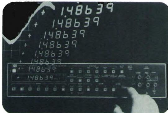
*Il nuovo voltmetro digitale a 5 e 1/2 o 6 cifre e 1/2, controlla la sua precisione interna e se necessario effettua delle auto-calibrazioni.*
