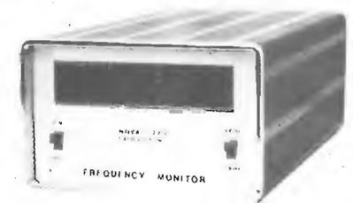
Questi lettori di frequenza digitali sono costruiti con i migliori ritrovati dell'elettronica, visualizzazione con 6 digit, MHz, kHz e 100 Hz, alimentazione 220 Vac., dimensioni 105 x 65 x 200 mm.
