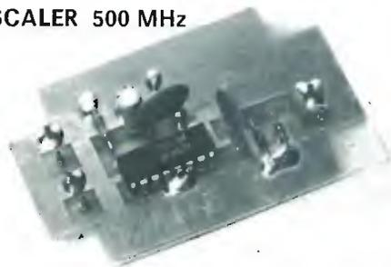
Equipaggiato con 11C90 e diodi UHF, permette la lettura di VHF e UHF - Alimentazione: 5 V - Divide per 10 - Dimensioni 4,5 x 7
