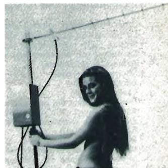
Preamplificatori d'antenna da palo 136 - 144 - 432 MHz con relè.
