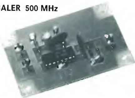
Equipaggiato con 11C90 e diodi UHF, permette la lettura di VHF e UHF - Alimentazione: 5 V - Divide per 10 - Dimensioni 4,5 x 7
