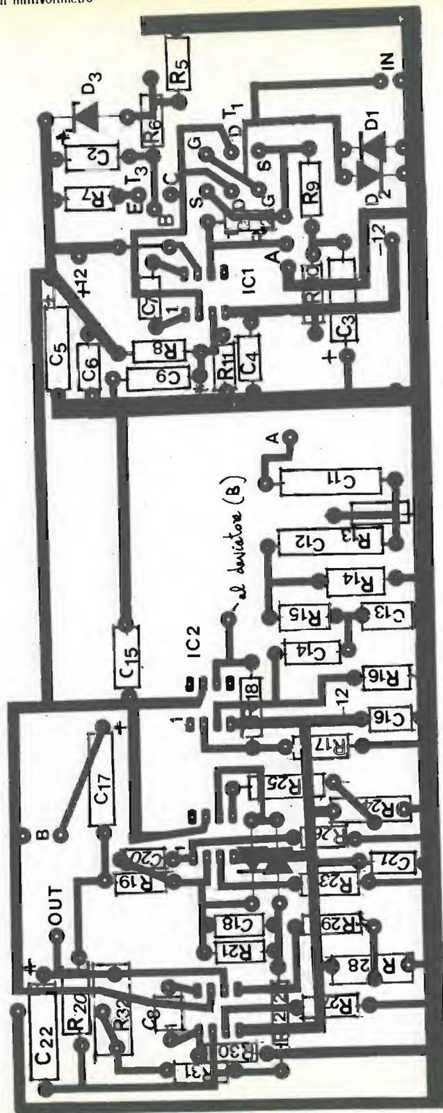
punti L e M (figura 5) e tale collegamento dovrà essere più corto possibile, altrimenti il circuito oscilla. Si regolerà quindi il trimmer  $R_{28}$  fino ad avere 0 V all'uscita.
