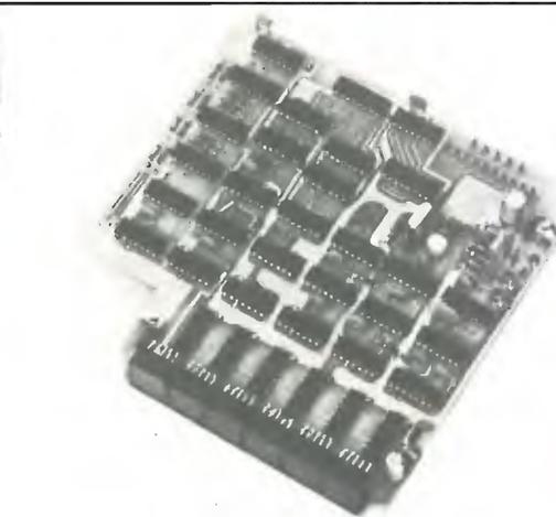
IDEALE per CB; abbinato al VFO o all'oscillatore di sintesi legge direttamente la frequenza di ricezione e di trasmissione, sia AM-FM che SSB.
