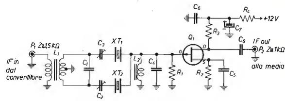
Il filtro usato è stato centrato alla frequenza di 455 kHz in modo da essere facilmente sostituito da un filtro più professionale, tipo « Collins » o altro equivalente previo adattamento circuitale, senza ritoccare le altre parti del ricevitore. La sua banda passante è di  $\cong$  3 kHz a 3 dB e  $\leq$  14 kHz a 40 dB come si può vedere dalla foto allegata.
