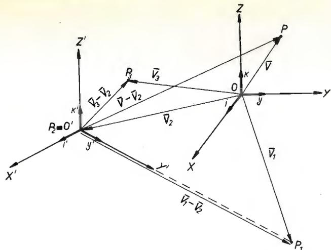
3) Il punto  $P_3$  si trova sul piano  $y', z'$ . E' necessario precisare tale punto perché, se non lo facessimo, il sistema di riferimento  $R'$  potrebbe ruotare attorno all'asse  $y'$ . Assegnando  $P_3$  tale rotazione viene bloccata e  $R'$  risulta completamente individuato.
