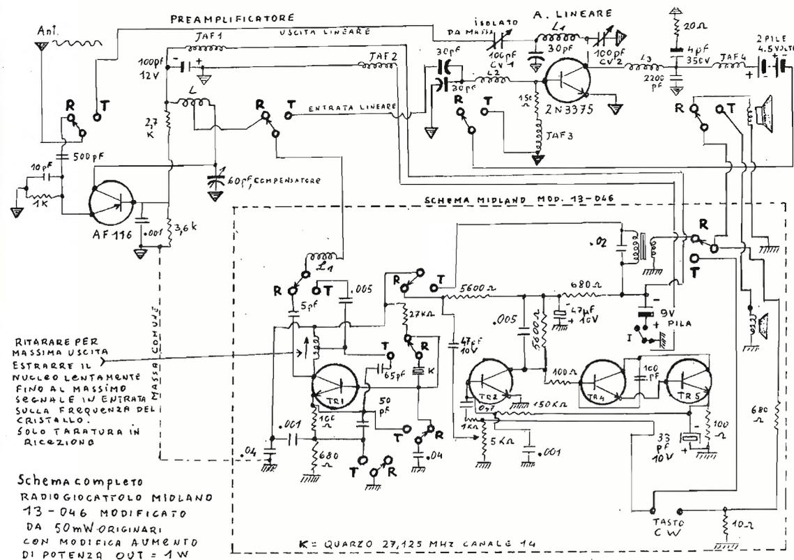
Si smonta la basetta del circuito stampato del Midland dal suo contenitore originale di plastica, si leva l'antenna a stilo e si monta detta basetta nel mobiletto metallico su tre supporti filettati; ovviamente, prima si saranno
