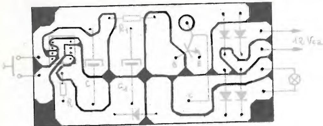
Si diluisce della vernice cinese (di consistenza normale, quindi **non** in precedenza diluita per altri lavori — in questo caso occorre adeguare le dosi di diluente al necessario) nelle proporzioni 5 parti di vernice per 1 parte di diluente. Si vernicia il rame e si lascia asciugare. La superficie del rame deve essere **interamente** ricoperta dalla vernice.
