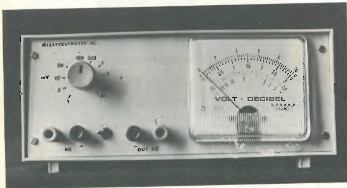
Il guadagno di tutto lo stadio è pari a 100 ed è un ottimo compromesso tra una buona sensibilità di ingresso (100  $\mu$ V<sub>eff</sub> max) e una bassa distorsione armonica (inferiore allo 0,1 %).
