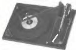
Giradischi BSR inglese, cambiadischi automatico, 3 velocità, sollevamento a levetta, antiskate, con testina stereo, L. 42.000
