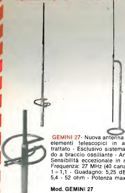
**GEMINI 27** - Nuova antenna per DX ad elementi telescopici in anticorodal trattato - Esclusivo sistema di accordo a braccio oscillante - Antistatica - Sensibilità eccezionale in ricezione - Frequenza: 27 MHz (40 canali) - SWR: 1+1,1 - Guadagno: 5,25 dB - Alt. m. 5,4 - 52 ohm - Potenza max. 2000 W.
