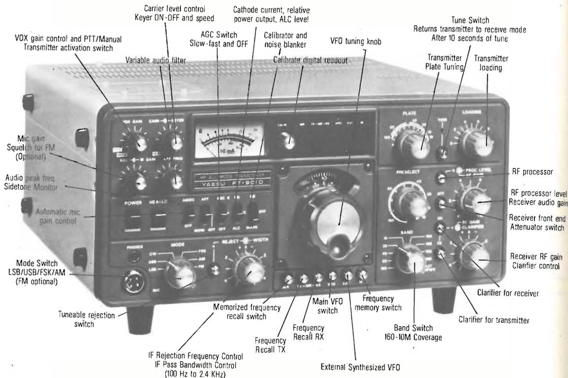
■ ALL MODE 160-10 mt. AM-FM-SSB-CW-FSK e lettura digitale. ■ Due potenti valvole finali 6146 B. ■ Filtro passa banda regolabile I.F. ■ Rejection tuning I.F. ■ Filtro passa banda B.F. ■ Unità di memoria (Opzionale) che permette in ricezione e trasmissione di operare con doppio V.F.O. ■ Speech Processor ed
