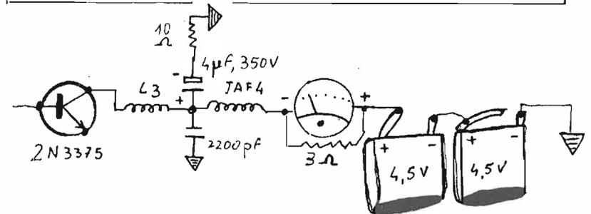
MICROAMPEROMETRO DA 500  $\mu\text{A}$  FONDO SCALA, AUMENTATA LA PORTATA A 500  $\mu\text{A}$  FONDO SCALA CON RESISTENZA DA  $3 \Omega$  IN PARALLELO ALLO STRUMENTO.
