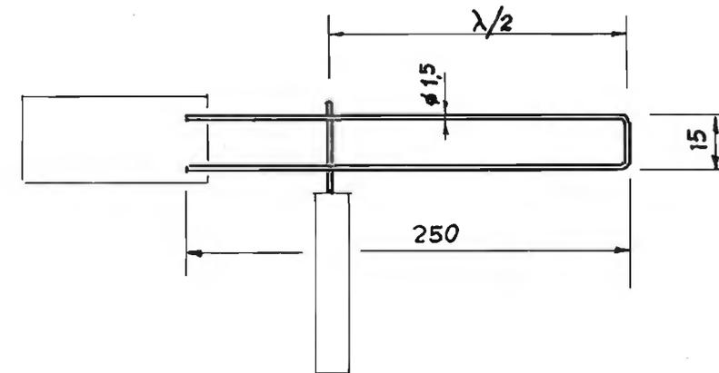
Per controllare la lunghezza d'onda ottenuta occorre usare i fili di Lecher. Ripiegare a U del filo di rame  $\varnothing$  1,5 mm seguendo il disegno, avvicinare la parte unita dei fili al generatore, far scorrere un ponticello di corto circuito dal basso verso l'alto, segnando sui fili la posizione in cui il segnale sparisce dal video. Le distanze così ottenute saranno pari a  $\lambda/2$ . Le frequenze saranno pari a  $300.000/\lambda$ .\*\*\*\*\*
