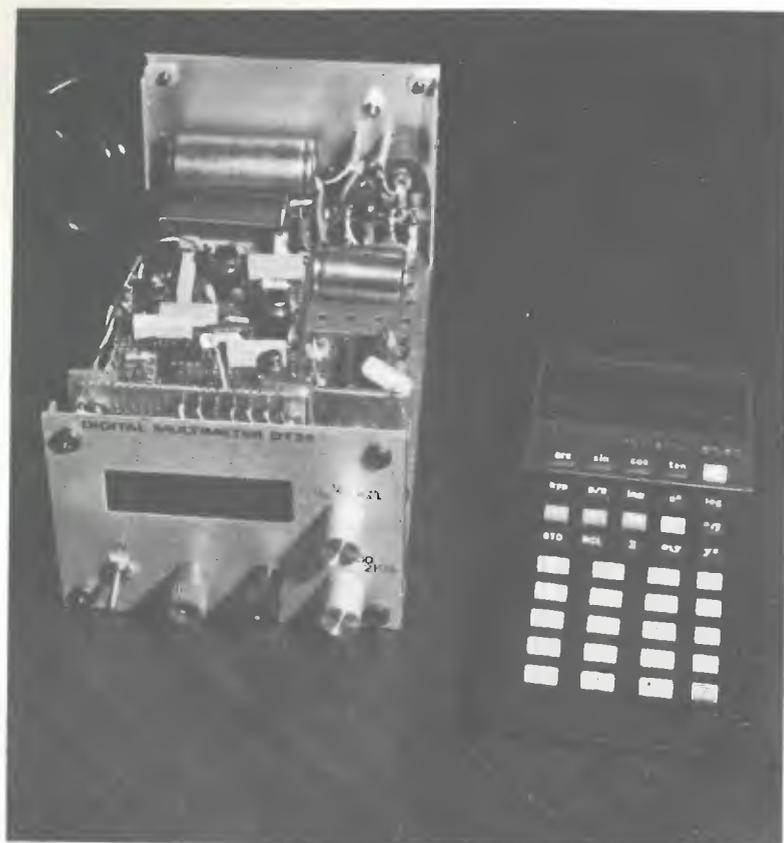
Il cuore di tutto il complesso è formato dall'integrato DV8007 che comprende un contatore a tre cifre e mezzo (cioè un contatore a tre cifre che permette un overrange del 100%: in pratica un contatore da 0 fino a 999), una memoria, un circuito multiplexer, una decodifica per visualizzare il risultato della misura, e un circuito di controllo che comanda gli altri blocchi che costituiscono lo strumento.
