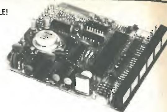
Oltre che come normale frequenzimetro, si può usare abbinato a qualsiasi RICEVITORE-TRASMETTITORE-RICETRAS per leggere direttamente la frequenza di ricezione e di trasmissione (adatto anche per SSB).
