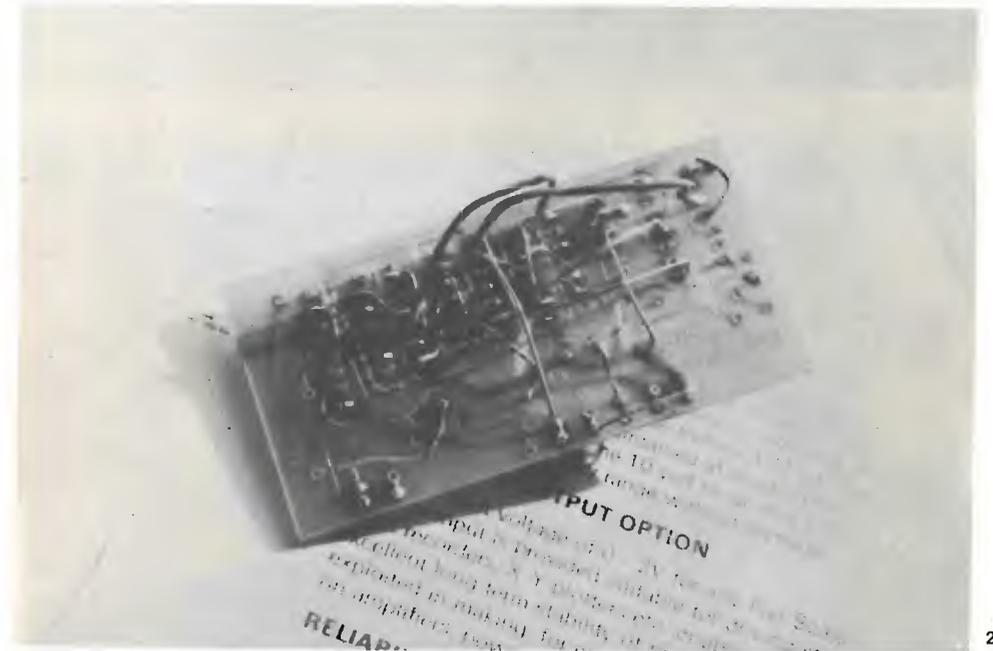
Sistema corrente per la sperimentazione di prototipi elettronici. Aspetti negativi di questo metodo risiedono nella necessità di operare saldature con fili più o meno ridigi, nel difficile riutilizzo dei componenti impiegati, alto tempo speso per le saldature, le connessioni e le eventuali modifiche.
