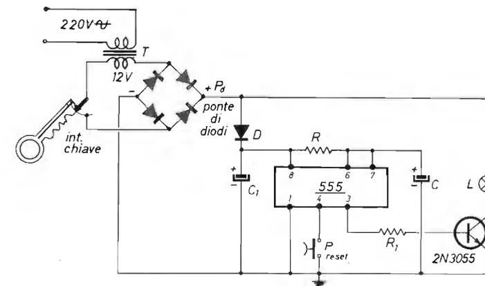
T trasformatore di alimentazione 220→12 V<sub>ca</sub>, 15 W
