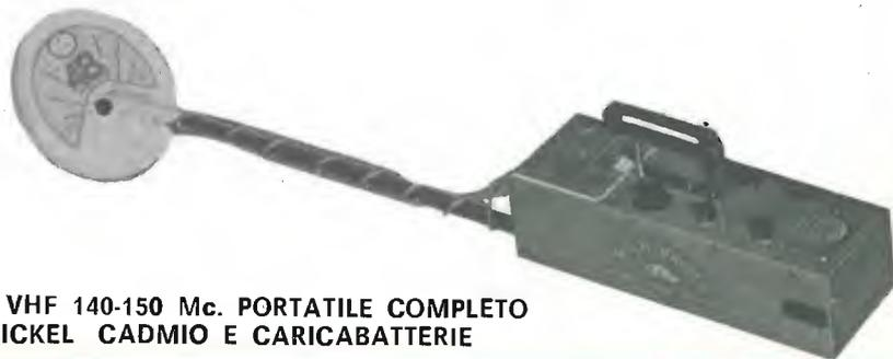
RICETRASMETTITORE VHF 140-150 Mc. PORTATILE COMPLETO DI BATTERIE AL NICKEL CADMIO E CARICABATTERIE
