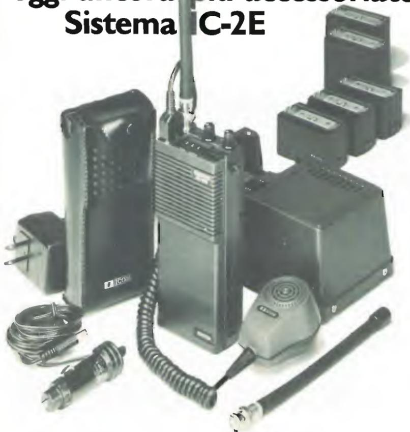
Oggi è giusto parlare del sistema IC 2E, perché, con la vasta gamma di accessori, questo portatile per i due metri è diventato una vera e propria centrale di comando.
