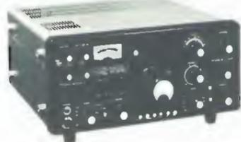
FT 101 ZD: ricetrasmittitore per bande radioamatoriali e CB - WWWJJY-SSB-CW-AM 180 W - VOX - AGC.
