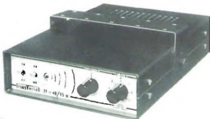
L'applicazione di questo transverter in serie tra un qualsiasi Trasmettitore CB (Baracchino) e l'antenna 40/45 metri, come un normale amplificatore lineare, permette al CB di entrare nella nuova frequenza del 40/45 metri.
