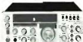
FT 107 M: ricetrasmittitore sulle duecentriche da 160 a 10 m. pu WWWJJY e due bande opzionali SSB CW-AM-FSK. 240 W. (in SSB) - memoria DMS.
