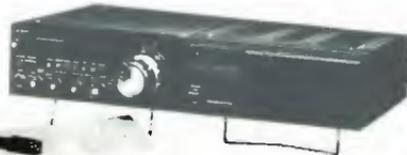
FT 707: ricetrasmittitore per bande radioamatoriali da 80 a 100 metri WWWJJY - AM CW-ULS-LSB-240 W. (in SSB) - 2 bande ausiliarie.
