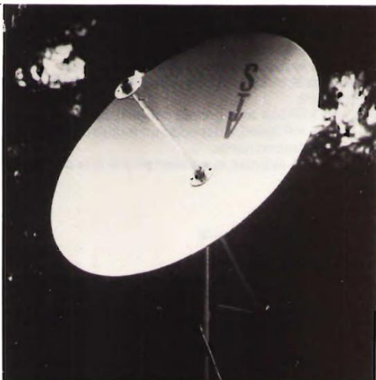
Nella foto qui sopra potete vedere una parabola da un metro con illuminatore a linea coassiale, e con il preamplificatore posto al termine della guida subito dopo la parabola.
