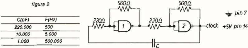
Questo circuito è stato montato usando un circuito integrato 7400 della Texas e in tabella sono riportati i valori della frequenza di oscillazione in funzione del valore della capacità del condensatore C.
