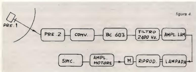
Passano in un filtro accordato a 2.400 Hz e sono così attenuati i disturbi di differente frequenza. Vi è poi l'amplificatore della lampada Sylvania R-1168 con il relativo obiettivo f.20 mm.
