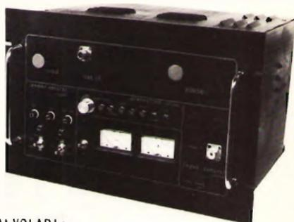
Dati tecnici: programmazione a mezzo di 4 contraversi binari; -frequenza out 87-108 oppure 52-68mhz; -potenza out regolabile; -entrata stereo e mono con preenfasi; -attenuazione prodotti spuri e armoniche a norme; -distorzione in b.f. < dello 0,3%; -diode led di aggancio; -
