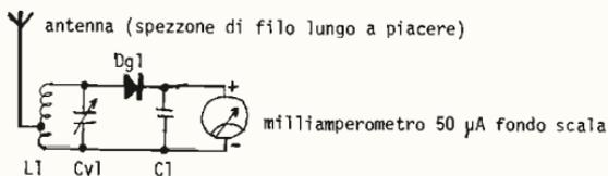
$L1 = 10$  spire di filo smaltato da 1 mm di diametro avvolte su supporto da 1 cm di diametro spire avvolte serrate con presa alla seconda spira lato massa per l'antenna.
