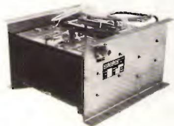
I ns. moduli di potenza estremamente robusti ed affidabili, amplificano segnali in gamma 88-104 MHz senza necessità di alcun accordo o taratura. Sono ovviamente componibili per ottenere maggiori potenze d'uscita: 800, 1600 W e potendo assumere varie configurazioni si può ottenere il livello di eccitazione all'ingresso desiderato: 10, 40, 200 W per il sistema da 800 W oppure 20, 80, 400 W per quello da 1600 W.
