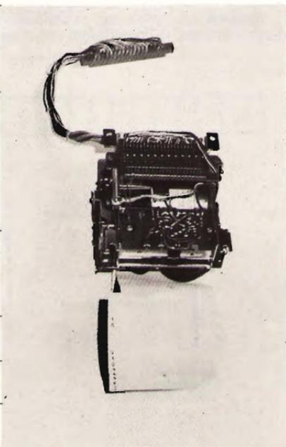
Nella parte inferiore della meccanica (vedi foto) è presente il circuito di controllo del motore che fa capo ai terminali 18, U, V del connettore; precisamente il terminale 18 va collegato al positivo dei 12 V di alimentazione, il V al negativo e il terminale U controlla il movimento: quando è collegato al negativo, il motore è in moto. Non è riportato il circuito del servocomando che utilizza uno SCR in modo del tutto convenzionale.
