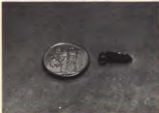
Foto di un prototipo (sola parte oscillatrice AF); la moneta da 100 lire da un'idea delle dimensioni.
