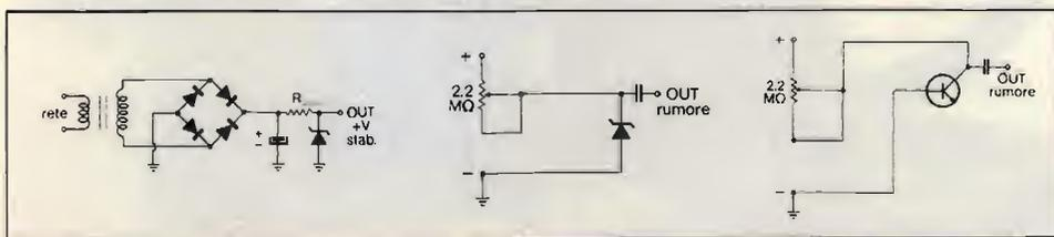
re/base di un transistor per UHF (anch'essa avente caratteristiche zener con tensioni variabili da 3,5 a 7 V a seconda del transistor usato) si possono avere generazioni di rumore ben superiori al gigahertz!
