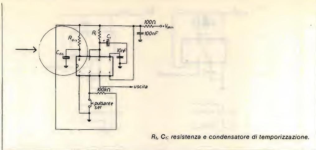
● *Eliminato questo problema disaccoppiando il pin 8, se ne viene però a creare un altro: nel caso volessimo pilotare direttamente un carico pesante, rischiamo che la tensione scenda sotto quella necessaria a mantenere in funzione l'integrato.*
