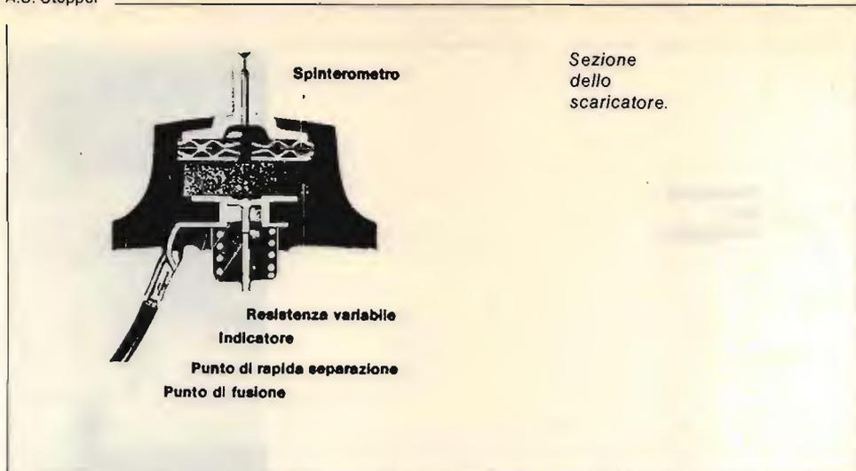
scaricatore viene quindi attraversato da una corrente impulsiva molto intensa. Al cessare della sovratensione, nello scaricatore circola la sola corrente a frequenza industriale, limitata dalla resistenza, corrente che viene interrotta dallo spinterometro al primo passaggio per lo zero, ristabilendo così l'isolamento tra linea e terra.
