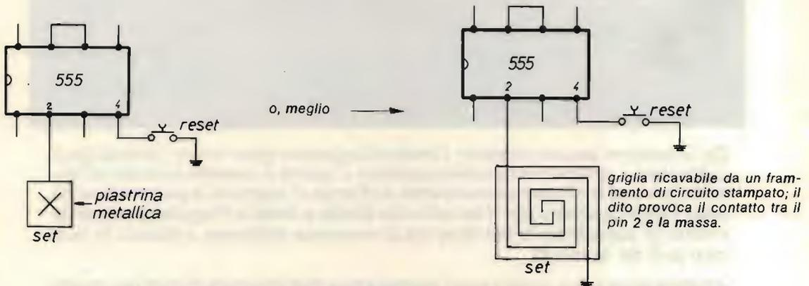
Il reset si può ottenere anche con una piastrina metallica o una griglia meno fitta della precedente collegata sui pin 6 e 7 (non sul 4: ricordo che sul pin 7 c'è lo stadio che scarica il condensatore a massa. In questo caso il valore del condensatore diventa un tantino critico, e bisogna cercare un compromesso: un valore più basso rende più sensibile il reset e viceversa. Sperimentate, gente, sperimentate!
