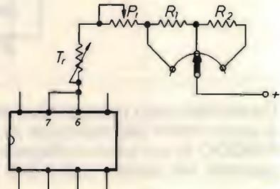
$R_1, R_2$  = 2,2 M $\Omega$ , 1/2 W, 0,5 o 1%
