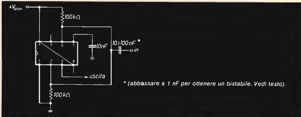
Da osservare alcune cosette: l'onda di ingresso deve avere un'ampiezza sufficiente a provocare la commutazione. L'uscita è invertita rispetto all'entrata (perché è il fronte discendente dell'onda di ingresso a portare l'uscita alta). Infine da notare che il circuito non divide a metà la frequenza di entrata (come gli squadratori a flip-flop) ma la mantiene inalterata, e questo in certi casi può far comodo.
