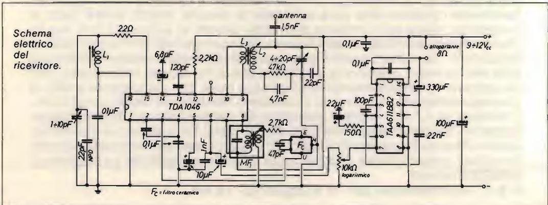
L'oscillatore locale viene accordato per mezzo di  $L_1$  e del compensatore da  $1 \div 10$  pF, mentre l'accordo d'antenna è ottenuto con  $L_2, L_3$  e il compensatore da  $4 \div 20$  pF; l'accordo di MF è affidato a una media frequenza da 455 kHz, color nero, con condensatore entrocontenuto (MF1).
