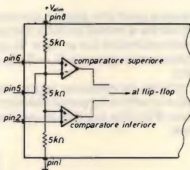
Osservate che i comparatori sono polarizzati in comune dalle tre R di 5 kΩ, e sono riferiti alla tensione di alimentazione.
