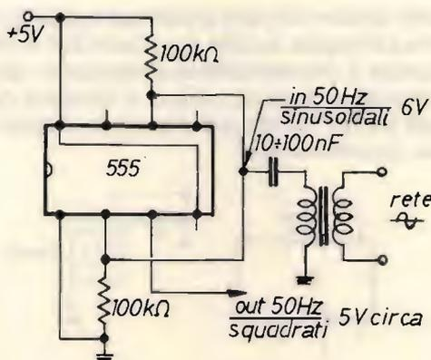
● Il medesimo circuito può funzionare come bistabile solo diminuendo il valore del condensatore di entrata intorno a 1 nF. In questo modo passeranno soltanto i fronti degli impulsi di ingresso, che porteranno alternativamente l'uscita alta e bassa. Anche in questo caso, è chiaro, l'uscita sarà invertita.
