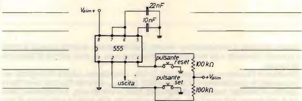
Si tratta in pratica di un monostabile senza resistenze di temporizzazione. In questo modo l'uscita rimane memorizzata alta per un tempo indefinito in quanto il condensatore non si può scaricare.
