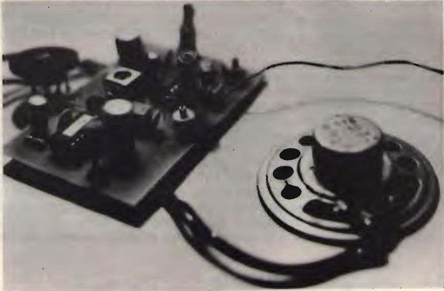
Prototipo del ricevitore.
