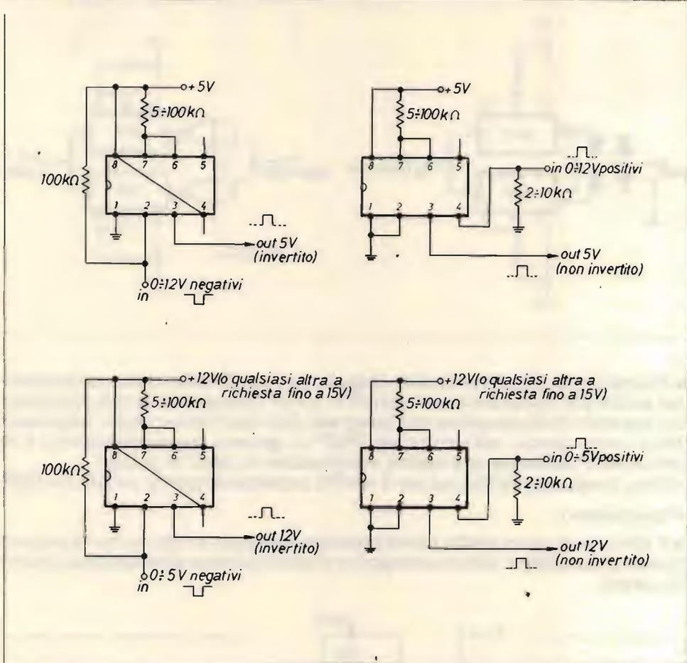
Viene sfruttato il comparatore interno dell'integrato: poiché questo è praticamente riportato alla tensione di alimentazione, lo sarà anche la tensione di uscita.
