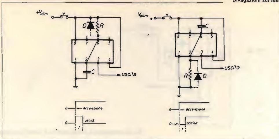
La durata dell'impulso ( $T$ ) si calcola con la formula usata per la configurazione monostabile ( $1,1 RC$ ). Questo impulso, come si nota nei diagrammi, è positivo se il condensatore è riportato a massa, negativo con il condensatore verso il positivo. Il diodo  $D$  (un comune 1N914 o 1N4148 serve a rendere più "veloce di riflessi" il circuito scaricando subito il condensatore quando viene tolta la tensione. Non è necessario se il circuito non deve riprendere a lavorare immediatamente.
