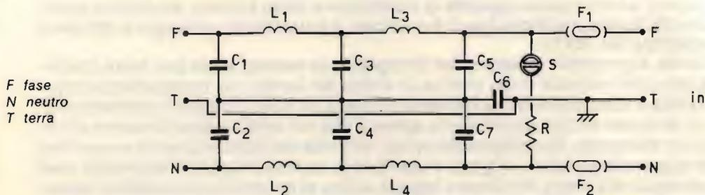
L'idea base era buona per cui valeva la pena sfruttarla. Si tratta essenzialmente di un doppio filtro a pi-greco chiuso su una linea collegata a terra dal condensatore  $C_7$ . Oltre a espletare una funzione di blocco sulle frequenze elevate, disturbi di commutazione di triac o SCR ( $L_1$  e  $L_3$  hanno valori di induttanza differenti), i valori dei condensatori sono sufficientemente elevati da limitare i lenti picchi di sovratensione.
