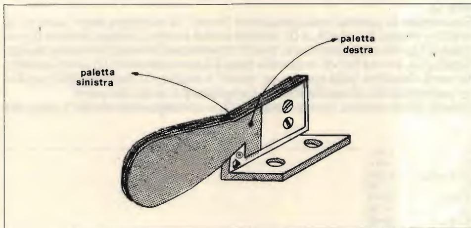
Entrambe sono state realizzate utilizzando della normale piastra per circuiti stampati con ramatura da un solo lato. Per evitare l'ossidazione del rame, ovviamente messo a nudo per favorire il contatto capacitivo con la mano, entrambe sono state stagnate. Quindi, nel montarle, le due facce stagnate debbono essere rivolte verso l'esterno.
