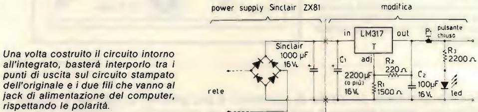
Il ponte è quello originale, l'elettrolitico è della Facon da 3.300  $\mu\text{F}$ , 25 o 16 V<sub>L</sub>, cercatene uno che si incastri preciso tra il trasformatore e i due supporti di plastica cui vanno fissate le viti del coperchio. Una volta incastrato saldamente l'elettrolitico, incollatelo con del mastice, saldategli due fili di un millimetro di diametro e collegatelo ai diodi del ponte Sinclair (in parallelo a quello originale).
