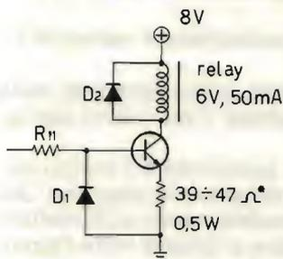
\* regolare per avere 6 V ai capi della bobina del relay.
