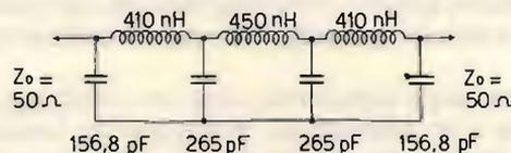
La scelta del tipo Chebyshev al posto del più usato Butterworth è data dall'esigenza di attenuare maggiormente la seconda armonica, infatti con un Butterworth la seconda non viene attenuata oltre i 42,14 dB mentre con un Chebyshev a parità di elementi l'attenuazione di seconda armonica è di
