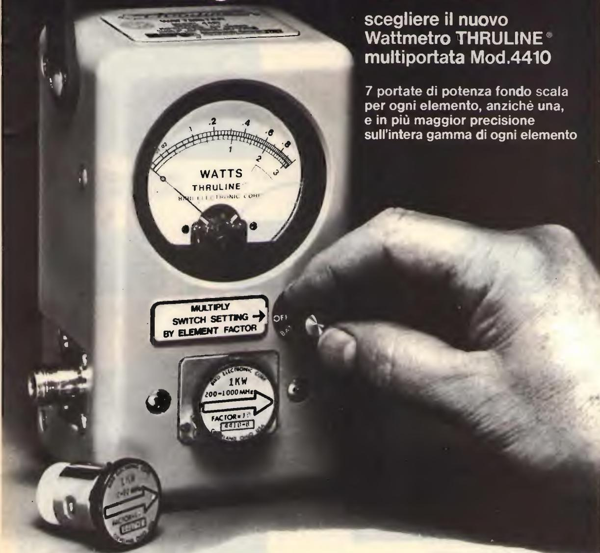
**MODELLO 4410: UN NUOVO WATTMETRO RF BIDIREZIONALE PORTATILE MULTI-PORTATA** 1/3/10/30/100/300/1.000 Watt oppure 10/30/100/1.000/3.000/10.000 Watt per ogni elemento nel campo di frequenze da 0,2 a 1000 MHz per segnali CW oppure FM. Precisione  $\pm 5\%$  DELLA LETTURA da 200 milliwatt in su (2-1000 MHz) su gamma di temperatura compensata da 0°C a 50°C.
