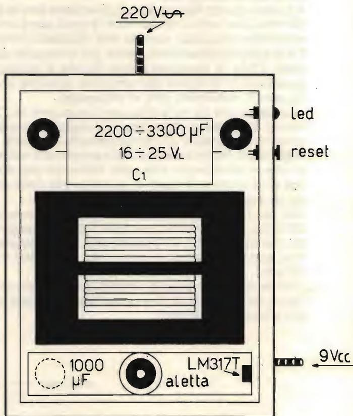
*Ecco la disposizione della modifica. Sia il C<sub>1</sub> che l'aletta si incastrano tra il trasformatore e i supporti di plastica. Fasciate i contorni del trasformatore con del nastro isolante per evitare corto circuiti.*
