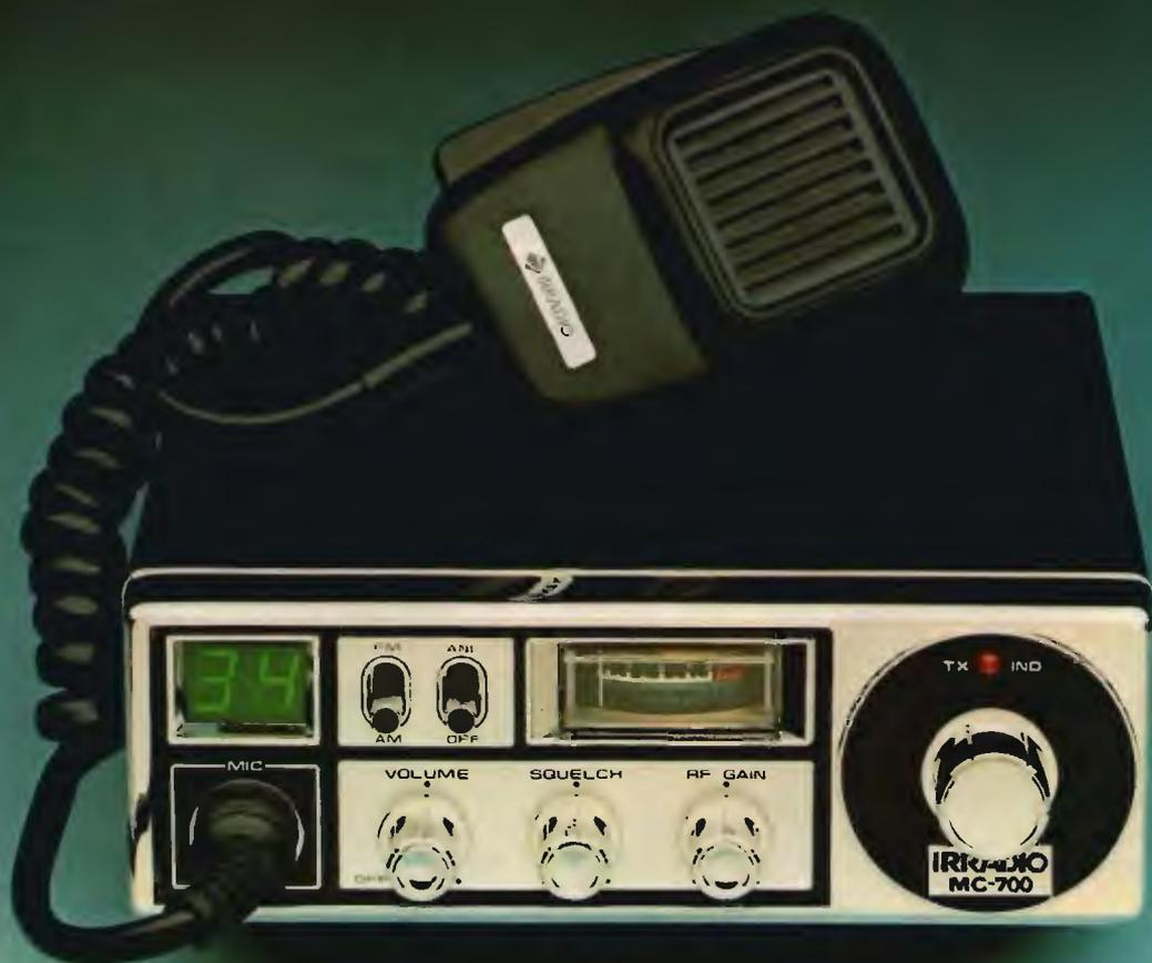
Lo MC-700 è un ricetrasmittitore mobile realizzato con la tecnologia PLL. Offre i 34 canali (23+11) autorizzati nella banda CB dei 27 MHz. Opera nei modi AM e FM. Potenza 1,5 W. È completo di RF gain e di filtro ANL. Lo MC-700 è omologato dal ministero delle PP.TT. Numero omologazione DCSR/2/4/144/06/79537.
