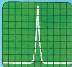
Rilevazioni di caratteristiche di ricevitori con generatori a bassissimo rumore (spectral purity migliore di -135 dBc, risoluzione di 0,1 Hz).
