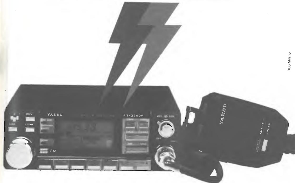
Praticamente due ricetrasmittitori in uno, questo è l'ultimo nato in casa YAESU. Il primo Dualbander con 25 Watt di output in un unico chassis. La presenza di un microprocessore provvede alla gestione di 10 memorie, doppio VFO e due frequenze con Backup di batterie al litio. Il sistema YAESU PMS permette inoltre lo scanning tra le memorie. Quattro differenti possibilità operative: RX-TX in VHF; RX-TX in UHF; RX in VHF e TX in UHF; RX in UHF e TX in VHF.
