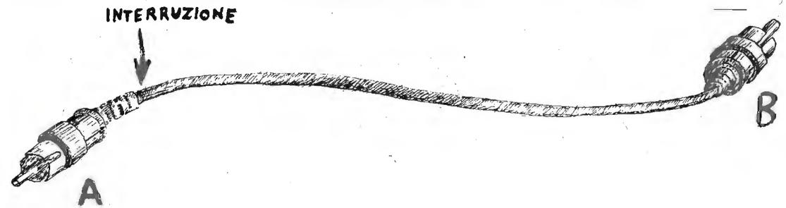
dei bocchettoni poi mi venne il pallino di scoprire **dove** si trovava l'interruzione, ragionando per logica l'interruzione aveva grosse possibilità di trovarsi in prossimità di uno dei due bocchettoni o per difetto di saldatura o per sconnessione dovuta a movimenti continui dei suddetti, la mia ipotesi in seguito a opportuni accertamenti strumentali si rivelò **esatta**.
