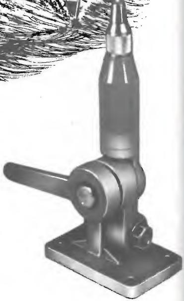
**Frequenza 26 - 30 MHz;** Impedenza **50 Ω**; Potenza massima **50 W**; R.O.S. **1 - 1:1**; Numero canali **40**; Altezza massima **160 cm.**; Peso **400 gr.**; Cavo **RG 58 A/U m. 4**; Materiale della base **nylon**; Materiale dello stilo **fiberglass.**
