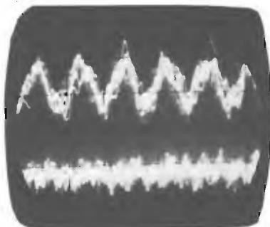
Segnale BF disturbato da un segnale sinusoidale (traccia superiore).
