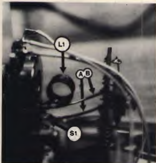
Particolari costruttivi della bobina L_1 : per misurare il campo e.m. sui 144 MHz, si cortocircuiteranno i due spezzoni "A" e "B" con il commutatore S_1 .
