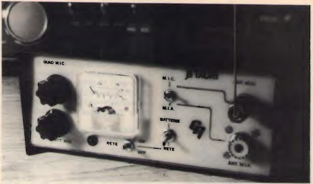
Il più o meno elevato grado di deviazione della lancetta dello strumento testimonierà, in maniera inequivocabile, la presenza e l'intensità relativa di un campo e.m. di una data frequenza.
