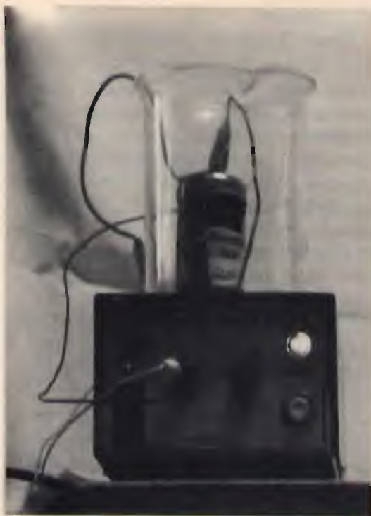
Grafico 6 Pila stilo 1,5 V. Scarica 50 mA/h. Ricarica 50 mA/h.
