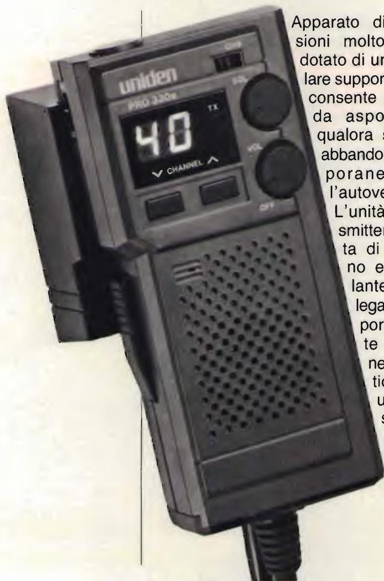
Apparato di dimensioni molto ridotte, dotato di un particolare supporto che ne consente una rapida asportazione qualora si debba abbandonare temporaneamente l'autovettura.
