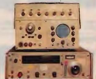
*Sopra:* TEST-SET 0 ÷ 500 MHz generatore di segnali digitale, con monitor per ricezione, ottimo per tutti i transceiver agenti da 0 ÷ 500 MHz.
