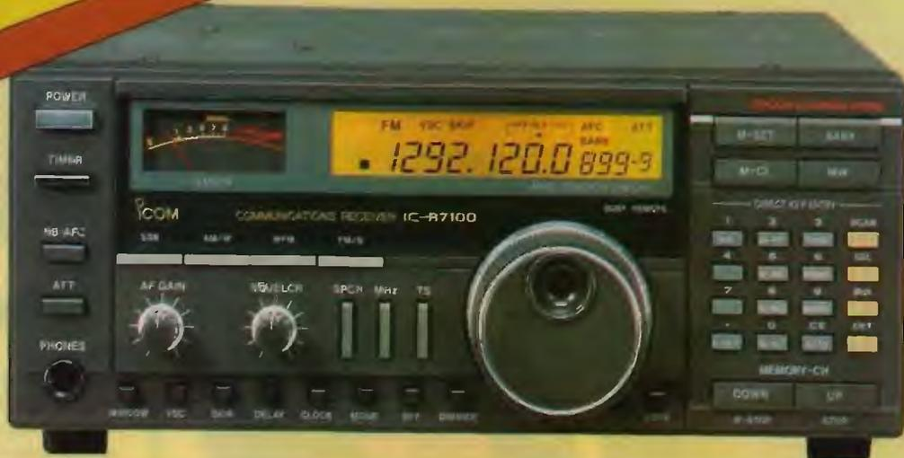
Significa poter accedere a qualsiasi segnale iniziando da 25 MHz sino a 2000 MHz includendo i servizi d'amatore ed altri sino alle emissioni FM, TV e successivamente ai ponti radio in FDM. Le capacità di demodulazione comprendono la SSB, AM, AM larga, FM, FM stretta con in aggiunta la TV (opzionale) e la FM in stereo (pure opzionale)
