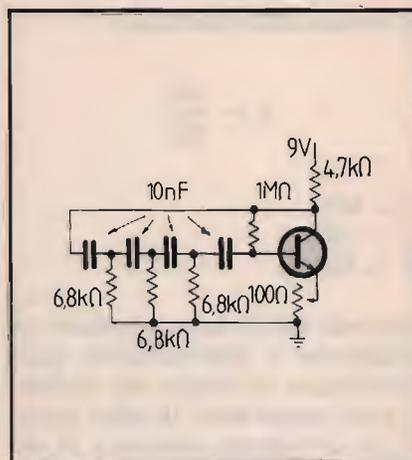
⑤ Oscillatore a sfasamento con una cella RC in più rispetto alla figura 3. Il circuito oscilla più facilmente, in quanto per una rete a quattro RC è richiesta un'amplificazione di tensione minore. La frequenza è quasi raddoppiata rispetto al circuito a tre RC.
