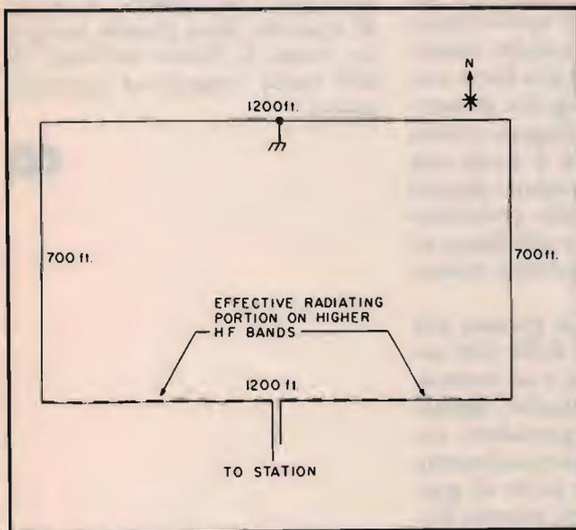
⑤ Sulle bande alte l'irradiazione si verifica principalmente lungo il primo tratto del loop, lasciando ipotizzare la direttività dell'antenna. In pratica non si sono riscontrate differenze significative rispetto a un'antenna omnidirezionale.
