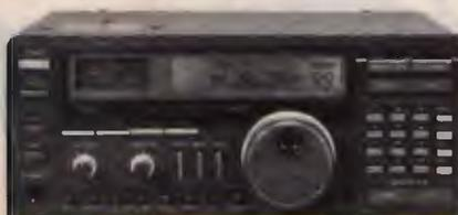
Dimensioni compatte; risulta notevolmente più piccolo rispetto agli altri ricevitori. 100 dB di dinamica; conseguiti dallo stadio convertitore posto all'ingresso di A.R.F. Sistema DDS: il nuovo sintetizzatore, simile a quelli usati in apparati di classe (IC-781; IC-R9000). Attenuatore di AF e preamplificatore. Orologio/temporizzatore interno. Efficace Noise Blanker
