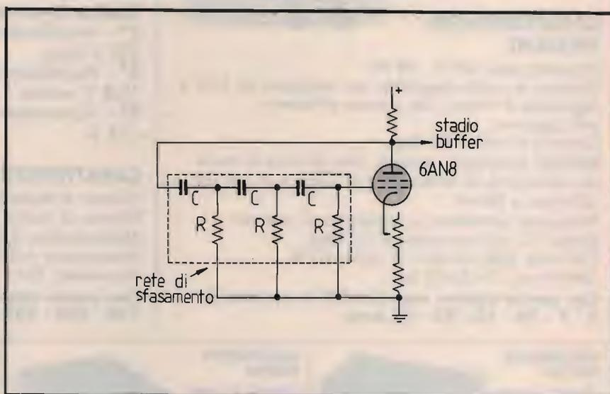
① Oscillatore a sfasamento mediante una rete composta da tre capacitori e da tre resistori. La rete RC introduce una sensibile perdita che deve essere compensata da una valvola o transistor ad alto guadagno. Per minimizzare la distorsione, il trimmer sul catodo va regolato in modo che il guadagno sia appena sufficiente a sostenere l'oscillazione. Per la stabilità del segnale è necessario un cathode-follower (la 6AN8 è un triodo-pentodo). La frequenza è inversamente proporzionale ad RC.
