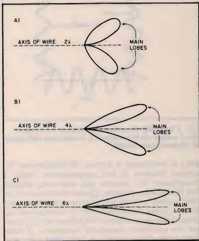
② I lobi di irradiazione principali di una filare terminata, in relazione alle dimensioni espresse in lunghezze d'onda.
