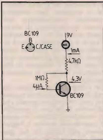
② **Schema dello stadio amplificatore. A causa della dispersione delle caratteristiche, il resistore di polarizzazione da 1 Mohm va ritoccato in modo da avere sul collettore circa la metà della tensione di alimentazione. Il resistore di polarizzazione collegato al collettore stabilizza il circuito, anche se comporta una riduzione dell'amplificazione, che resta tuttavia sufficientemente alta.**
