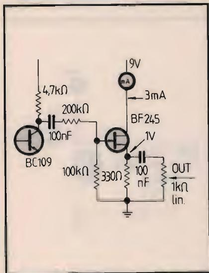
④ Stadio buffer costituito da un FET montato nella configurazione source-follower. Il resistore da 200 kohm sul gate è necessario per diminuire il segnale sul gate, allo scopo di ridurre la distorsione.
