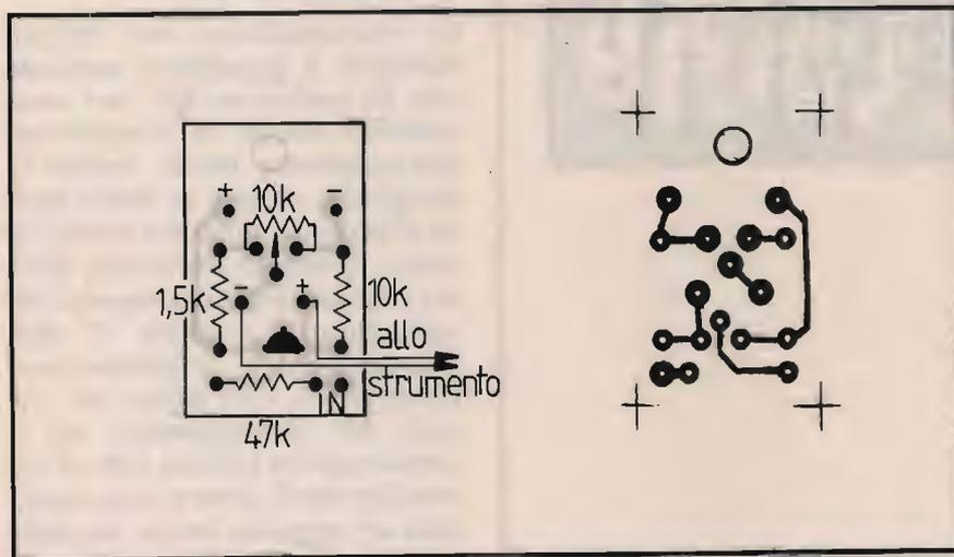
Circuito per lo strumento indicatore di sintonia. Lato componenti.
