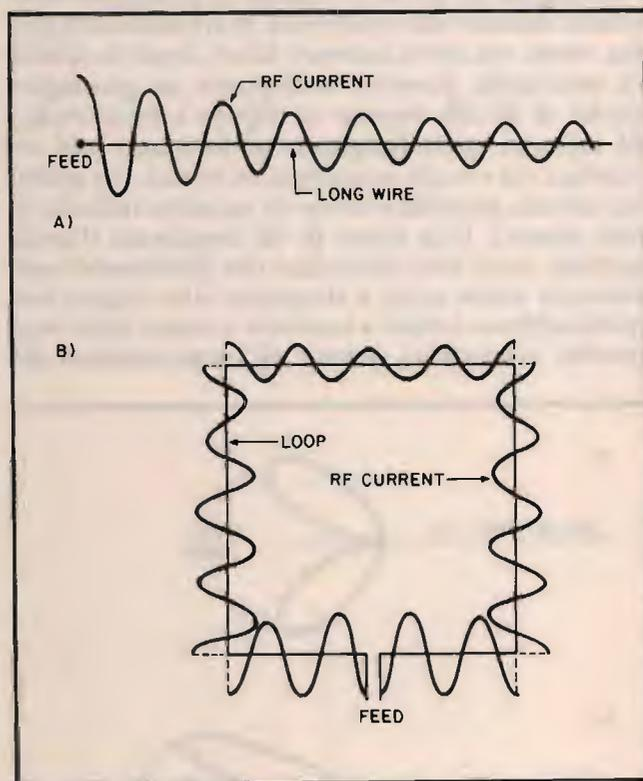
① L'intensità di corrente diminuisce man mano che il campo elettromagnetico si allontana dal punto di alimentazione (feed).
