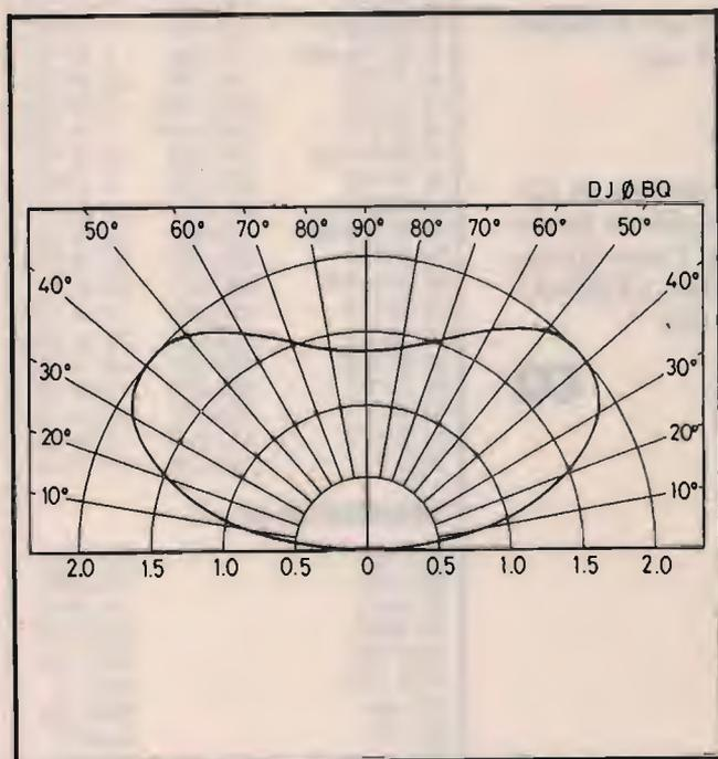
5 Fascio di radiazione sul piano H di una Yagi a due elementi con una spaziatura di  $5/8 \lambda$
