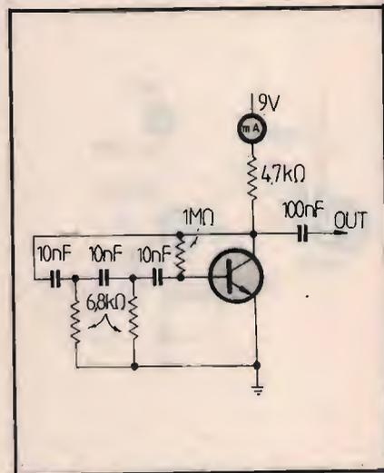
③ **Oscillatore a sfasamento con una rete di tre RC (il terzo R è la capacità input del transistor). Il livello d'uscita è di 2 ÷ 3 V eff. Il segnale può essere ascoltato collegando una cuffia ad alta impedenza.**
