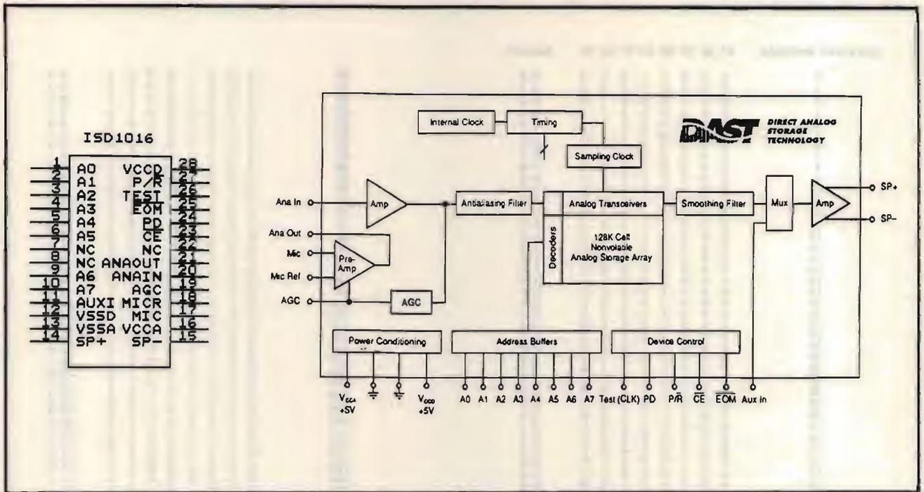
catore è denominata ANA OUT (Pin 21) e si può connettere, per applicazioni non in cascata, all'ingresso ANA IN (pin 20) attraverso un condensatore la cui funzione è quella di introdurre uno zero realizzando un filtro passa alto a 60 Hz. Le caratteristiche di tale ingresso sono:
