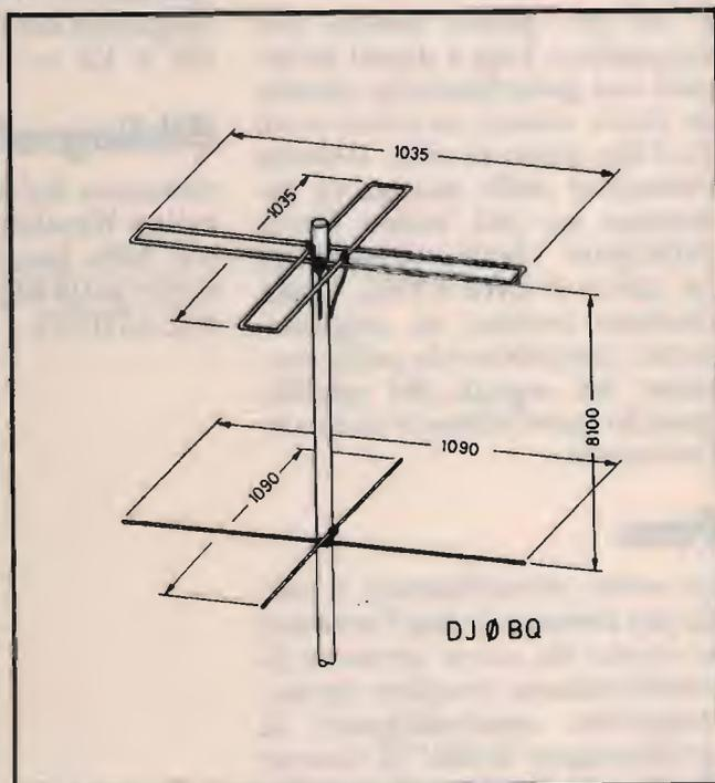
6 Dettagli costruttivi dell'antenna.
