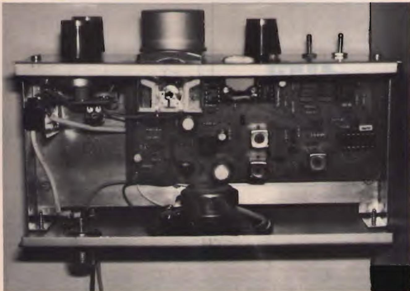
Ricevitore montato visto dalla parte superiore del contenitore.
