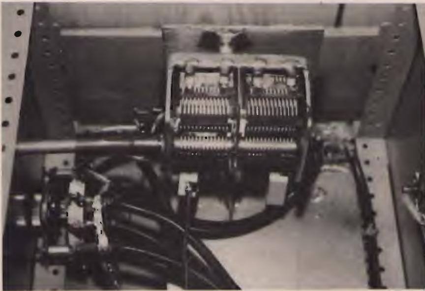
⑤ Particolare del commutatore ceramico e del doppio condensatore variabile C1; si noti anche il tubetto che isola i perni.
