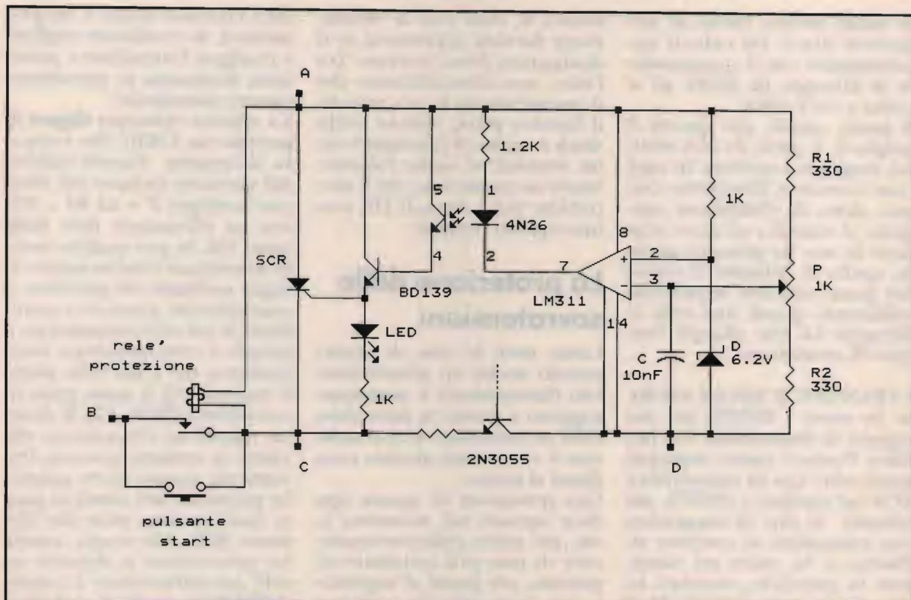
② Schema elettrico del circuito di protezione contro le sovratensioni.
