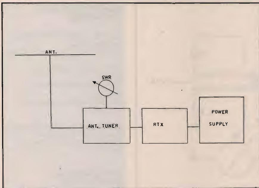
9 Schema a blocchi di inserzione dell'accordatore.
