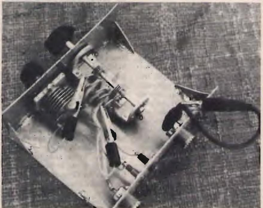
(A) L'adattatore di impedenza per i 2 metri.
