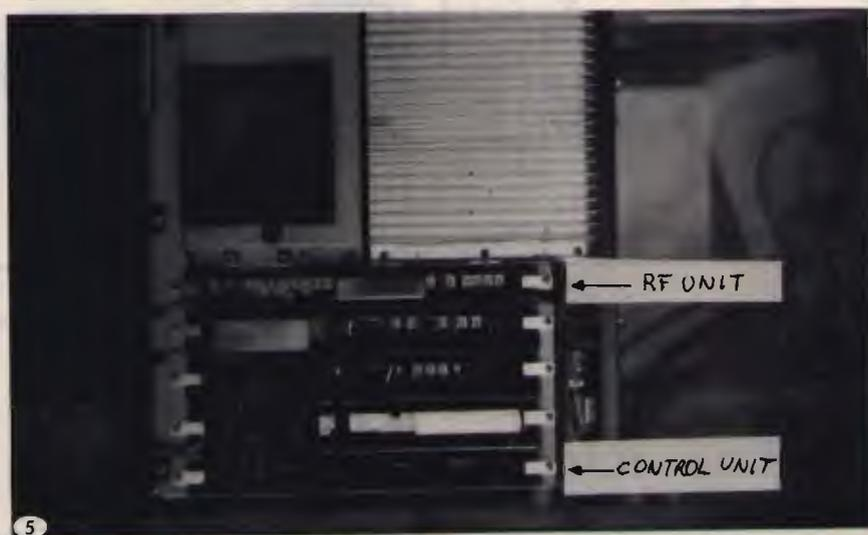
Come si può notare, la costruzione è di tipo modulare con un uso estensivo di schede connesse tra loro attraverso una mother-board. Una realizzazione di questo genere ricorda immediatamente quella di un personal computer oppure quella di un apparecchio di tipo militare. Non vi sono "salami" di fili che girano da una scheda all'altra e sono convinto
