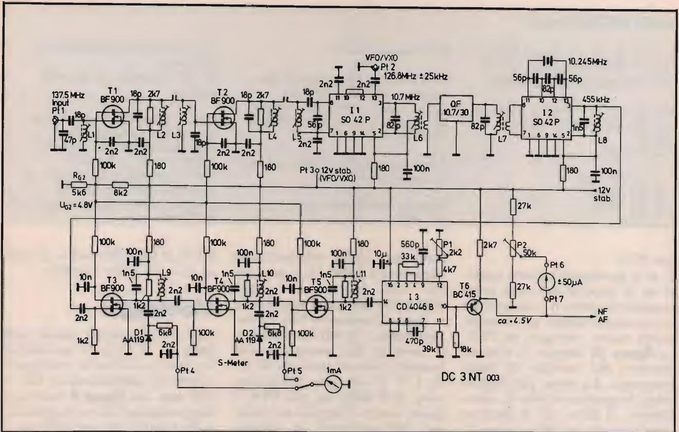
① Il modulo VHF/IF del ricevitore VHF.
