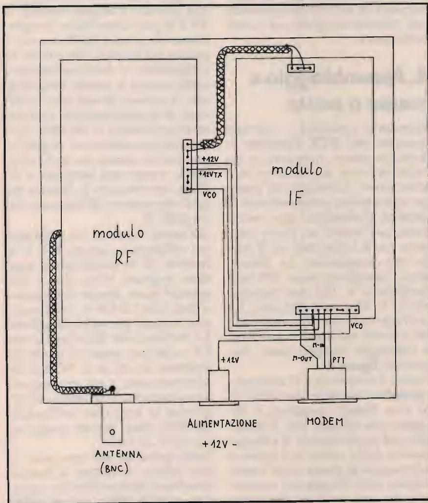
⑧ Disposizione e collegamento dei moduli del RTX FM a larga banda per i 70 cm.
