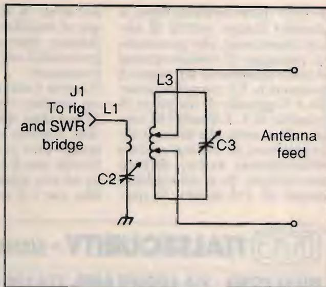
③ Una variazione del circuito di figura 2, che consente l'uso di un variabile a sezione singola.
