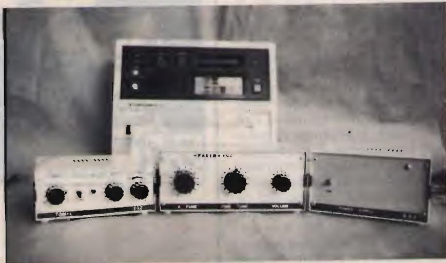
② Sistema ricevente delle emissioni meteo fax di DCF 54 il ricevitore "FAX1R", il sintonizzatore a moltiplicatore di Q "TQM1L" e l'alimentatore da rete per tutto il complesso. Sul fondo, il ricevitore Furuno del quale è stata utilizzata la sezione di decodifica e riproduzione delle carte meteo fax.
