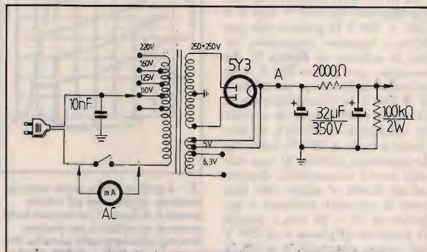
① Schema standard di stadio alimentatore per ricevitori valvolari. L'amperometro in alternata sul primario serve per monitorare costantemente la corrente assorbita ed evitare il danneggiamento del trasformatore, che non è facilmente sostituibile. Il resistore bleeder all'uscita scarica gli elettrolitici ed evita pericolose scosse al riparatore.
