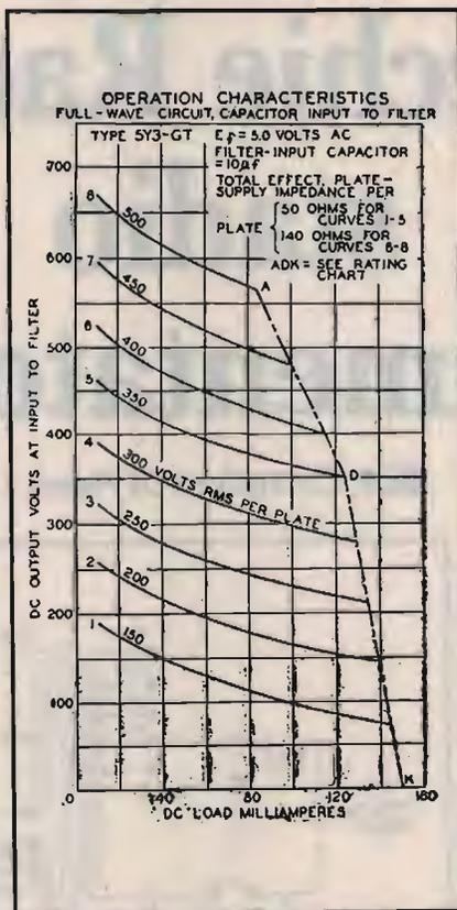
② Il grafico indica come varia la tensione raddrizzata sul catodo (punto A di figura 1) al variare della corrente assorbita e per diverse tensioni alternate sulle placche. Per esempio, con 250 + 250 V sulle placche, la tensione raddrizzata deve essere circa 250 V per un assorbimento di 80 mA.
