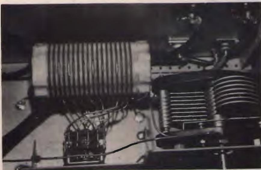
⑥ Particolare della bobina del relativo commutatore e del condensatore C2.
