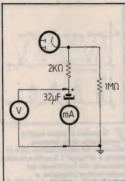
③ Schema per il controllo della corrente di fuga degli elettrolitici. Iniziare la prova con tensione ridotta per dar tempo ai condensatori di "riformare" il sottile ossido che costituisce il dielettrico e che tende ad assottigliarsi in caso di inattività dell'apparato. Dopo aver spento l'alimentatore, il condensatore si scarica lentamente attraverso il grosso resistore da 1 Mohm, il che permette di valutare la reale capacità dell'elettrolitico.
