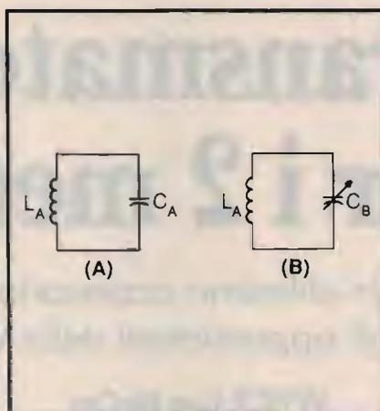
① In A un circuito a sintonia fissa; in B si impiega un condensatore variabile per consentire la sintonia su varie frequenze.
