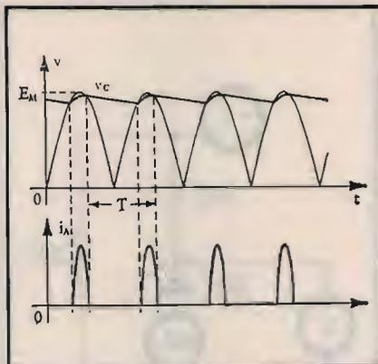
④ Il grafico di sopra mostra l'andamento della tensione all'uscita del raddrizzatore, cioè al punto A di figura 1. Il grafico di sotto evidenzia che la corrente nel raddrizzatore (valvolare o solid-state) è costituita da picchi di forte intensità.
