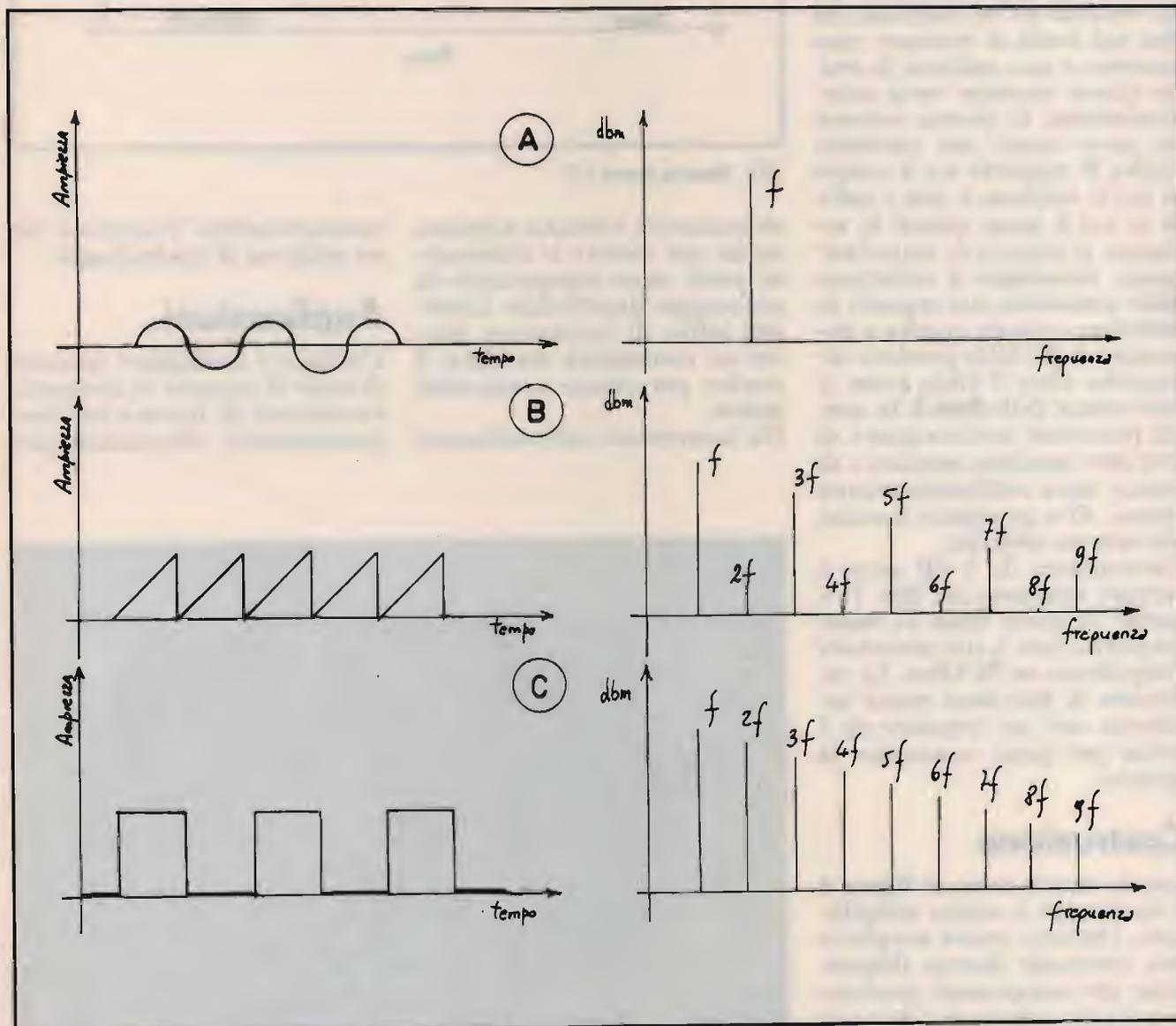
③ Spettro di onda sinusoidale (a), triangolare (b), quadra (c).
