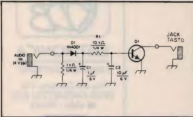
② Il tasto Morse può anche essere rimpiazzato da un circuito elettronico. Quello schematizzato in figura può essere pilotato da un riproduttore di cassette o da un amplificatore BF al cui ingresso sia collegato un microfono.
