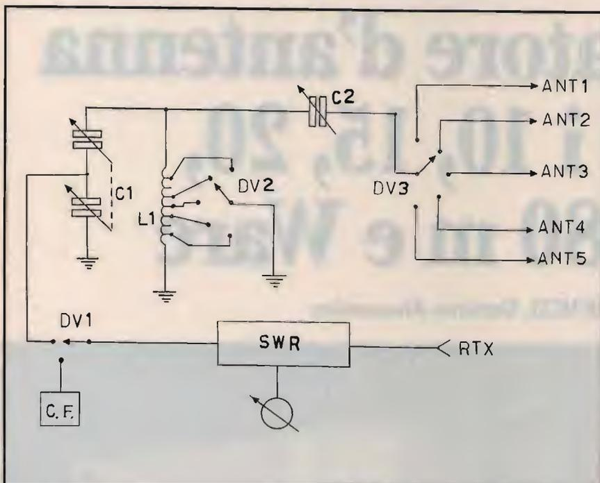
① Schema elettrico dell'accordatore.
