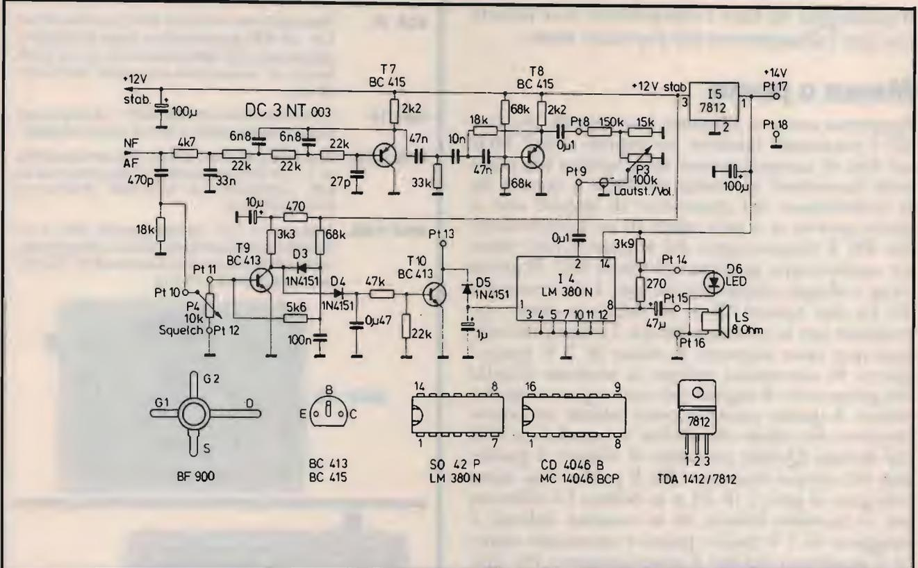
5 Modulo di bassa frequenza del ricevitore VHF.
