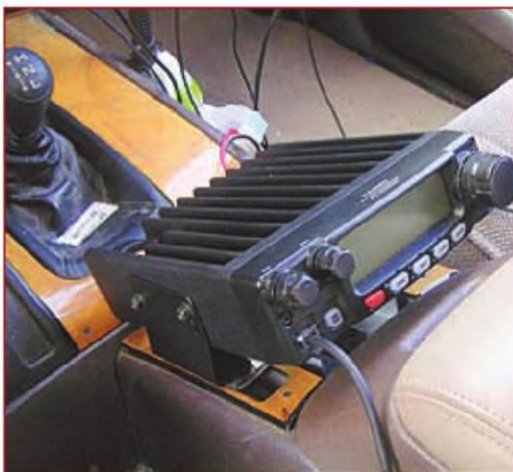
AF6SK muestra su montaje de un equipo en un todoterreno Toyota SUV.
