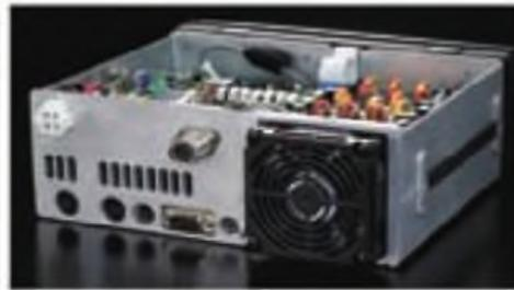
Chasis en fundición de aluminio con ventilador
