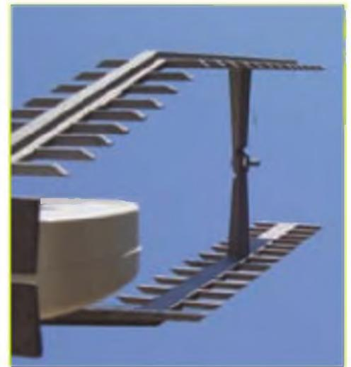
Foto B. Otra vista de las dos antenas Yagi apiladas para 2,4 MHz.
