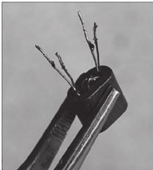
Foto E. Vista del devanado bifilar del transformador T2 sobre un núcleo de ferrita binocular.
