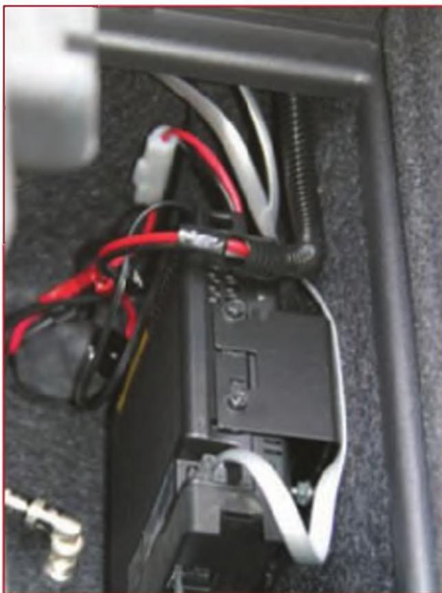
El transceptor Kenwood cabe perfectamente en un compartimiento del maletero posterior. Observa el conector BNC a través del piso.
