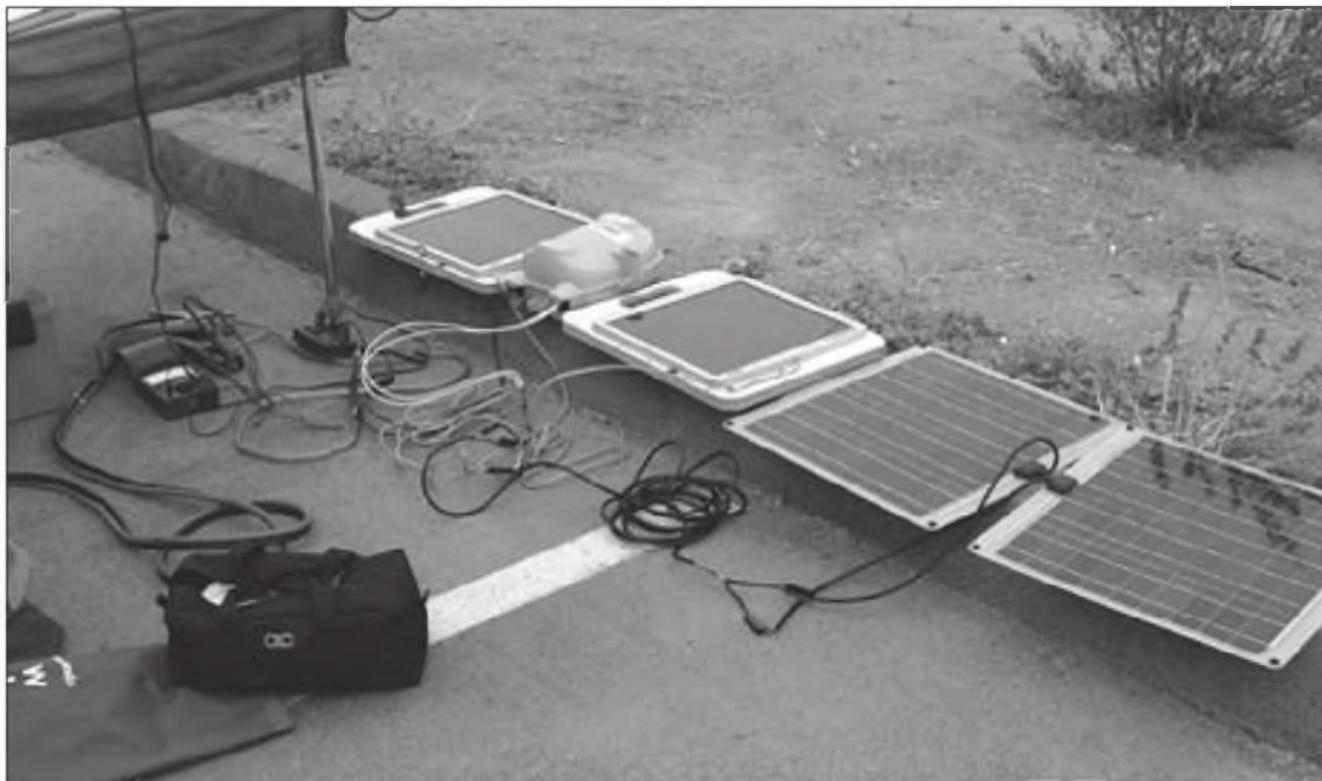
Foto A. Baterías de electrolito gelatinoso y cargadores de paneles solares son las alternativas más prácticas para alimentar nuestros equipos. La mayoría disponen de reguladores de carga y son fáciles de instalar.
