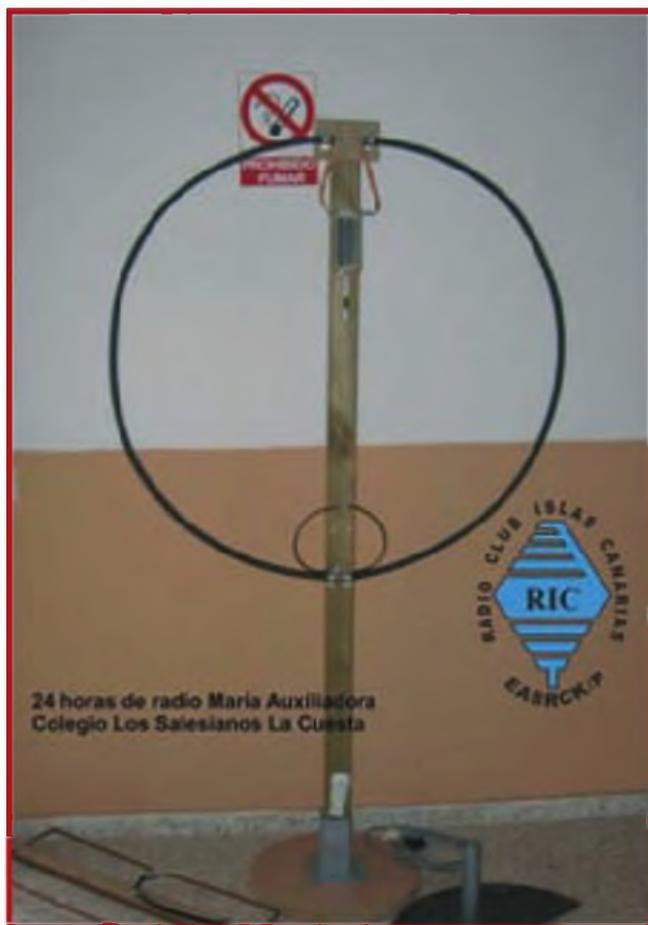
Foto B. Una antena de aro para las bandas decamétricas, como la de la foto, puede mejorar notablemente la recepción de señales en condiciones difíciles por ruido u ORM. (Nota: La señal de prohibición de fumar no tiene relación con la antena, ¡hi!)
