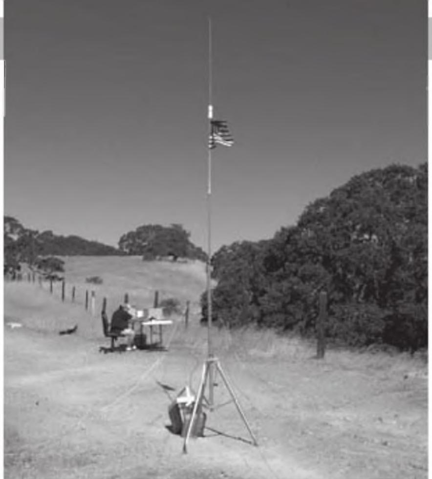
Foto G. Una vista completa de la instalación de la antena Dino-Mite en su trípode (foto de WA6OUW).
