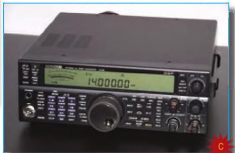
muy poca información del mismo. Pudimos apreciar que la radio ofrece procesamiento digital de la señal, una salida de 100 W con acoplador automático de antena y un receptor a
