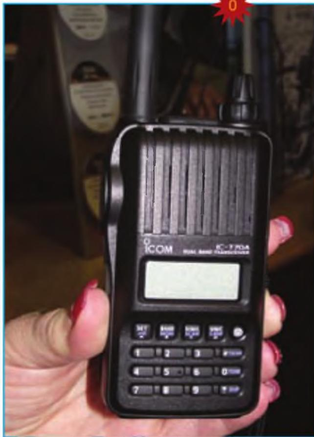
está hecho para entregar 5,5 W de salida de RF y 750 mW de audio, y pesa 330g con una batería NiMH BP-264 y la antena, mientras que el IC-T70 transmite 5 W de RF en ambas bandas de VHF y UHF, pesa 360g con esa misma batería y su antena, mientras produce una salida de audio de 700 mW. Ambas radios están homologadas para cumplir el estándar IP54 de protección contra polvo y resistencia al agua, y también pasan las pruebas de ambiente Mil-Std 810.
