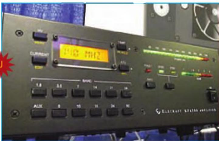
amplificador de estado sólido KPA-500, conmutado a diodos y que opera entre 1,8 y 54 MHz (foto J). Este amplificador tiene selección automática de banda y funciona con cualquier radio de HF. Aún no hay un precio definido, pero
