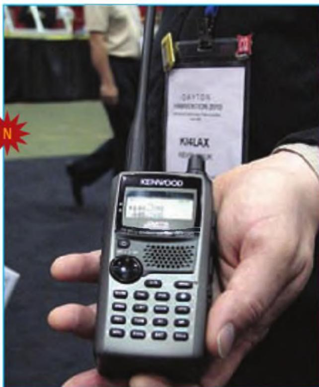
incluye una TNC interna (1200/9600 Bd), tiene capacidades APRS y éste último incorpora un receptor GPS. También, como el TH-D7A, este nuevo equipo funciona con el Skycommand System II+, cuando se le utiliza con radios de la serie TS-2000. El TH-D72 ofrece compatibilidad de memoria con Echolink y viene con un mini-conector USB para mejorar la interfaz con un ordenador.
