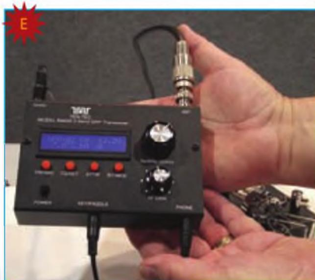
en recepción y entre 550 y 950 mA en TX, dependiendo de la tensión de alimentación. Incorpora un manipulador electrónico con CQ automático e inserción de indicativo para llamada automática, conexión tanto para manipulador vertical como de palas, salida para auricular de 8 ohm y un RIT que permite la sintonía por pasos de 10 o 100 Hz. Cada equipo QRP tiene un precio de venta recomendado de 429 \$US, y podemos obtener más información sobre ellos en <[www.tentec.com](http://www.tentec.com)>.
