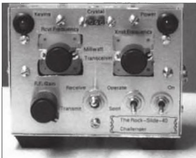
FOTO C. Aquí tienes el Rock-Slide-40 Challenger. Doc ha recortado el panel frontal alrededor de los mandos del condensador para aumentar el margen de frecuencia del VXO.
