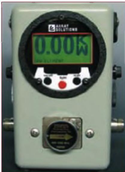
Foto F. Visor digital para vatímetros Bird AS-43A de Array Solutions.
