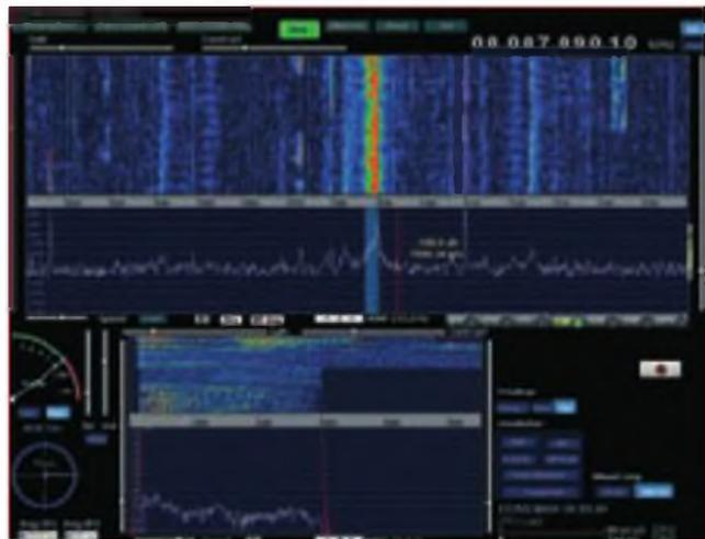
Foto D. Recibiendo en la banda de 40 metros con un SDR-IQ y el programa Winrad. Se está demodulando una fuerte señal de SSB en 7.090; en las ventanas de análisis espectral se observan asimismo otras señales más débiles, algunas de CW, y tanto señales de AM como de SSB por encima de 7.100.
