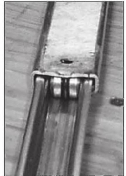
Foto C. Una guía especial de cajón que utiliza ruedecillas y unos anillos de caucho para eliminar cualquier juego del sistema. Este tipo de guía se utiliza para cargas relativamente ligeras. El más mínimo juego en el carril de guía estropeará la precisión de la máquina.
