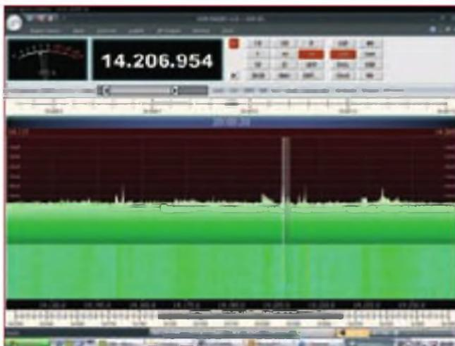
Foto E. Escuchando a A41M0 en la banda de 20 metros en SSB, con un SDR-IQ y el programa SDR-Radio (ver texto).
