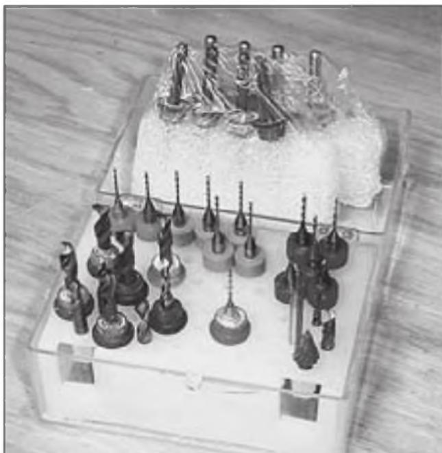
Foto D. Un juego de brocas de acero al carbono. Son todas muy duras y permiten perforar millares de agujeros en una placa tan abrasivas como las de fibra de vidrio-epoxy de los circuitos impresos, pero son muy frágiles y se quiebran fácilmente si se utilizan en un taladro manual.
