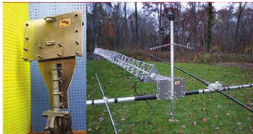
Foto G. Placa basculante para antenas de NN4ZZ.
