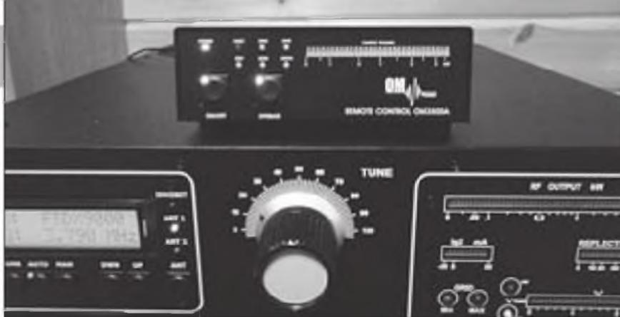
Si el ruido del amplificador y el calor que desprende molesta a los miembros de tu familia cuando operas en casa, una unidad de control remoto es todo lo que necesitas en tu estación. El amplificador puede estar colocado a 10 metros de la estación, conectado por medio de una red local.
