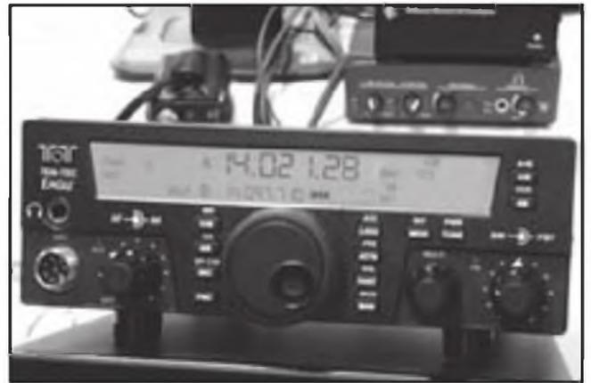
Foto C. The Eagle es el nuevo transceptor de HF +6 m de Ten-Tec, un gran equipo en una pequeña caja
