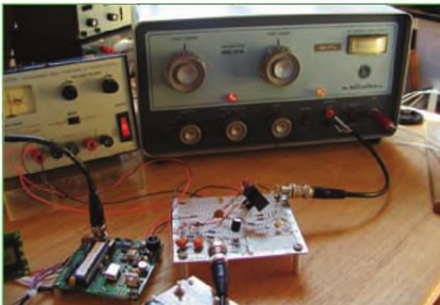
Foto D. La instalación completa de WA1FFL con su sintetizador DDS a la izquierda y el amplificador/excitador en el centro conectado a su transmisor Hallicrafters HT-40.
