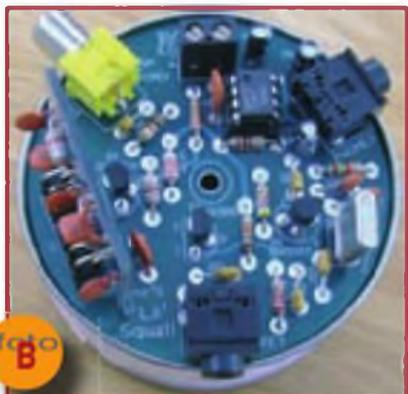
final, el cristal y los condensadores de realimentación del oscilador, y el filtro paso banda es un módulo intercambiable. Incluye un cristal para 7122 kHz, pudiendo adquirirse cuarzos para otras frecuencias por 10 dólares la unidad, o emplear otros cristales que posea el usuario. Su precio: 35 dólares; visitar el sitio web <http://www.qrpme.com>.
