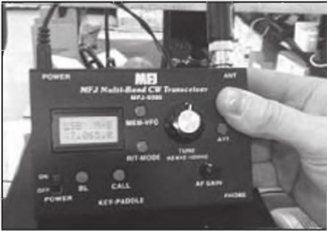
Foto D. MFJ ha presentado el pequeño transceptor monobanda MFJ-9200 al que llama "QR-Pocket" o sea "el QRP de bolsillo". Opera sólo en una banda, pero puedes cambiar los módulos necesarios para cada una.
