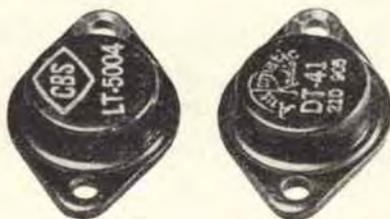
**OMAGGIO NUMERO 7:** Due transistori di potenza. Marche CBS, oppure Radio Receptor co. Modelli: LT-5004, oppure DT41: corrispondenti ai modelli 2N301, 2N307, OC30 ed affini. Usi: ricevitori con forte potenza d'uscita, amplificatori audio, convertitori-elevatori, HI-FI, ecc. ecc.
