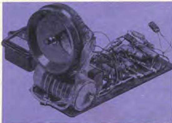
Si noti l'otturatore rotante sopra la grossa pila da 1,5 Volts che alimenta il motorino. L'altra pila che si scorge dietro la predetta è quella da 9 Volts per l'amplificatore.
