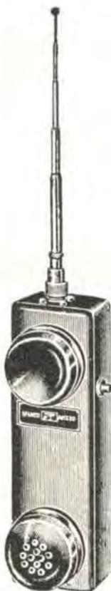
Mod. M 117: « *Messenger* » a transistori, portata ottica mt. 500, nell'abitato portata mt. 200-300, peso kg. 0,600, alim. 2 pile a 9 Volt tipo giapponese.
