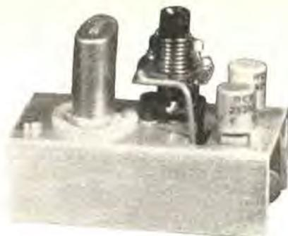
**S**ta volta Vi presento uno strumento che non dovrebbe mancare a nessun appassionato d'elettronica: un generatore di radiofrequenza a cristallo capace di emettere tutta una gamma di segnali su punti fissi, tramite la fondamentale d'oscillazione e tutte le sue armoniche.
