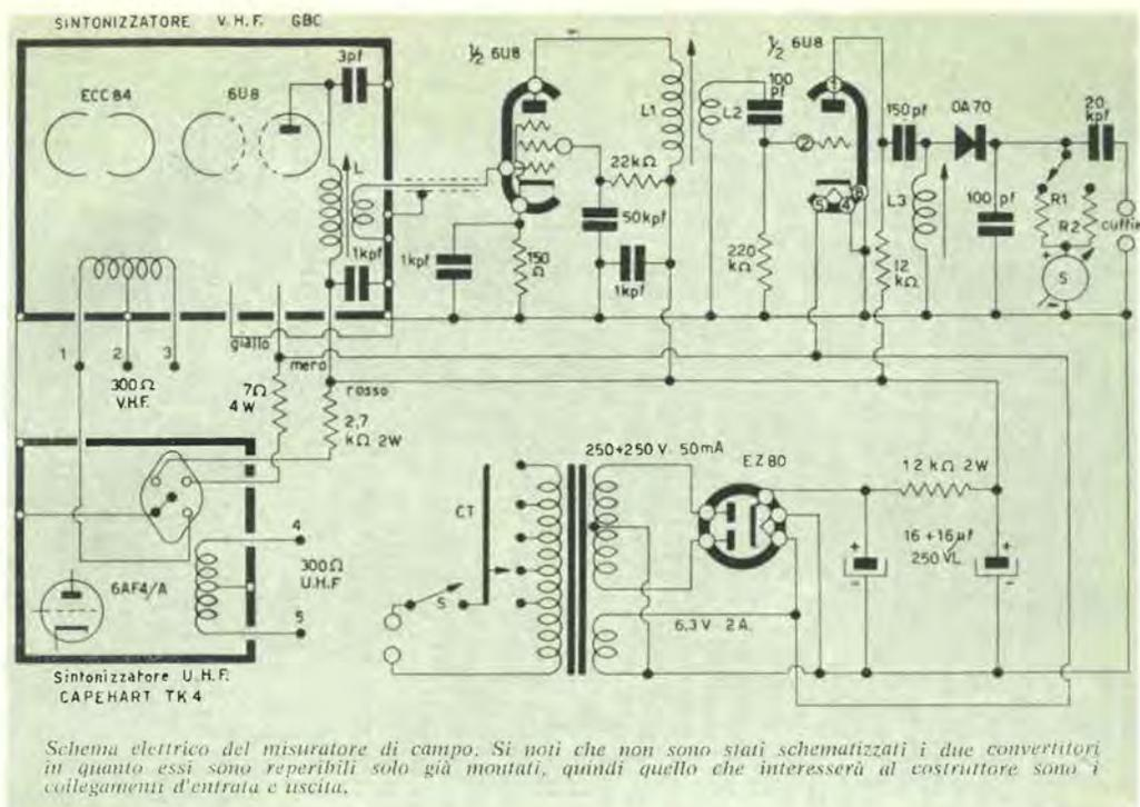
Schema elettrico del misuratore di campo. Si noti che non sono stati schematizzati i due convertitori in quanto essi sono reperibili solo già montati, quindi quello che interesserà al costruttore sono i collegamenti d'entrata e uscita.
