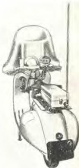
*Ricetrasmittitore PYE/PTC 202 $\frac{1}{2}$  montato su motoscooter "Vespa".*
