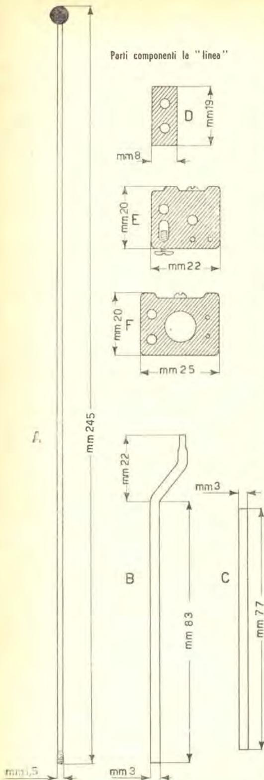
I due segmenti dovranno essere tagliati e sagomati per risultare come nella illustrazione. Il pezzo « B » verrà strozzato all'estremità con una pinza, per ottenere un foro interno di circa 1,5 mm., ove possa essere avvitata l'antenna A.
