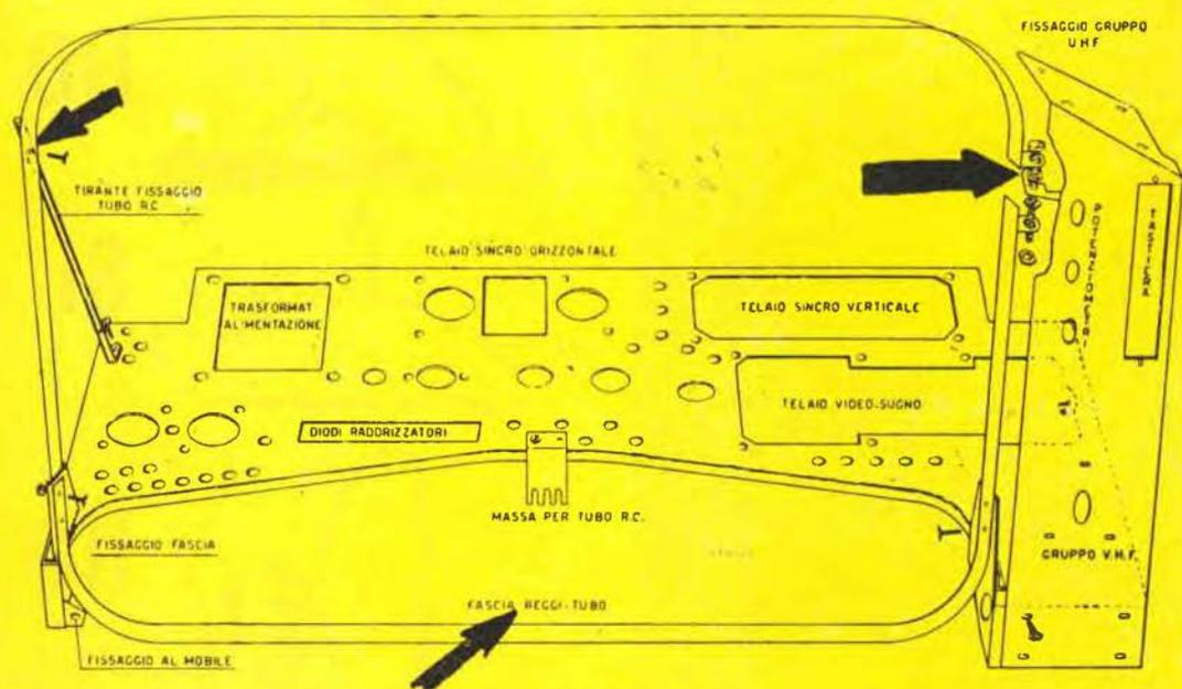
Chassis del televisore: le frecce indicano la fascia reggi-tubo (in basso) la vite che serra la fascia (a destra) ed il tirante che pone in piano il tubo catodico (a sinistra).
