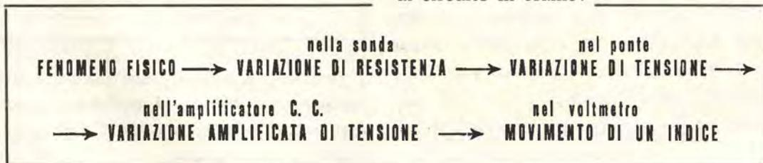
Qui di seguito viene descritta un'applicazione particolare completa di tutto l'apparecchio per rendere palesi le possibilità d'impiego dello stesso, nel caso di rilevamento estremamente sensibilizzato di temperature.
