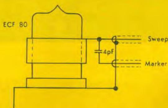
controllo, Marker, va accoppiato allo Sweep tramite un condensatore da 4 o 5 pF, direttamente alla fascetta.
