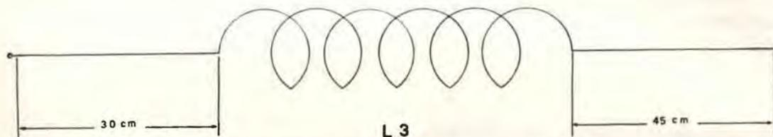
L 3 = 29 spire di filo di rame con doppia copertura di cotone  $\varnothing$  1 mm, avvolte su supporto di 2 cm, diam.
