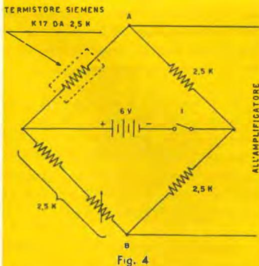
caso, presentano una corrente di fuga con andamento esponenziale nei confronti della temperatura; ciò comporta che un incremento anche lieve della temperatura ambiente provochi una variazione non trascurabile della corrente di collettore del transistor, e se questo si trova all'ingresso di un amplificatore a C.C. la variazione viene amplificata e si presenta all'uscita alterando notevolmente le misurazioni.
