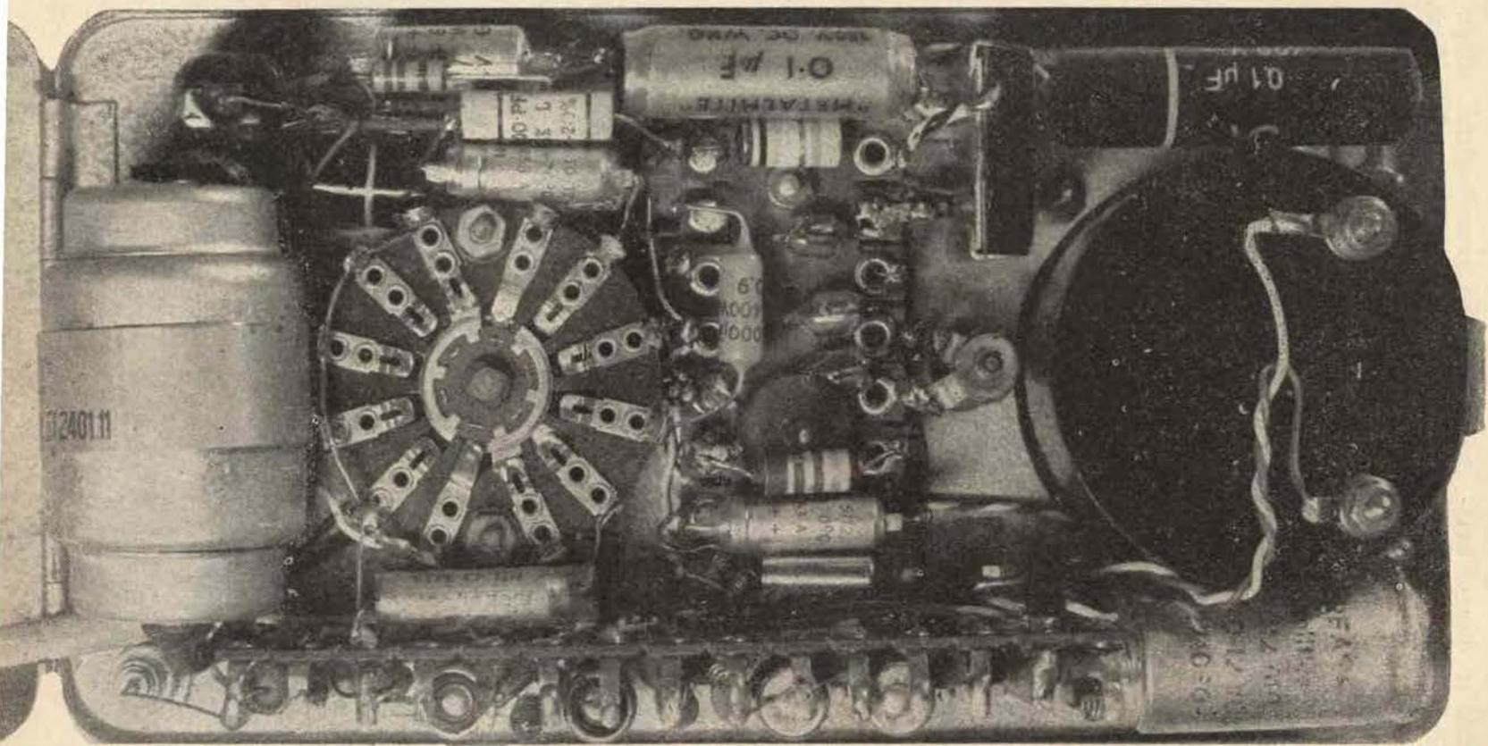
All'interno dell'apparecchio si notano lo strumento, il commutatore e l'ex traslatore ora trasformatore-elevatore.
