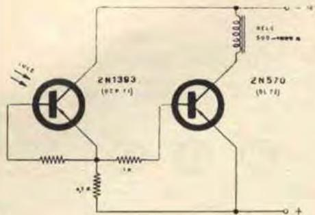
Fotorelé General Transistor.
