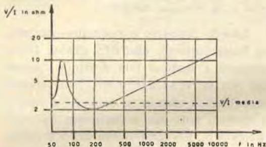
**Andamento della impedenza di una bobina mobile in funzione della frequenza del segnale eccitante. Si noti il picco alla risonanza.**
