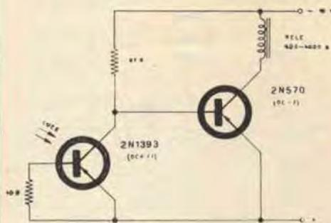
Fotorelé General Transistor.
