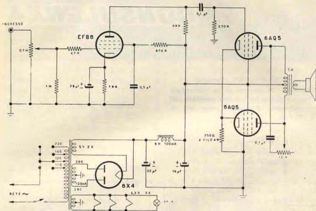
L'amplificatore è un « controfase » di tipo particolare. L'inversione di fase è ottenuta sulla 6AQ5 con la disposizione griglia a massa. La distorsione è molto bassa e non avvertibile a orecchio.
