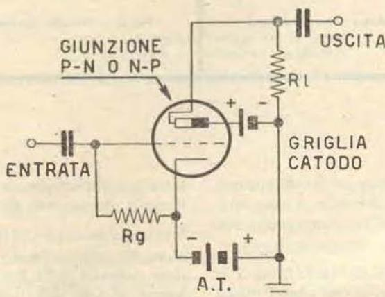
Fig. 1 - Circuito tipico d'impiego d'un SEMITRON
