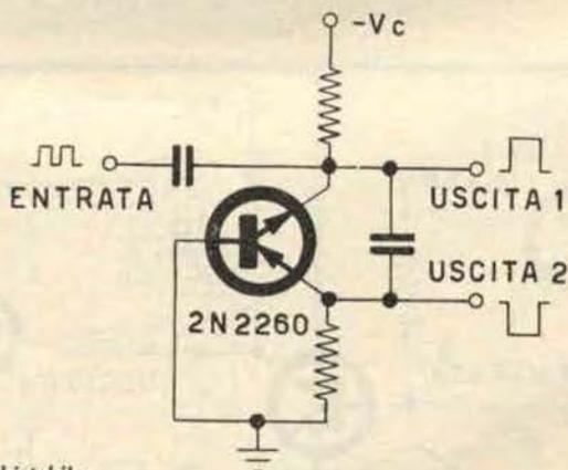
Fig. 5 - Multivibratore bistabile con Dynaquad
