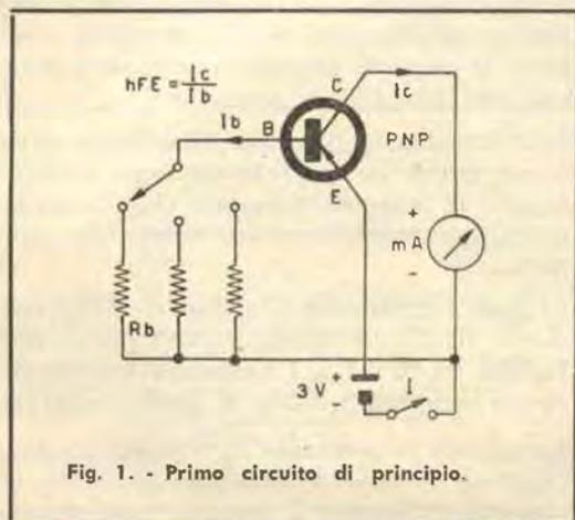
Se la corrente  $I_c$  è abbastanza elevata,  $I_{CEO}$  diventa trascurabile e potrà ritenersi valida la più semplice relazione (1) in precedenza riportata. Ad ogni modo, questa correzione è indispensabile sulle misure di  $h_{FE}$  solo per piccole correnti di collettore.
