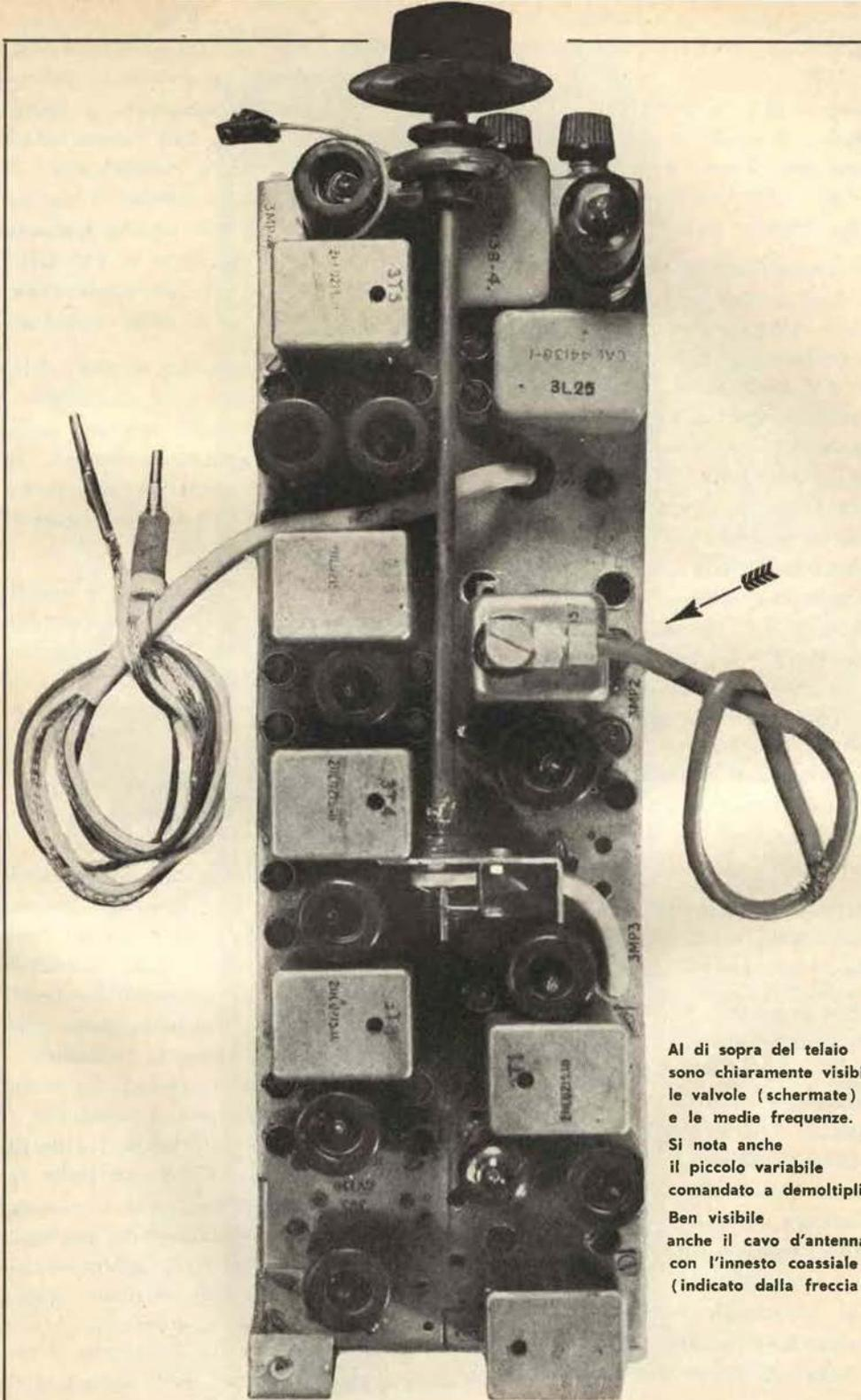
Al di sopra del telaio sono chiaramente visibili le valvole (schermate) e le medie frequenze. Si nota anche il piccolo variabile comandato a demoltiplica. Ben visibile anche il cavo d'antenna con l'innesto coassiale (indicato dalla freccia)
