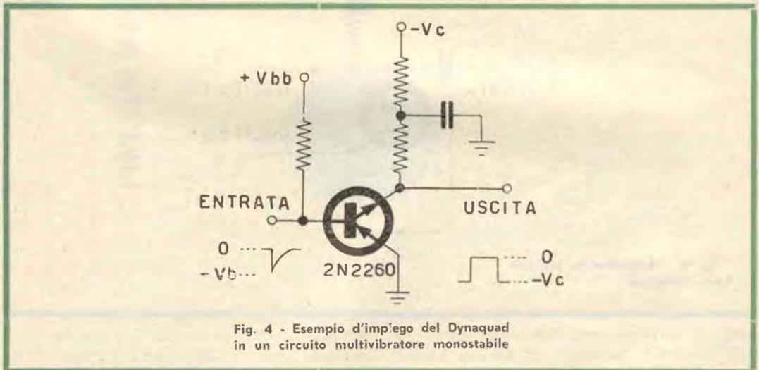
Fig. 4 - Esempio d'impiego del Dynaquad in un circuito multivibratore monostabile
