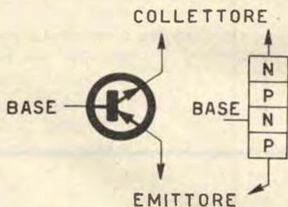
Fig. 2 - Schema e struttura d'un Dynaquad
