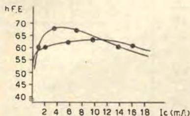
Fig. 5. - Esempio di curve rilevate su due tipi di transistori con lo strumento descritto nell'articolo.
