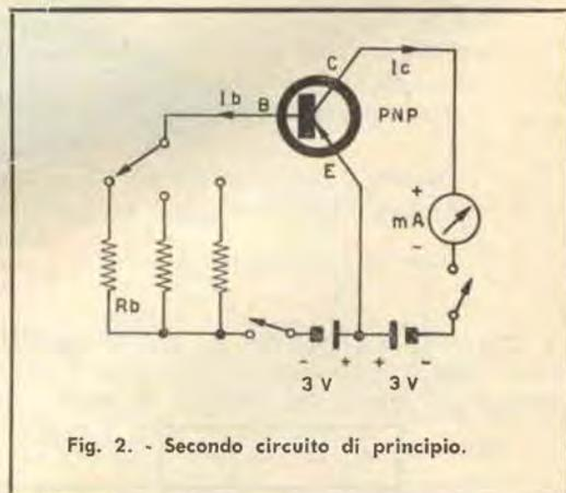
Il secondo (fig. 2) non è che una variante del primo, in cui si sono separate l'alimentazione della base e del collettore impiegando due batterie da tre volt distinte.
