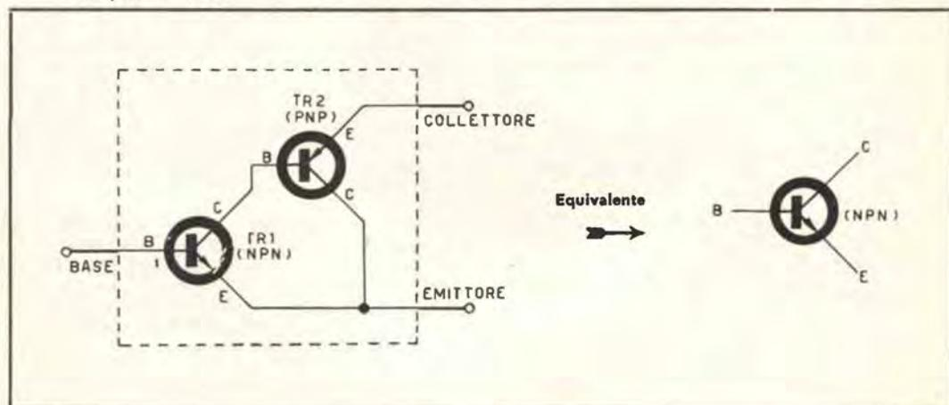
Fig. 2 - Esempi di alcuni transistori NPN composti e relative caratteristiche elettriche risultanti.
