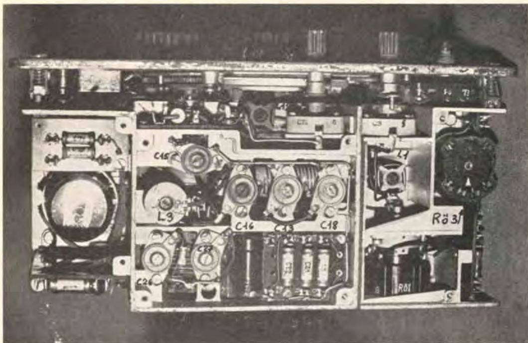
tatti mobili, particolarmente facili a sporcarsi e quindi assai nocivi alle alte frequenze. L'inconveniente è quello di essere a bassa capacità, dato che ogni sezione è il risultato della serie di due condensatori di uguale capacità (e facendo una serie la capacità complessiva si dimezza). I simboli con cui sono rappresentati C73, C24, e C17 nello schema originale e in quelli derivati rispecchiano infatti tale situazione.
