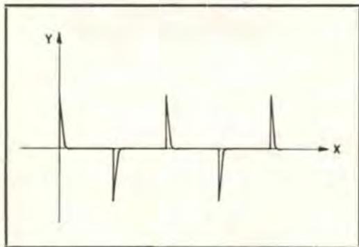
Per poter ottenere impulsi solo positivi o solo negativi si introduce un diodo in parallelo alla resistenza R ed un commutatore che permetta in una posizione di cortocircuitare gli impulsi positivi e nella altra quelli negativi.
