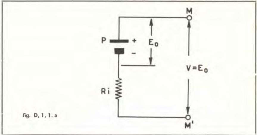
$E_0$  e  $I_{cc}$  sono due elementi caratteristici e COSTANTI che ci permettono di definire il generatore in esame. Che cosa deduciamo allora da questo comportamento? Che poiché  $I_{cc}$  non è infinitamente grande, ci sarà internamente al nostro generatore una resistenza
