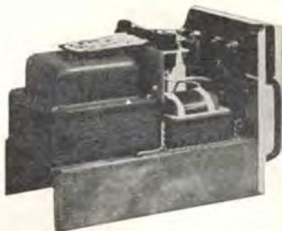
L'apparecchio che Vi presento è un semplice alimentatore-raddrizzatore per carica batterie con uscite in corrente continua e alternata, capace di erogare 4 ampere con tensioni regolabili da 5 a 18 volt circa.
