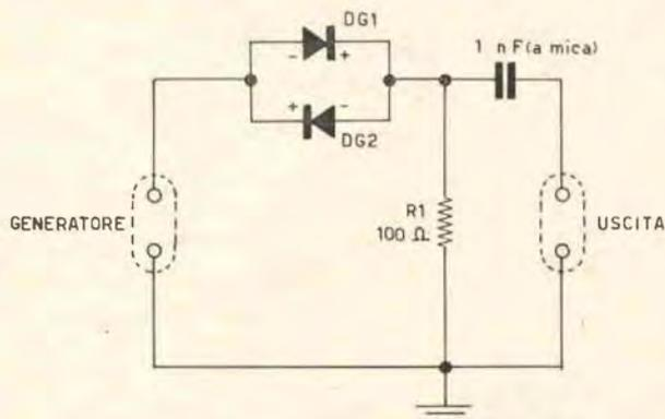
Fig. 1 - Un « intensificatore » delle armoniche.
