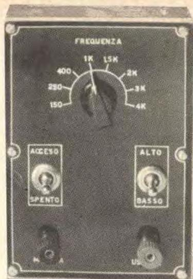
Questo semplice generatore d'onde quadre è bene adatto a controllare il responso di frequenza di amplificatori B.F., siano essi ad alta fedeltà o di tipo più comune. Esso consiste in un oscillatore B.F. a due stadi ad accoppiamento diretto, in cui vengono usati due transistori OC44 oppure OC45.
