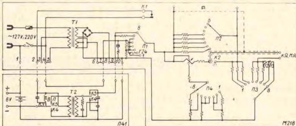
Schema dell'ohmetro M218 con elemento convertitore π41. I commutatori π1 - π4 e i contatti K1, K2 sono comandati da una stessa manopola; il contatto K1 è chiuso nelle posizioni 7 e 8 del commutatore; il contatto K2 è chiuso nelle posizioni 1, 2, 3, 4, 5 del commutatore.
