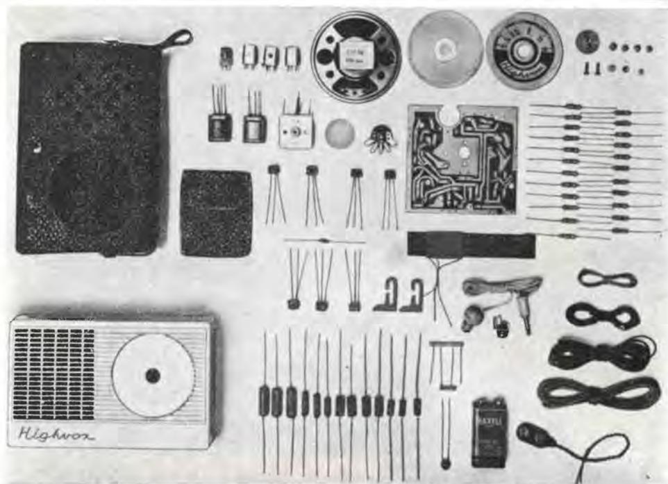
**LA SCATOLA DI MONTAGGIO** per ricevitore a 7 transistori, supereterodina, che si monta col solo aiuto di un saldatore
