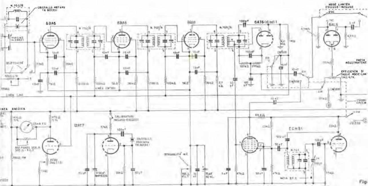
resistenze che devono essere collegate alla linea di quella catodica, al fine di far capo a una banca di accorda per ogni stadi. Per il cablaggio dei singoli stadi, lo si eseguirà eseguendo i collegamenti comuni di alimentazione e delle varie li-
