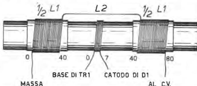
Il « cuore » del piccolo apparecchio: la bobina L1/L2, specificamente progettata e avvolta dall'Autore per la massima resa.
