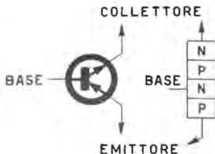
Schema e struttura di un Dynaquad
