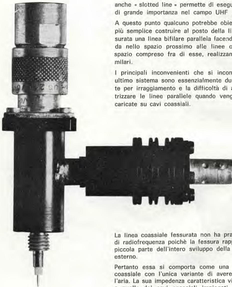
La linea coassiale fessurata non ha praticamente perdite di radiofrequenza poichè la fessura rappresenta solo una piccola parte dell'intero sviluppo della sezione del tubo esterno.
