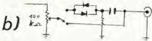
corrispondente alla frequenza del cristallo in circuito, e si può leggere la corrente a R.F., che è dell'ordine di 2-2,5 mA circa (secondo il taglio del quarzo) inviata al microamperometro tramite il diodo rivelatore;
