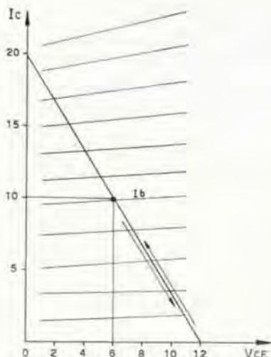
Nella condizione di « interdetto » la Vce del transistor è 12 volt: ecco quindi il primo punto della retta di carico. Il secondo punto sull'asse delle correnti sarà dato dalla corrente massima (di saturazione) che può fluire nel circuito di collettore.
