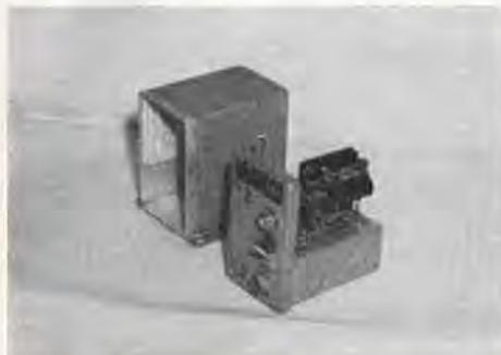
**RADIOCOMANDO TIPO BC 357-H** Costruito dalla ZENIT RADIO CORPORATION U.S.A. Comprendente: un relais sensibilissimo, e regolabile. Compensatori ceramici con bobine (attualmente accordato sulla frequenza di Mc. 50, adatto per radiocomando mancante della sola alimentazione, e valvole Tipo VT153, VT104. Adatto per la realizzazione di ricetrasmittitore, e come radiocomando per svariati usi. Prezzo cad. **L. 4.900.**
