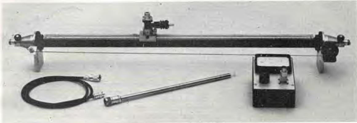
Dall'esame di queste prestazioni è facilmente comprensibile come la linea fessurata coassiale sia in grado di risolvere ogni problema di adattamento di impedenza per il massimo trasferimento di energia a radiofrequenza dal generatore al carico, come nel caso del sistema trasmettitore/antenna, anche per i sistemi più complessi.
