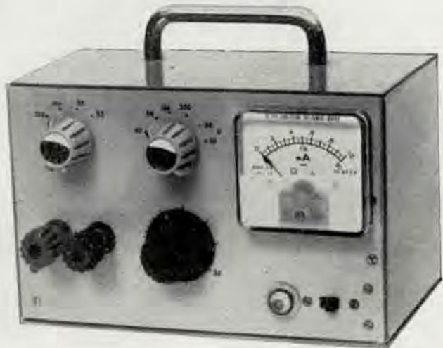
Il secondo avvolgimento ( $30 + 30$  volt c.a.) alimenta il circuito stabilizzatore e lo rende indipendente da quello principale che subisce notevoli variazioni di tensione in funzione dell'erogazione di corrente richiesta.
