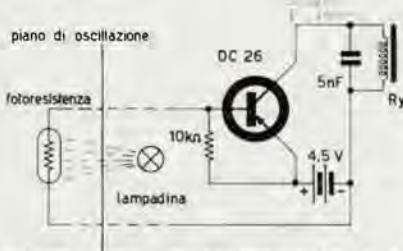
Contatore di oscillazioni del pendolo (Del Bene)
