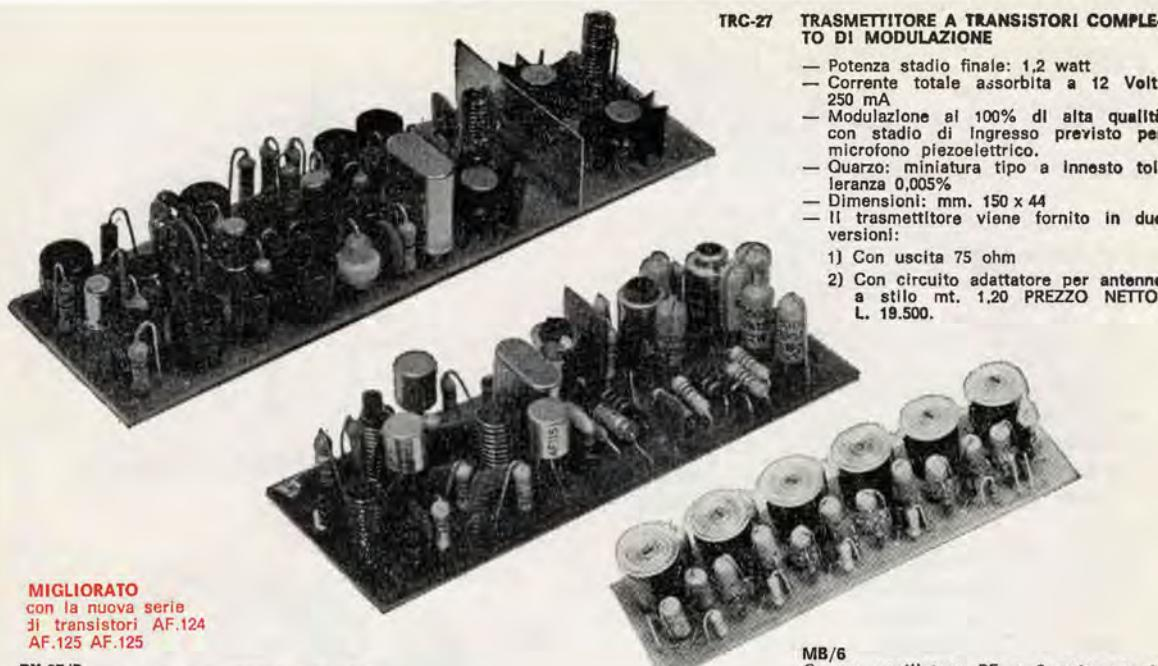
**TRC-27 TRASMETTITORE A TRANSISTORI COMPLETO DI MODULAZIONE**
