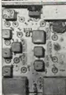
**BC 433=ARN7 - RICEVITORE SUPERETERODINA** - Estrema sensibilità e selettività - Campo di frequenza 100-1450 kHz in 4 gamme: 100-200; 200-410; 410-850; 850-1750 kHz - FI 243,5-142,5 a secondo della gamma. 14 valvole: n. 4 6K7; n. 1 6L7; n. 2 6F6; n. 2 2051; n. 2 655; n. 1 5Z4; n. 1 6SC7; n. 1 655. Alimentazione 28 Vcc 115 Vca 400 Hz. Venduto funzionale nei suoi elementi originali. L. 20.000 senza valvole.
