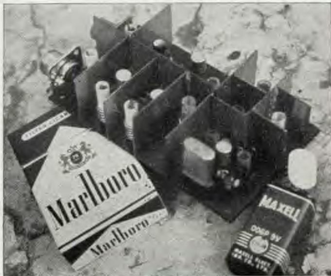
Quarzo oscillante in circuito overtone per un'uscita nella gamma dei 10 metri da 26 ÷ 28 oppure da 28 ÷ 30 a seconda del quarzo usato.
