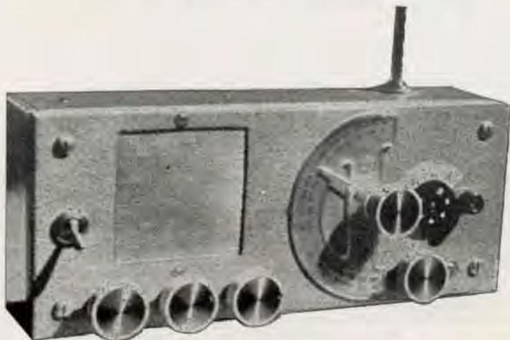
Nella metà di destra del pannello vi è C1-C16 con scala graduata a 180°, C2, C17 (con piccola scala suddivisa in 16 posizioni) e R4. Sotto, ultimo a destra, vi è il comando di C<sub>0</sub>. L'apparecchio è mostrato posteriormente nelle figure 3 e 4.
