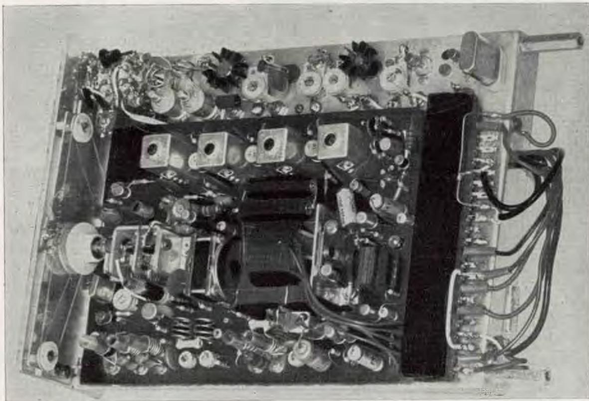
**Squelch:** ruotando verso l'alto il cursore del potenziometro da 20 k $\Omega$  a un certo punto il ricevitore si deve silenziare; verificare che iniettando un segnale il ricevitore si sblocchi, tornando a funzionare. A questo punto, se è stato fatto tutto bene, iniettando all'ingresso 1  $\mu$ V si deve avere in uscita un segnale in grado di sbloccare lo squelch.
