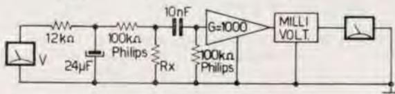
In figura 3 è indicato un possibile schema di misura in cui si è impiegato l'amplificatore a FET seguito dal millivoltmetro in alternata descritto su C.D., marzo 1964, ma si può usare anche un altro strumento o un altro amplificatore seguito da uno strumento indicatore per tensioni alternate.
