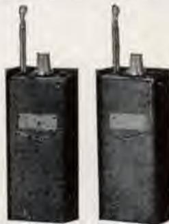
**MKS/05-S:** questi radiotelefon, di semplice montaggio e sicuro affidamento, adottano un particolare circuito che non richiede taratura. Ascolto in altoparlante con forte potenza, deviatore Parla-Ascolta, 4+1 transistor, limitatore automatico dei disturbi, antenna a stilo retrattile di soli cm. 44, mobiletti metallici in acciaio verniciati in grigioverde militare di cm. 14 x 6 x 3,5, controllo di volume, alimentazione comuni batterie da 9 V di lunga durata, GRUPPO AF PREMONTATO AD INNESTO.
