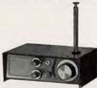
**MKS/07-s:** Ricevitore per VHF di eccezionale sensibilità: copre con continuità la gamma 110-170 MHz, ove permette l'ascolto di Torri di Controllo degli Aeroporti civili e militari, aerei in volo, radioamatori sul 2 metri, Questure, Polizia Stradale, Taxi, ecc. ecc. Circuito esclusivo con stadio amplificatore di AF, rivelatore Superselebbile, nessuna Irradiazione. 7+3 transistor, dispositivo automatico limitatore di disturbi ascolto in altoparlante con 0,6 Watt,
