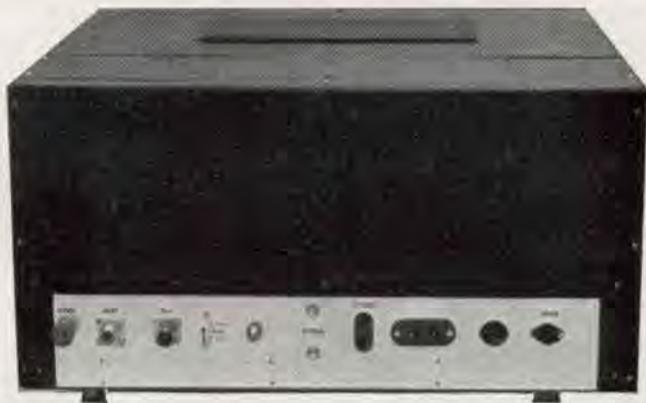
Retro - Da sinistra a destra: presa di terra, antenna, antenna Rx, controllo della tensione di polarizzazione (bias test), potenziometro polarizzazione 807, centraggi tubo 2AP1, stand-by, presa di rete, fusibile e presa altoparlante.
