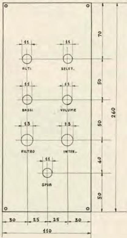
Figura 5 - Piano di foratura del pannello frontale
