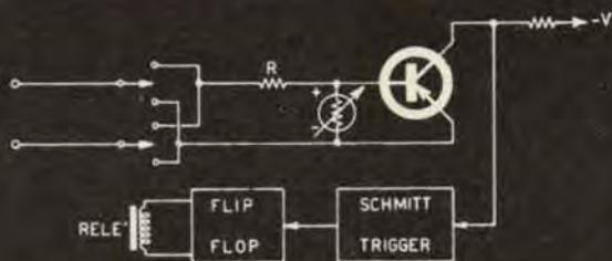
Tutte le volte che si ha un errore di polarità il transistor che segue lo strumento si accende facendo cambiare stato al trigger di Schmitt. Si produce allora un impulso che arriva al flip-flop, che è connesso a un contatore, facendogli cambiare stato, qualunque fosse lo stato precedente. La bobina di eccitazione del relè si trova in serie al collettore di uno dei due transistori del flip-flop.
