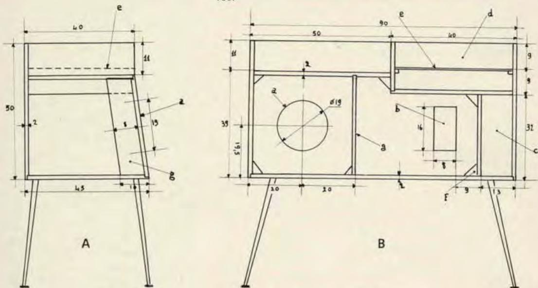
Figura 6 - Particolari costruttivi del mobile — dimensioni in cm:
