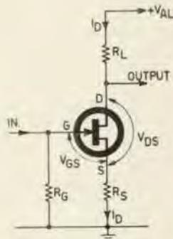
Figura 3 - Polarizzazione automatica.
