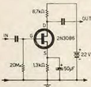
Figura 4 - Esempio pratico di polarizzazione automatica.
