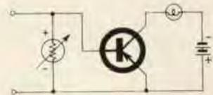
Figura 8 - Protezione e allarme per errori di polarità.
