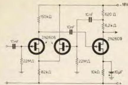
Figura 15 - Amplificatore ad elevata impedenza d'ingresso (Crystalonics)
