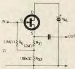
Figura 7 - « Source follower » modificato per max impedenza d'ingresso. Con i valori indicati tra parentesi si ottiene  $Z_i = 10 \text{ M}\Omega$
