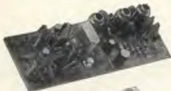
Ricevitore a transistori per la gamma dei 10 metri
