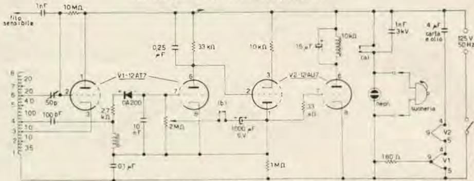
Questo carico fa diminuire due cose insieme e cioè la tensione prodotta dall'oscillatore e la frequenza dello stesso. Perciò la tensione negativa di interdizione al triodo successivo scende notevolmente anche fino a scomparire del tutto, sia perché è scesa la tensione dell'oscillatore che la produce direttamente, sia per l'aumento della reattanza del condensatore da 100 pF che gliela presenta.
