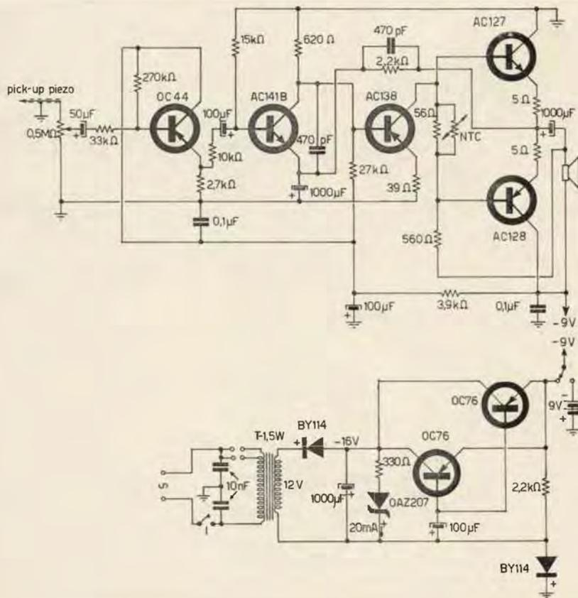
Il diodo BY114 ha la funzione di proteggere l'amplificatore contro eventuali inversioni di polarità nell'inserzione della spina di alimentazione (in quanto l'alimentatore è esterno), fatto molto frequente in quanto le donne sono sì creature deliziose, ma negare completamente per l'elettronica a qualsiasi livello.
