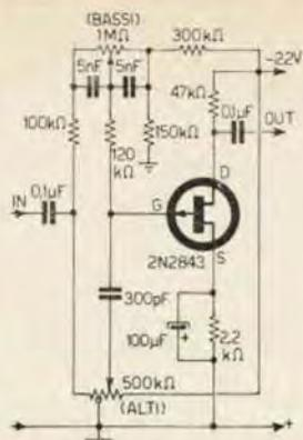
Figura 16 - Controllo di tono HI-FI (Siliconix)
