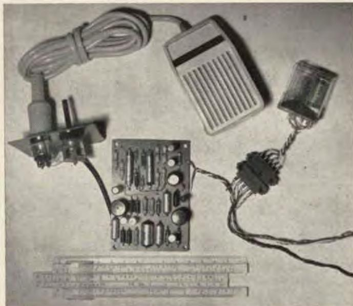
Il fonorelay completo. Il relay è stato collegato al resto dell'apparecchio mediante una spina per comodità. Sulla destra si vedono i fili dei contatti del relay e dell'alimentazione.
