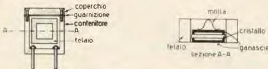
Per aprirli, dopo avere consultato la figura 5, procedete così: svitate completamente le viti nel fondello, e con un giravite forzate tra guarnizione e coperchio, con cautela, così da distaccarla dal coperchio; sfilato quest'ultimo, vedrete il cristallo sospeso a due sottilissimi fili; lo « slice » è molto piccolo e sottile, e le saldature a questi molto delicate, quindi cautela. Le due facce del cristallo sono argentate, e a questo velo di argento sono saldati i reofori.
