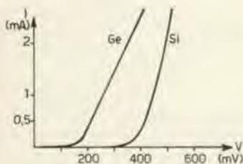
Figura 4 - Caratteristica diretta di diodi per piccoli segnali.
