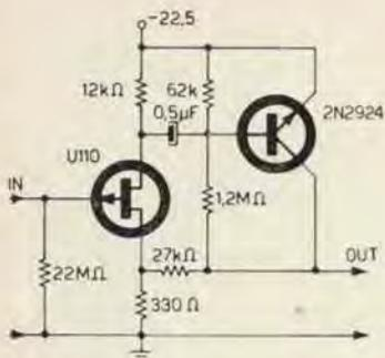
Figura 10 - Preamplificatore per trasduttore a cristallo (bibl.1)
