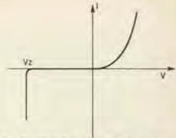
Figura 6 - Caratteristica di un diodo zener.
