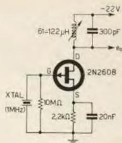
Figura 17 - Oscillatore di Miller servito da TEC (Crystalonics).
