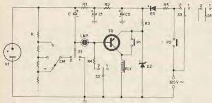
Premendo P2 si dà corrente al timer. Il relè (a 4 scambi, comperato da Fantini Surplus, Bologna) si trova in posizione 1, per cui C si carica attraverso R1 fino a raggiungere la tensione stabilita da V1.
