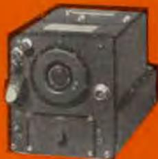
BC-946-B - Versione moderna R.24-ARC5 media frequenza 239 Kc - Freq. da 520 a 1500 Kc adatto per conversioni o per ricevere tutte le onde medie. Impiega n. 6 valvole. Viene venduto privo di alimentazione. L. 30.000
