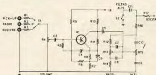
Figura 1 - Il preamplificatore
