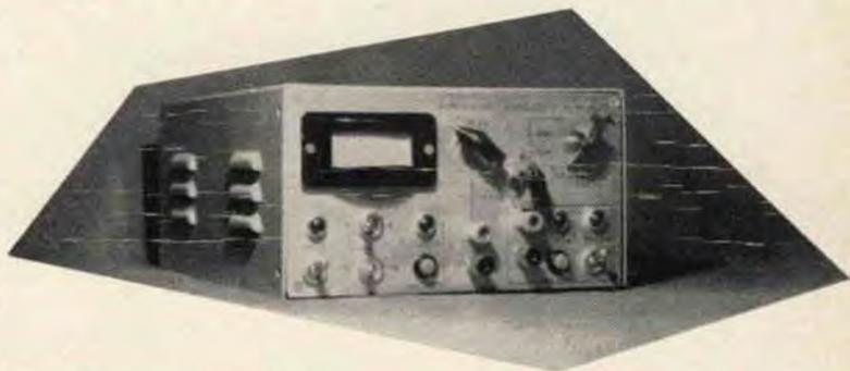
Le misure di stabilizzazione sono state effettuate ponendo la tensione di uscita a 1 V a vuoto e inserendo una resistenza da  $0,67 \Omega$  in modo da assorbire 1,5 A e in tali condizioni la tensione è scesa solo a 0,9 V. La stessa misura è stata eseguita a 25 V, su una resistenza da  $16,7 \Omega$ , ottenendo un abbassamento della tensione fino a 22,5 V. Uscita secondaria stabilizzata a 9 V costanti, anch'essa protetta contro i sovraccarichi con soglia di scatto a 0,5 A.
