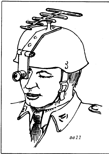
Fig. 1. Deze Zwitserse militair draagt op zijn helm een minuscule beam die niettemin werkt in de band 60...70 MHz. De sterke verkorting van de antenne-elementen is bereikt door deze te omhullen met water dat een relatieve diëlektrische constante van 80 heeft. Dat resulteert in een verkortingsfactor voor de elementen van bijna negen maal!
