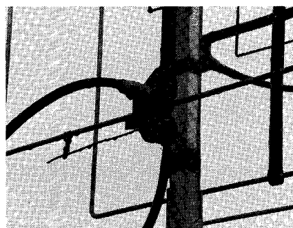
Foto 4. De straler met gamma-match voor 2 m. De druppeltjes jachtlak hangen er aan.
