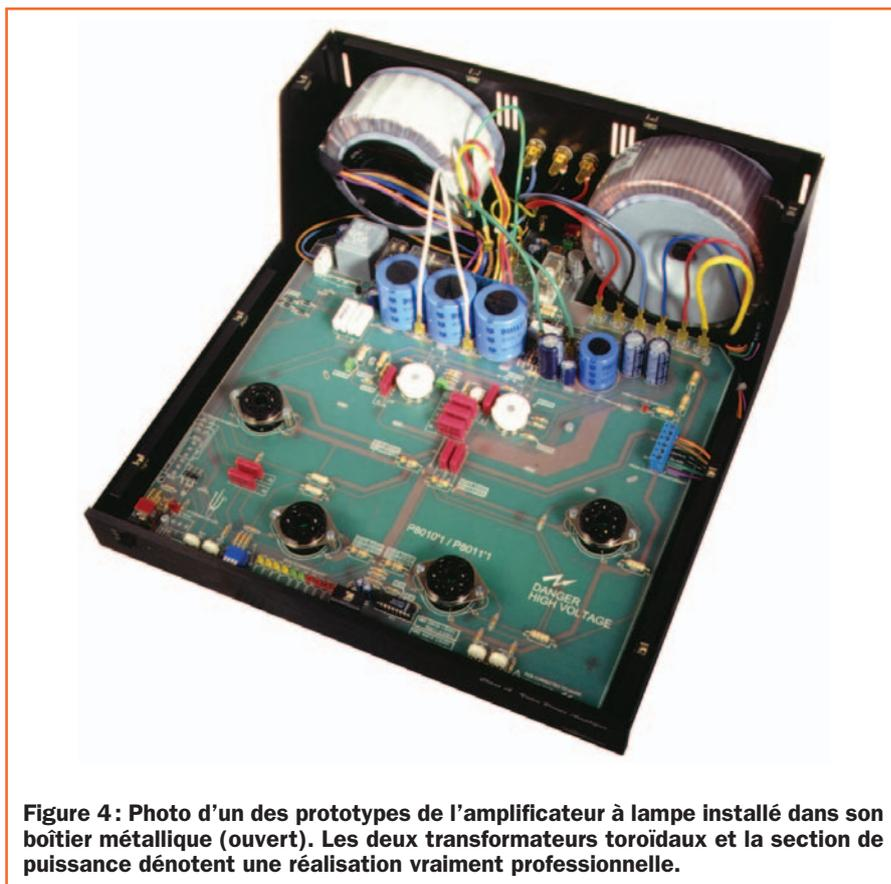
Figure 4: Photo d'un des prototypes de l'amplificateur à lampe installé dans son boîtier métallique (ouvert). Les deux transformateurs toroidaux et la section de puissance dénotent une réalisation vraiment professionnelle.
