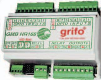
Le **GMB HR168** est fondamentalement un module à Barre DIN en mesure d'accueillir une CPU **grifo** **Mini-Module** du type **GMM** à 40 broches. Elle dispose de 16 entrées Galvaniquement isolées pour les signaux **NPN** ou **PNP**; 8 Relais de 5
