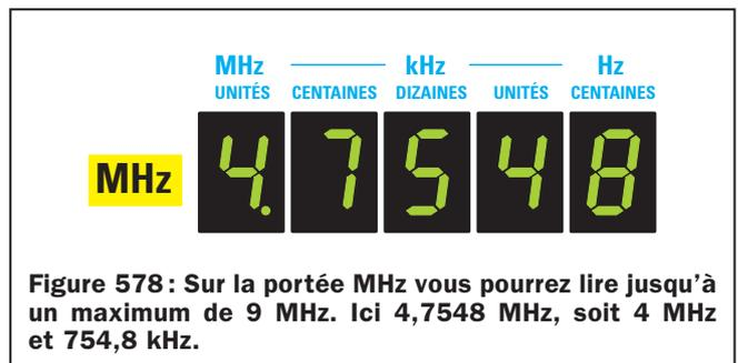
Figure 578 : Sur la portée MHz vous pourrez lire jusqu'à un maximum de 9 MHz. Ici 4,7548 MHz, soit 4 MHz et 754,8 kHz.
