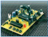
Cet appareil permet d'enregistrer et de reproduire numériquement un message d'une durée maximale de huit minutes. Toutes les fonctions (REC, PLAY, STOP) sont commandées par trois poussoirs situés sur la platine. Le circuit peut être piloté de l'extérieur grâce à un connecteur barrette.
