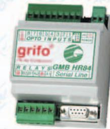
Le **GMB HR84** est fondamentalement un module à Barre DIN en mesure d'accueillir une CPU **grifo** **Mini-Module** du type **CAN** ou **GMM** à 28 broches. Elle dispose de 8 entrées Galvaniquement isolées pour les signaux **NPN** ou **PNP**; 4 Relais de 5 A; ligne RS 232, RS 422, RS 485 ou Boucle de Courant; ligne **CAN**; diverses lignes TTL et un alimentateur stabilisé.
