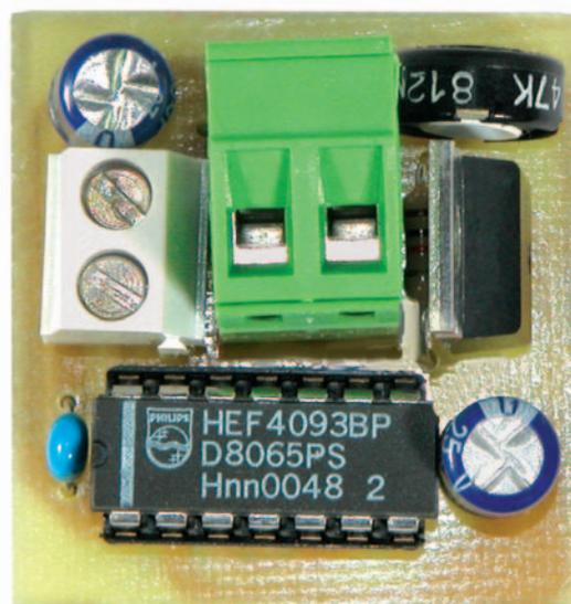
**Figure 3 : Photo d'un des prototypes de la platine du clignoteur halogène.**
