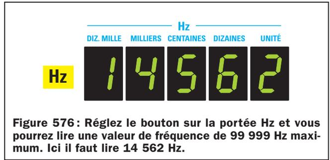
Figure 576 : Réglez le bouton sur la portée Hz et vous pourrez lire une valeur de fréquence de 99 999 Hz maximum. Ici il faut lire 14 562 Hz.
