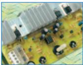
Grâce à un régulateur PWM, cette platine permet de doser très précisément l'énergie fournie (et donc la vitesse de rotation de l'axe) à un moteur électrique, aussi bien à vide qu'en charge. L'adoption d'un MOSFET spécial avec capteur intégré permet de suspendre la fourniture de courant quand le moteur consomme trop.
