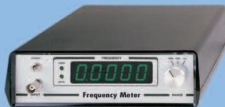
Pour connaître la valeur exacte d'une fréquence en hertz (Hz), kilohertz (kHz) ou mégahertz (MHz), vous devez abandonner les divers fréquencemètres analogiques et vous tourner vers les fréquencemètres numériques. S'ils sont plus coûteux, ils permettent, en contrepartie, de visualiser sur leur afficheur, la fréquence précise exprimée par un nombre.
