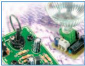
Si vous voulez vous faire remarquer (ce n'est pas toujours vain: en pleine nuit sur une route par exemple...), voici deux types de clignoteurs/balises de détresse, basse tension, fonctionnant, le premier, avec une ampoule halogène à réflecteur intégré et, le second, avec des LED blanches à haute luminosité.
