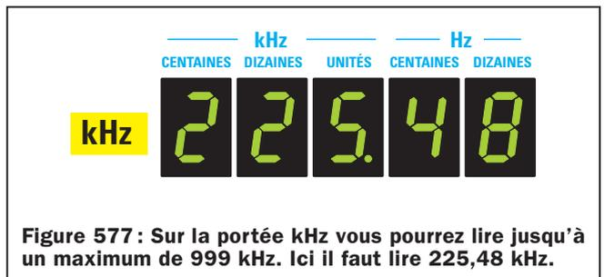
Figure 577 : Sur la portée kHz vous pourrez lire jusqu'à un maximum de 999 kHz. Ici il faut lire 225,48 kHz.
