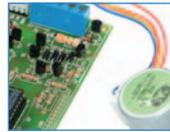
Ce contrôleur pour moteurs pas à pas, permettant de piloter des moteurs unipolaires ou bipolaires, dispose d'une ligne bus I2C gérant le moteur, au moyen d'une interface externe, par voie logicielle et PC. Il est possible en outre d'effectuer un contrôle manuel grâce à deux poussoirs permettant de modifier la position de l'axe du moteur.
