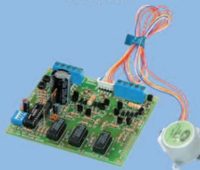
Ce contrôleur pour moteurs pas à pas, permettant de piloter des moteurs unipolaires ou bipolaires, dispose d'une ligne bus I2C gérant le moteur, au moyen d'une interface externe, par voie logicielle et PC. Il est possible en outre d'effectuer un contrôle manuel grâce à deux poussoirs permettant de modifier la position de l'axe du moteur.
