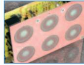
Ce pavé de six poussoirs à effleurement est doté de six sorties à relais pouvant fonctionner en mode impulsif ou en mode bistable. Chaque touche détecte la variation de capacité due au contact ou à la proximité immédiate d'un doigt et, si elle est activée, une LED située à l'arrière s'allume pour confirmer le déclenchement.
