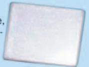
Cette antenne directive patch offre un gain de 8,5 dB. Elle s'utilise en réception aussi bien qu'en émission et permet d'augmenter considérablement la portée des dispositifs RTX travaillant sur des fréquences. Ouverture angulaire : 70° (horizontale), 65° (verticale). Gain : 8,5 dB. Câble de connexion : RG58. Connecteur : SMA. Impédance : 50 Ω. Dim. : 54 x 120 x 123 mm. Poids : 260 g.
