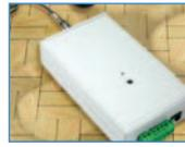
Relié à une ligne fixe, cet appareil permet d'écouter discrètement et à distance sur un téléphone mobile GSM toutes les conversations téléphoniques. Le circuit est également doté d'un microphone pour écoute locale dissimulée, d'une entrée auxiliaire et d'une sortie supplémentaire à relais. L'appareil utilise le module GSM GR47, une évolution du fameux GM47.
