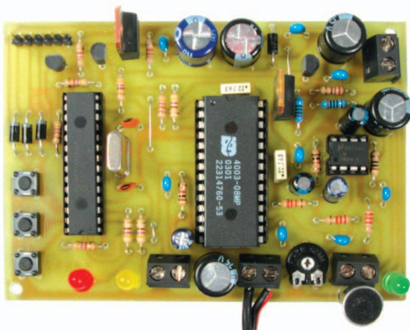
Figure 4 : Photo d'un des prototypes de la platine de l'enregistreur/reproducteur numérique.
