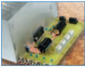
Cet étage final audio de puissance pour autoradio très compact utilise un seul circuit intégré et fournit pourtant 55 W sur chacun des quatre canaux (deux "avant" droite et gauche, deux "arrière" droite et gauche). Il possède les fonctions "standby" et "mute" et on peut le coupler à des enceintes ou haut-parleurs de 2 et 4 ohms d'impédance.
