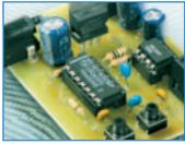
Cette petite platine peut être utilisée pour régler le volume d'un amplificateur audio, la tension de sortie d'une alimentation variable, la durée d'une temporisation, etc. Le rapport entrée/sortie peut être modifié en agissant sur deux poussoirs ou bien, avec des niveaux logiques adéquats, sur les entrées de contrôle, ce qui permet de le commander à distance.
