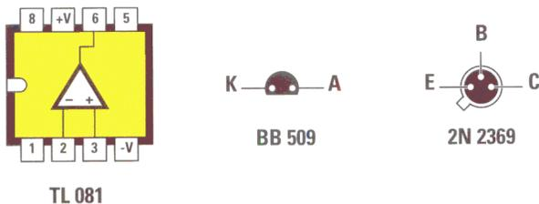
Figure 4 : Brochages du circuit intégré amplificateur opérationnel TL081 vu de dessus, de la diode varicap BB509 et du transistor 2N2369 vus de dessus.
