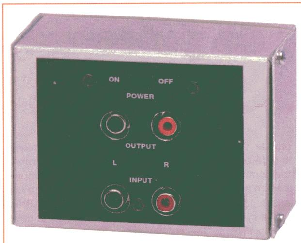
**Figure 17 :** Photo d'un des prototypes du préamplificateur RIAA stéréo EN1706 monté dans son boîtier métallique. La face avant est dotée d'un film adhésif noir sérigraphié.
