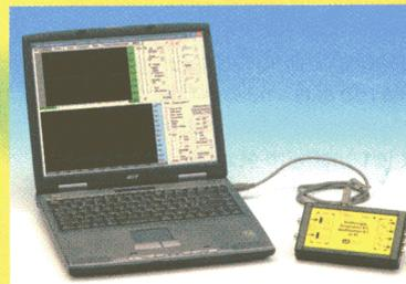
Posséder un oscilloscope et un analyseur de spectre est le rêve de tout amateur d'électronique ... mais cela coûte des fortunes ! Eh bien pas tant que cela avec le circuit d'interface USB pour ordinateur que ce kit vous propose de construire et le logiciel Visual Analyzer. Vous disposerez ainsi bientôt d'un oscilloscope à deux voies et d'un analyseur de spectre capable de travailler entre 10 Hz et 20 KHz ; en plus vous aurez un fréquencemètre numérique de précision et un générateur BF. Tout cela
