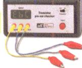
Ce kit va vous permettre de repérer les broches E, B, C d'un transistor et de savoir si c'est un NPN ou un PNP. Si celui-ci est défectueux vous lirez sur l'afficheur "bAd". Alimentation: pile de 9 V (non fournie).
