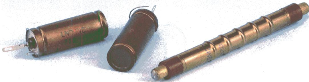
Figure 1 : Pour ce nouveau compteur Geiger nous avons adopté le tube LND712, sensible aux radiations alpha, bêta et gamma ; il comporte une fenêtre de mica. De construction américaine, il est largement distribué de par le monde. Si vous voulez utiliser le tube du compteur Geiger précédent, le SBM20, sensible seulement aux radiations bêta et gamma et de fabrication russe, vous pourriez le faire car le boîtier du nouveau compteur Geiger a été prévu pour le recevoir aussi.
