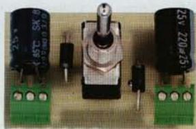
Figure 3 : Photo d'un des prototypes de la platine du chargeur de batteries à dynamo EN1740. La fixation se fait au moyen de l'écrou large et plat de l'inverseur S1, comme le montre la figure 4.
