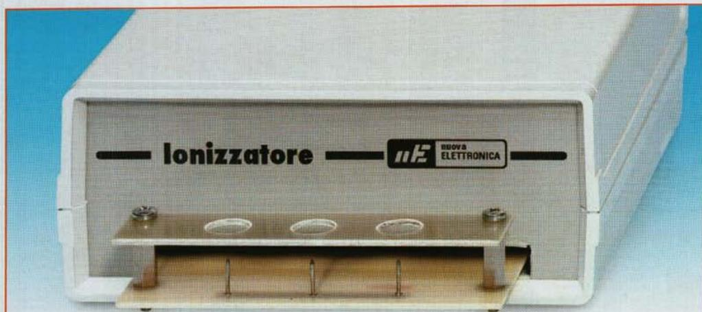
Figure 10 : Photo d'un des prototypes de la platine EN1736 où l'on voit comment est fixé le petit circuit imprimé de la figure 8 sur le circuit imprimé de base, avec deux entretoises hexagonales métalliques. La face avant en aluminium est disponible percée et sérigraphiée pour laisser sortir le circuit imprimé principal et ses trois aiguilles.
