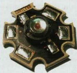
Les LED avec contacts en étoile peuvent être facilement montées en groupement, en les soudant l'une contre l'autre.
