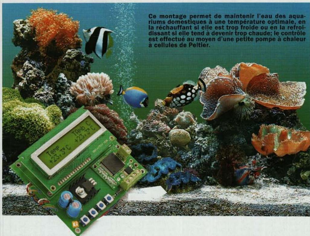
Ce montage permet de maintenir l'eau des aquariums domestiques à une température optimale, en la réchauffant si elle est trop froide ou en la refroidissant si elle tend à devenir trop chaude; le contrôle est effectué au moyen d'une petite pompe à chaleur à cellules de Peltier.
