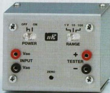
Figure 11 : Vous devez installer la platine dans un boîtier métallique afin de le blinder, sinon le circuit pourrait être perturbé par le secteur 50 Hz. L'inverseur Power visible à gauche, est celui de mise en marche; l'inverseur Range sert à modifier la portée fond d'échelle.
