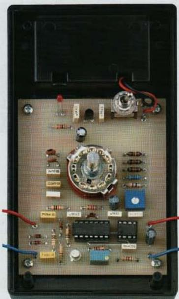
Figure 12 : Après avoir inséré dans le circuit imprimé tous les composants requis, vous pouvez fixer la platine à l'intérieur du boîtier plastique à l'aide des 4 vis autotaraudeuses.
