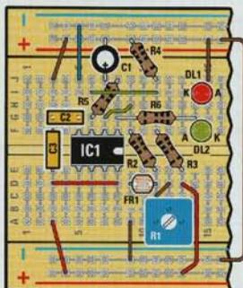
Figure 18 : Maintenant complétez le circuit avec les liaisons indiquées par la figure, en ayant soin de bien dénuder les extrémités des fils avant de les insérer à fond dans les trous de la plaque, de façon à réalliser de bons contacts. Nous vous recommandons de soigner particulièrement cet aspect de la réalisation.
