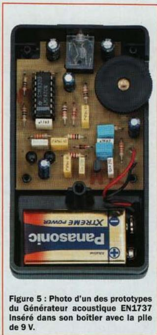
Figure 5 : Photo d'un des prototypes du Générateur acoustique EN1737 inséré dans son boîtier avec la pile de 9 V.
