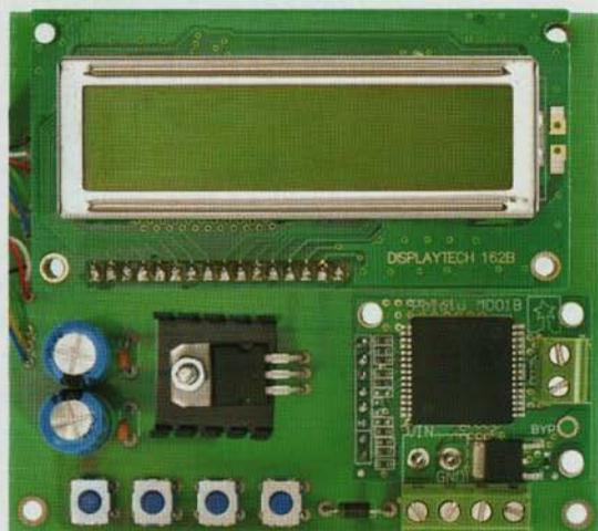
Figure 4a: Photo d'un des prototypes de la platine de commande de la pompe à chaleur à cellules de Peltier ET785.
