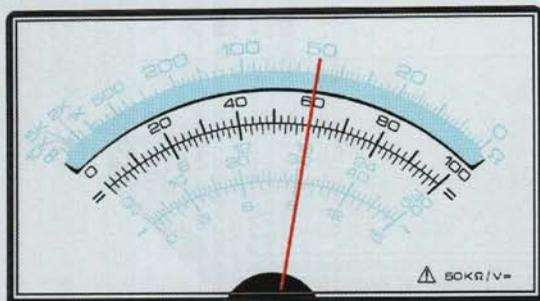
Figure 9 : Sur le cadran du multimètre vous avez plusieurs échelles graduées ; pour obtenir une lecture simplifiée nous conseillons de prendre l'échelle graduée de 0 à 100.
