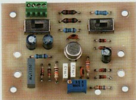
Figure 10 : Photo d'un des prototypes de la platine de l'adaptateur de mesure EN1735. Après essai, nous avons modifié le circuit en déplaçant seulement la position de la résistance R1.
