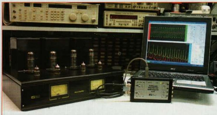
Figure 1 : Si vous désirez effectuer la mesure de la distorsion harmonique d'un amplificateur audio, il suffit d'installer sur votre PC la nouvelle version VA THD du logiciel Visual Analyser et de relier au port USB la platine EN1690. Au-delà de la mesure du pourcentage de THD de l'amplificateur, vous pourrez ainsi observer à l'écran toutes les harmoniques qui contribuent à la distorsion.
