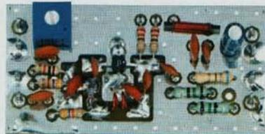
Figure 9 : Photos des prototypes des platines du Générateur VHF EN1738 et du VFO modulé en FM EN1739 prêtes à être installées dans leurs boîtiers métalliques.
