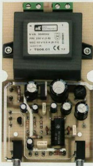
Figure 5 : Photo d'un des prototypes de la platine de l'interphone.
