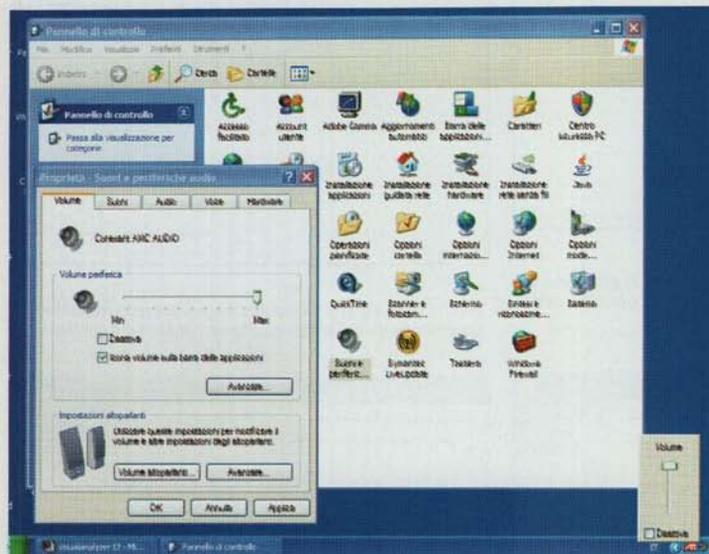
h- Si le signal du générateur BF n'apparaît pas à l'écran, vérifiez que les pilotes (drivers) audio de la carte sont bien installés correctement. Pour cela cliquez sur Démarrer - Paramètres - Panneau de configuration. Cliquez sur l'icône «Sons et périphériques» et dans la fenêtre du Volume vérifiez qu'apparaît bien la mention «Conexant AMC AUDIO». Dans le cas contraire cliquez sur le menu et sélectionnez-la.
