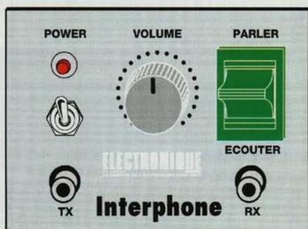
Figure 6 : En face avant du boîtier on insère le double Inverseur S1 de Parler ou Ecouter, le bouton de Volume, la LED et l'interrupteur S2 Power. Les deux trous marqués TX et RX servent à insérer par derrière les jacks femelles desservant les enceintes acoustiques.
