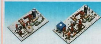
il suffira de bobiner sur un **diamètre de 7 mm 8 spires** jointives, puis de les espacer jusqu'à obtenir un solénoïde d'une **longueur de 6 mm** exactement (voir figure 4). Avant de souder la **self L1** sur le circuit imprimé, **raclez** les extrémités des deux fils de manière à enlever l'**émail isolant**, puis étamez ces bouts de manière à préparer l'insertion et la soudure sur les pistes.
