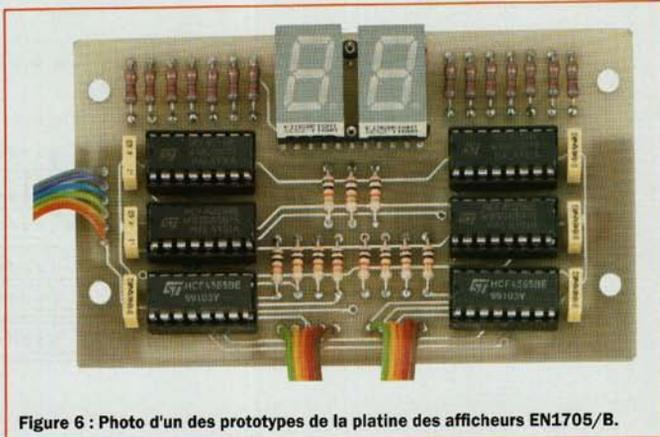
Figure 6 : Photo d'un des prototypes de la platine des afficheurs EN1705/B.
