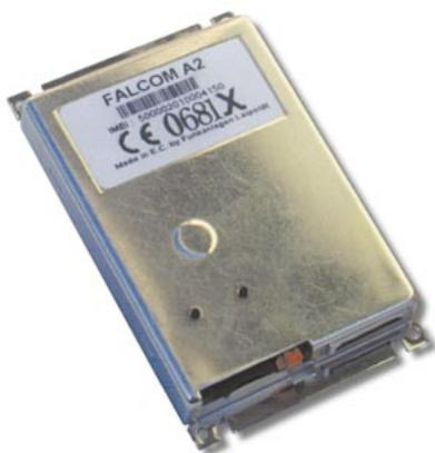
Le système d'arrêt moteur pour jet-ski utilise un module GSM Falcom A2 dont les dimensions sont particulièrement réduites malgré la présence d'un emplacement pour la carte SIM. Le A2 dispose de deux connecteurs, de 15 et de 40 broches, pour la connexion avec des circuits extérieurs. Etant donné le nombre limité de fonctions nécessaires dans ce projet, nous avons utilisé exclusivement les lignes disponibles sur le connecteur 15 broches (voir photo de droite).
