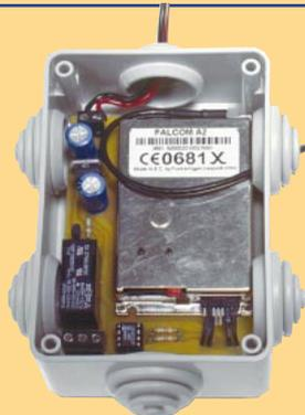
Permet d'actionner un relais via un téléphone portable. Très pratique pour les systèmes embarqués (voitures, avions, bateaux). Un simple appel téléphonique gratuit permet d'activer ou de désactiver le relais. Le kit ne comprend que le module FALCOM A2 et sa connectique.
