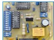
Voici un récepteur monocanal sur 433 MHz, muni d'un relais de sortie, utilisable avec les télécommandes standards de type MM53200. L'étage de réception est très innovant car il est constitué d'un simple circuit intégré de 14 broches. Extrêmement précis et sensible, il représente une alternative aux modules hybrides CMS les plus connus. Le récepteur fonctionne en mode monostable ou bistable.
