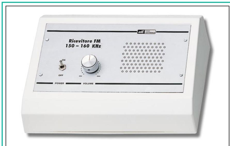
Figure 2 : En reliant le récepteur FM à une prise du secteur 220 volts, nous capterons les signaux sonores envoyés par l'émetteur.
