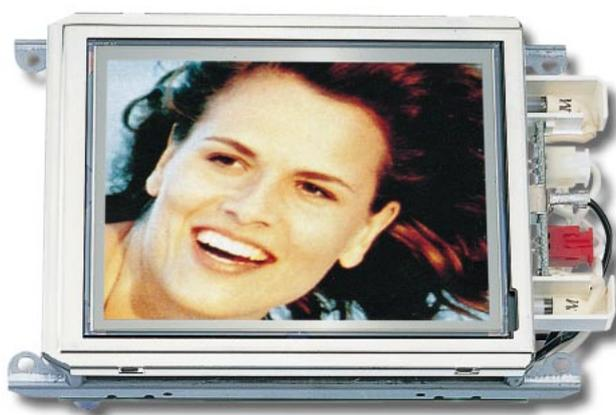
Figure 5 : La dimension utile de l'écran du moniteur LCD est de 80 x 65 millimètres. La définition d'un moniteur LCD ne peut pas être comparée à celle d'un téléviseur couleur. Néanmoins, cette solution est plus que suffisante pour effectuer les réglages d'une parabole dans des conditions optimales.
