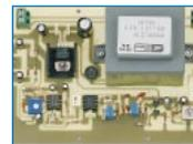
Un émetteur spécial, couplé à une source BF, modulé en fréquence et transmettant dans la bande 150-160 kilohertz, sert à envoyer, sur le secteur 220 volts, une sonorisation que vous pourrez "récupérer" dans n'importe quelle pièce de votre appartement, maison ou entreprise, sur un récepteur FM spécialement conçu pour se syntoniser sur cette gamme de fréquence uniquement.
