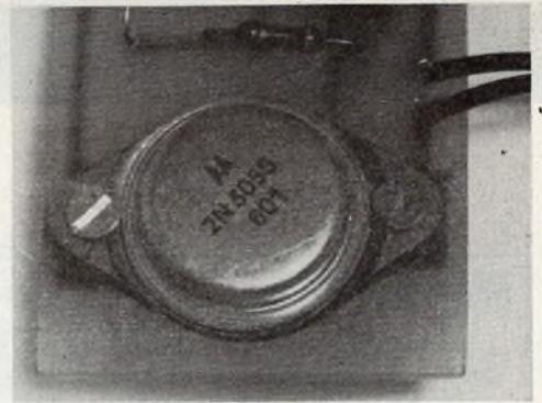
Photo 2. – Il ne sera pas nécessaire de monter le transistor de puissance sur un dissipateur.
