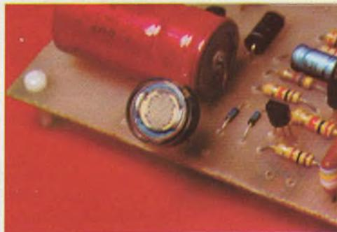
Photo 2. - Un aperçu très coloré du condensateur  $C_1$  de filtrage et de la cellule LDR 05.
